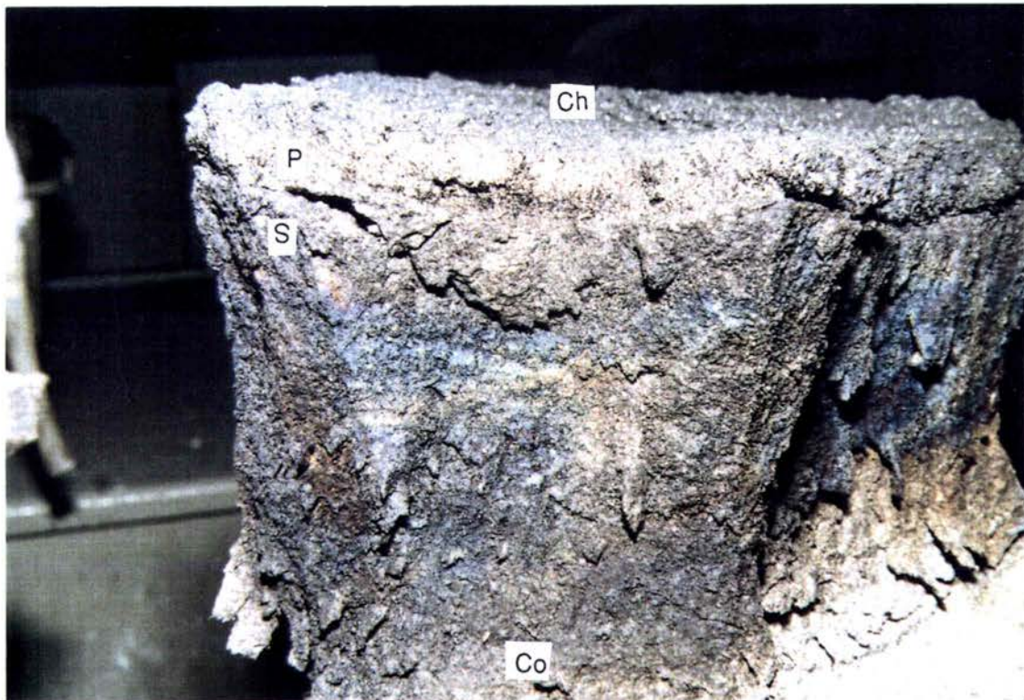
Figure. VI. . Photographie de défournement du culot du four à paroi mobile du CPM
