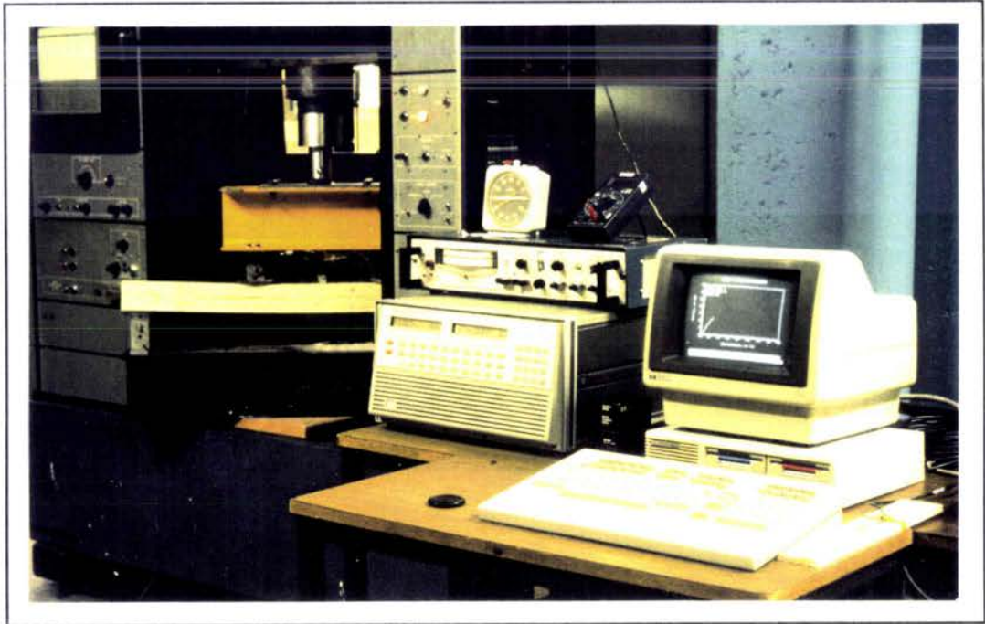
Fig. V.01 - Représentation du montage pour la flexion à 4 points.
