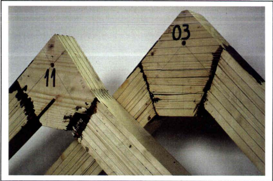
Fig. VII.05 - Différence entre la rupture des éprouvettes FTI fv et celle des éprouvettes FTI.
