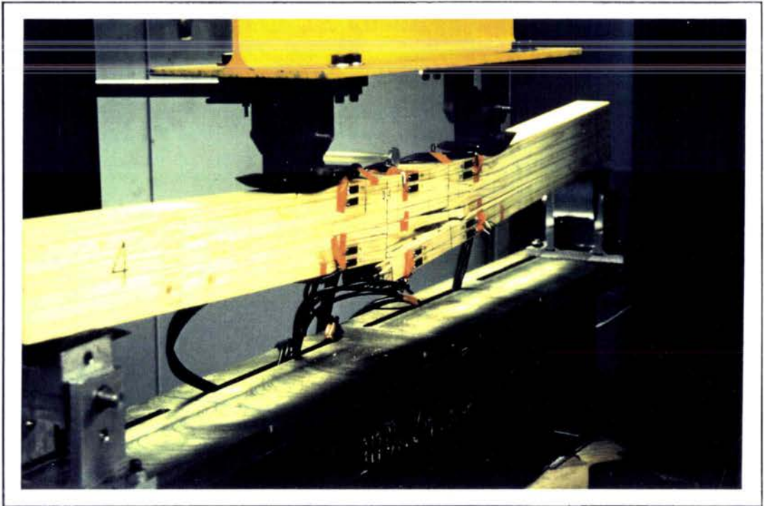
Fig. V.07 - Exemple de la rupture des poutres assemblées.
