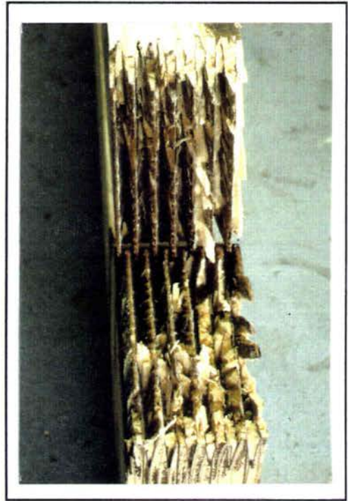
Fig. VII.15 - La rupture au niveau des entures, pour les éprouvettes avec pièce de coin en bois lamellé-collé renforcé.
