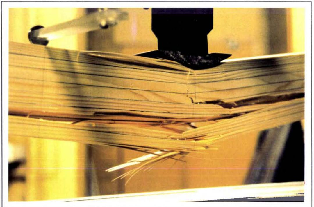
**Fig. V.05** - Rupture d'une des poutres témoins.
