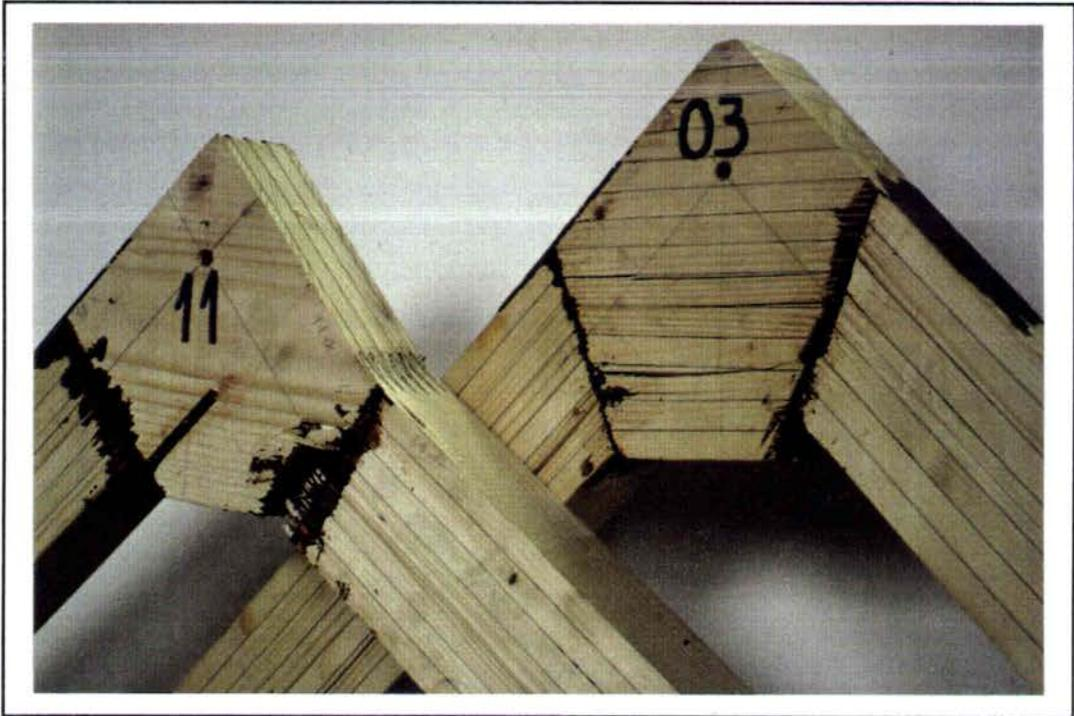
Fig. VII.05 - Différence entre la rupture des éprouvettes FTI<sub>fv</sub> et celle des éprouvettes FTI.
