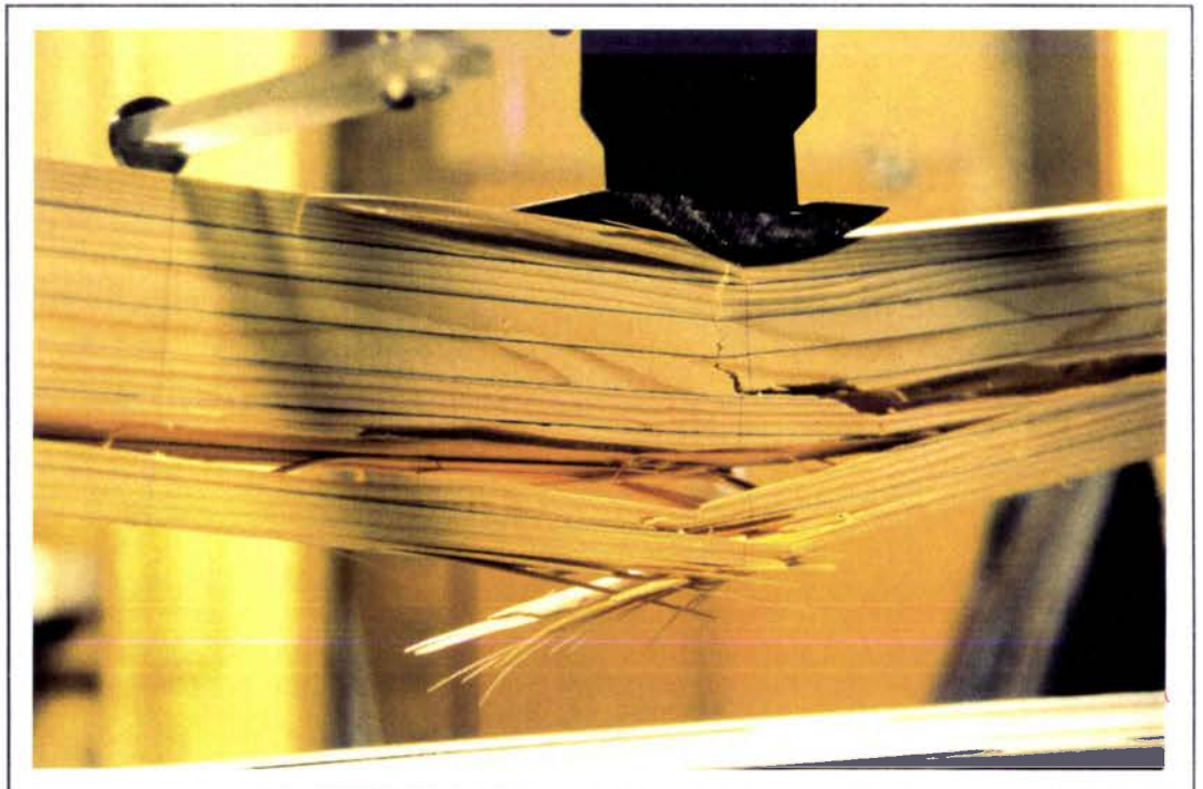
Fig. V.05 - Rupture d'une des poutres témoins.
