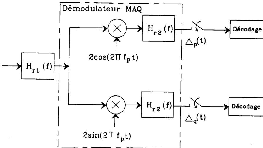
Figure 3.12: Démodulateur OQPRS ou OQPSK
