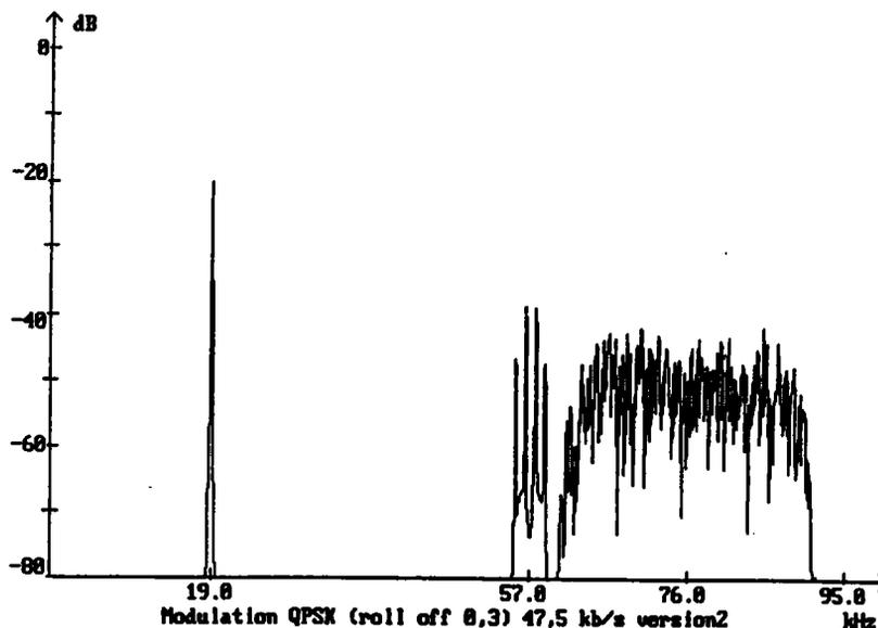
Figure 6.5: Spectre du signal bande de base multiplex FM avec la modulation QPSK de débit de 48 kb/s en présence du signal RDS et du signal pilote.
