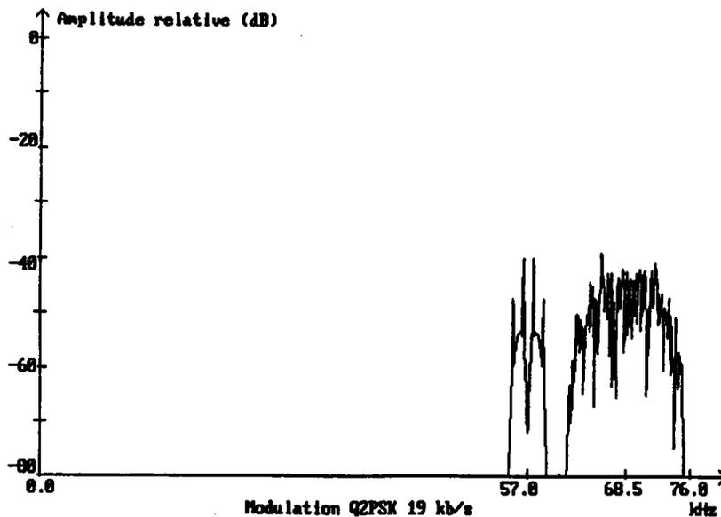
Figure 6.1: Spectre du signal bande de base multiplex FM avec la modulation Q<sup>2</sup>PSK de débit de 19 kb/s en présence du signal RDS.
