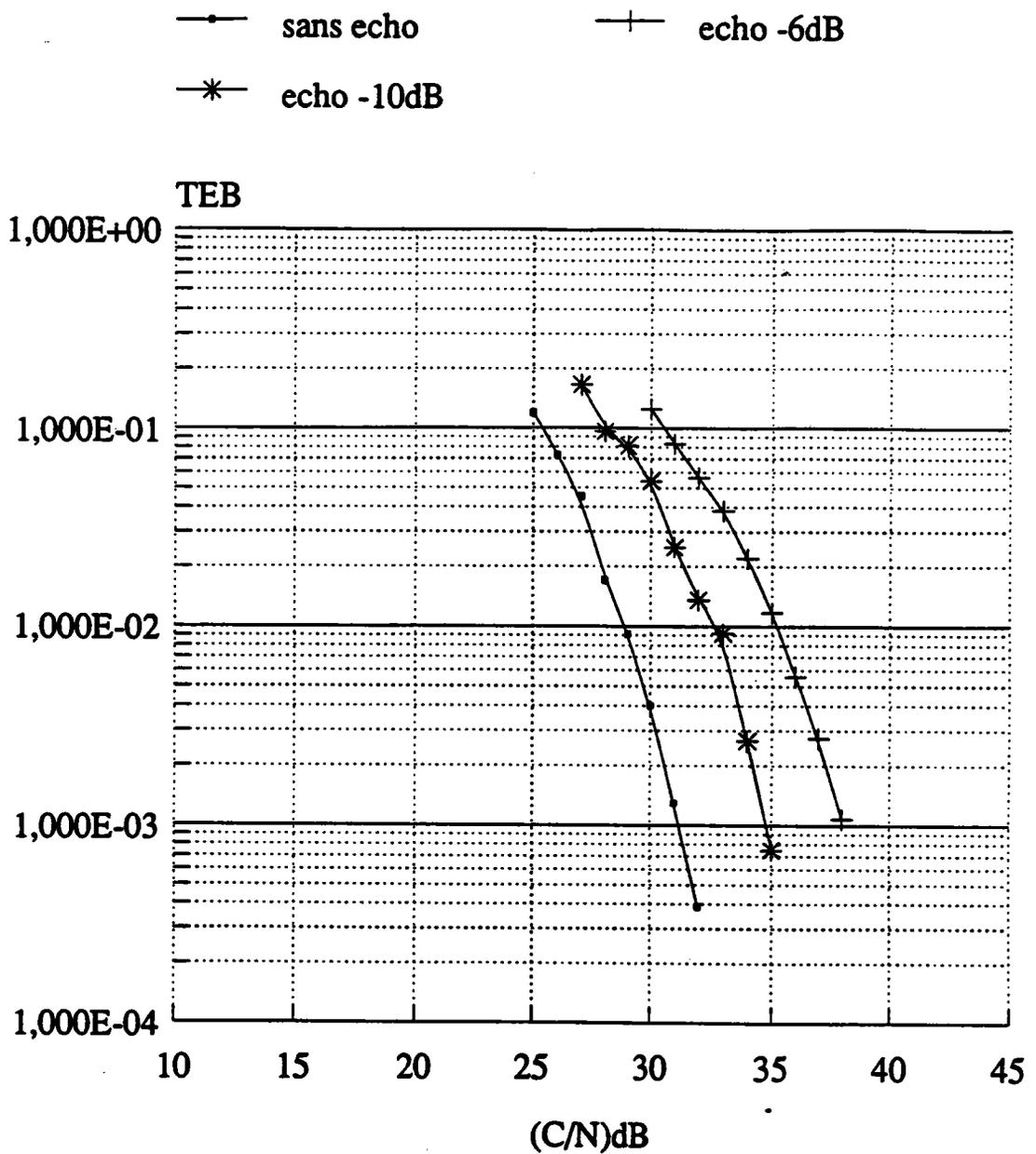
Figure 6.25: Performances de la modulation AM-PSK (version3) de débit 19 kb/s en présence de bruit et d'un écho.
