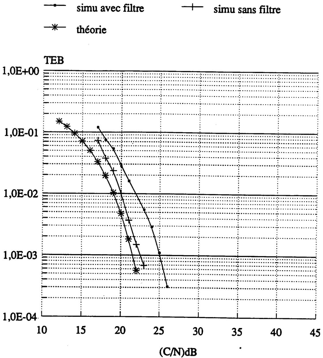
Figure 6.8: Performances de la modulation Q<sup>2</sup>PSK (version 1) de débit 19 kb/s en présence de bruit.
