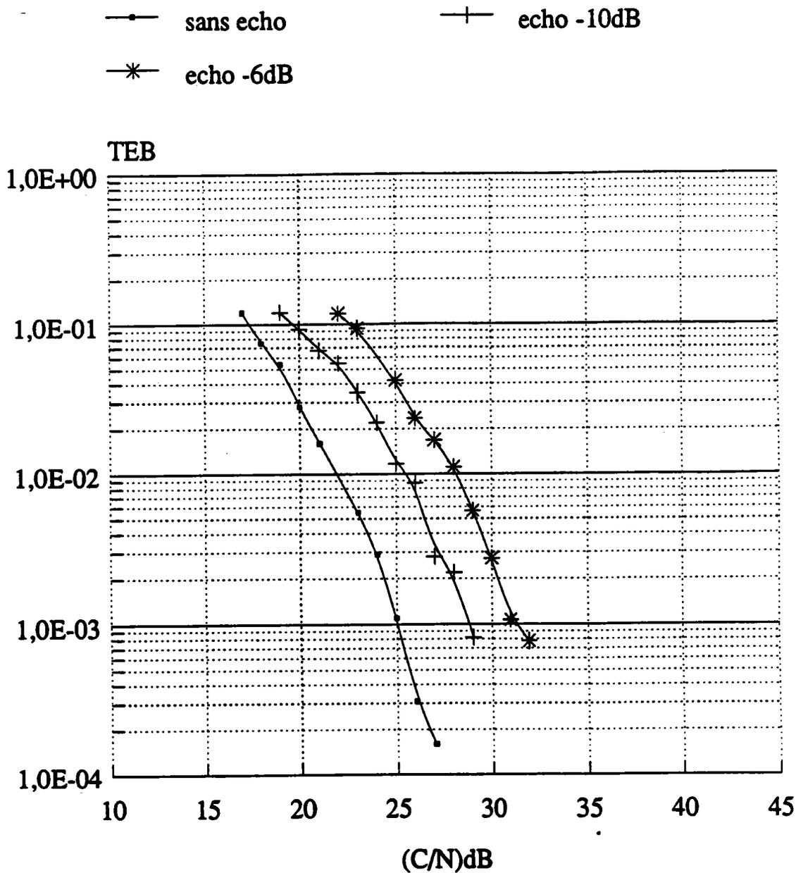
Figure 6.26: Performances de la modulation Q<sup>2</sup>PSK (version1) de débit 19 kb/s en présence de bruit et d'un écho.
