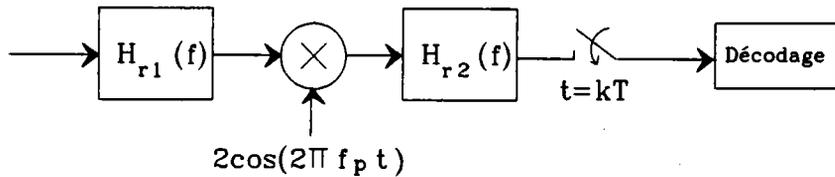
Figure 3.10: Démodulateur AM-PSK
