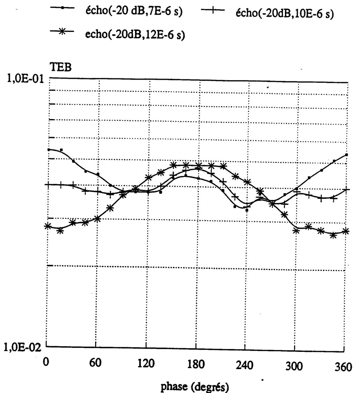
Figure 6.18: Performances de la modulation AM-PSK en présence d'un écho de phase et de retard variable.
