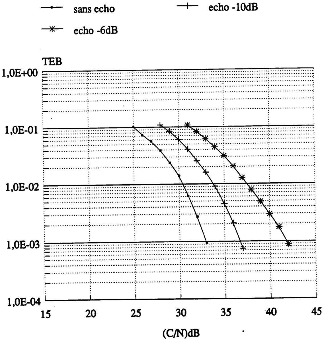
Figure 6.40: Performances de la modulation QPSK (version3) de débit 48 kb/s en présence de bruit et d'un écho.
