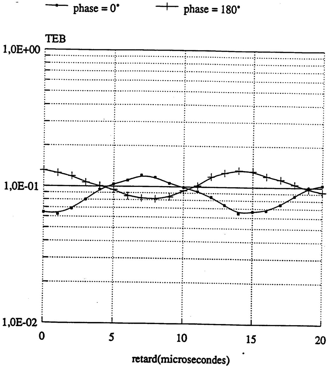
Figure 6.20: Performances de la modulation Q<sup>2</sup>PSK en présence d'un écho en phase ou en opposition de phase et de retard variable.
