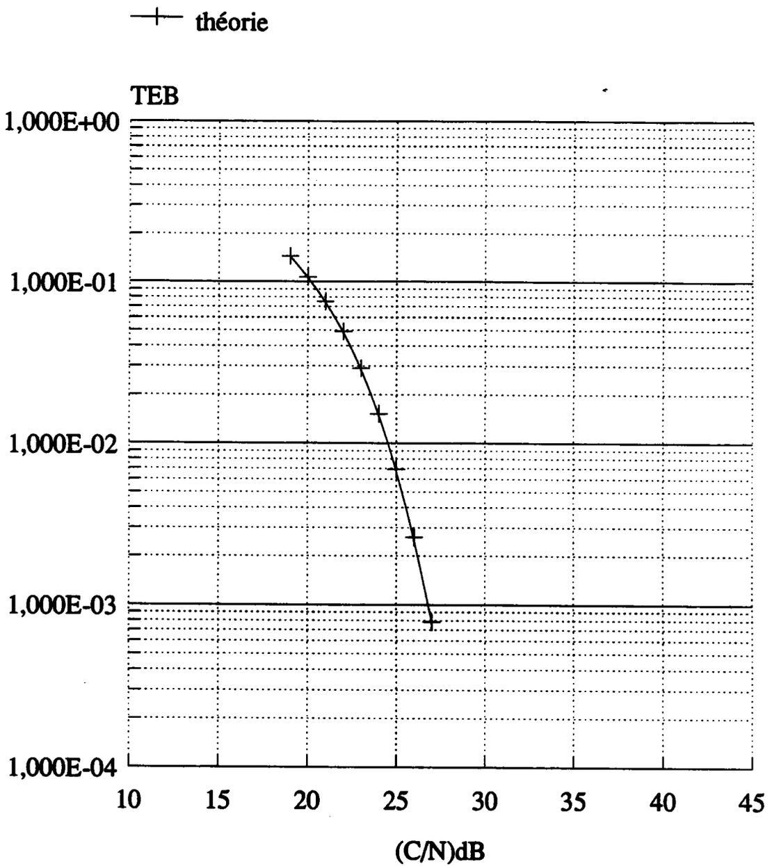
Figure 4.3: Performances du système RECEPTOR en présence de bruit.
