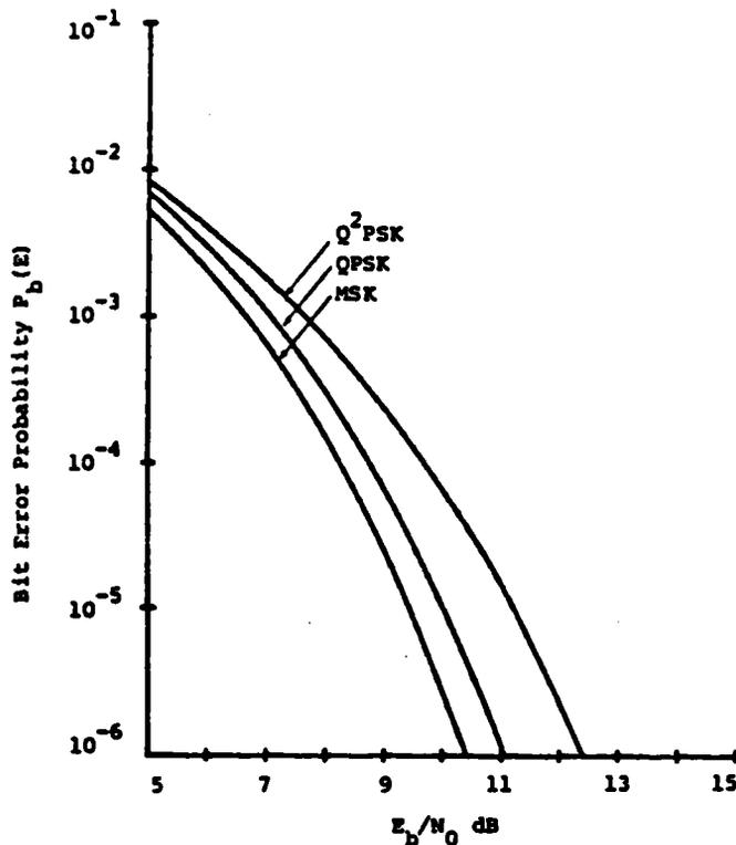
Figure 3.8: Probabilité d'erreur binaire en fonction du rapport  $(E_b/N_0)dB$  pour les modulations *MSK* , *QPSK* et *Q<sup>2</sup>PSK*.
