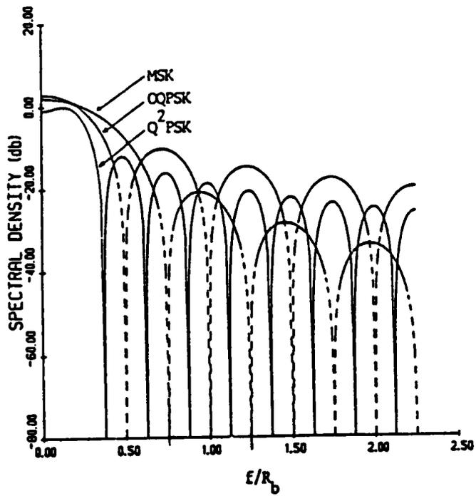
Figure 3.6: Densité spectrale de puissance du signal  $s_{Q^2PSK}(t)$
