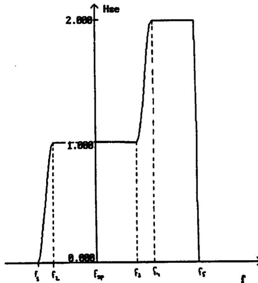
Figure 5.8: Réponse du filtre supplémentaire d'émission  $H_s(f)$  en équivalent bande de base
