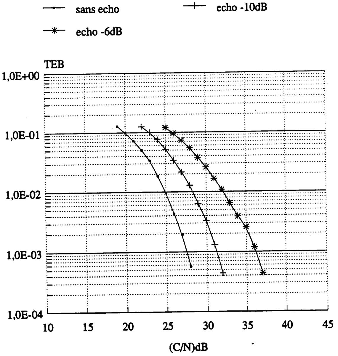
Figure 6.38: Performances de la modulation QPSK (version1) de débit 48 kb/s en présence de bruit et d'un écho.
