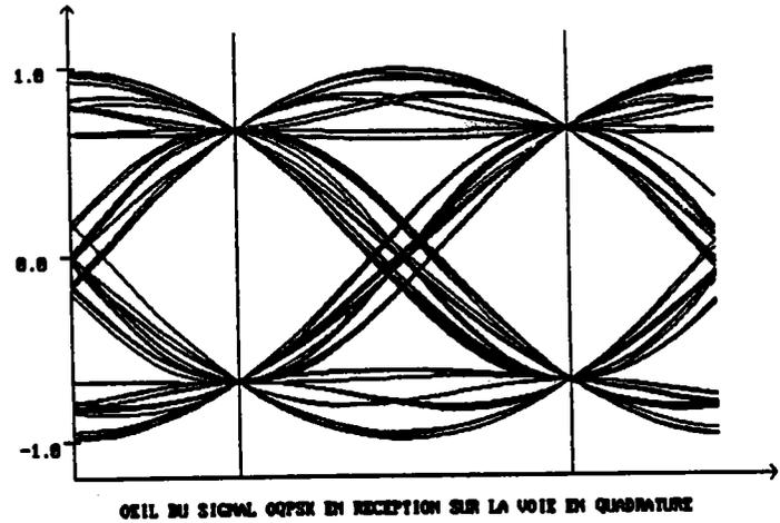
Figure 5.24: Diagramme de l'œil de la modulation OQPSK
