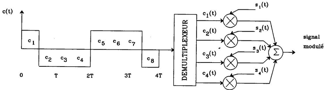
Figure 3.4: Modulateur Q<sup>2</sup>PSK
