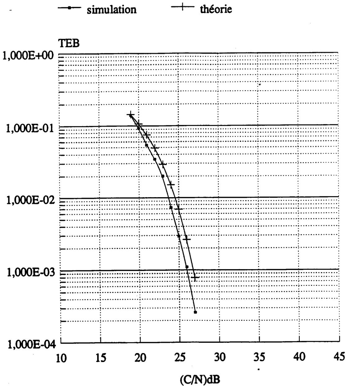
Figure 6.7: Performances de la modulation AM-PSK (version 1) de débit 19 kb/s en présence de bruit.
