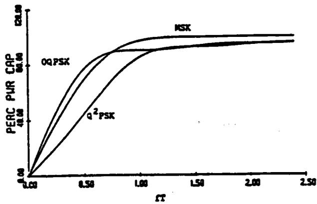
Figure 3.7: Pourcentage de puissance émis en bande limitée
