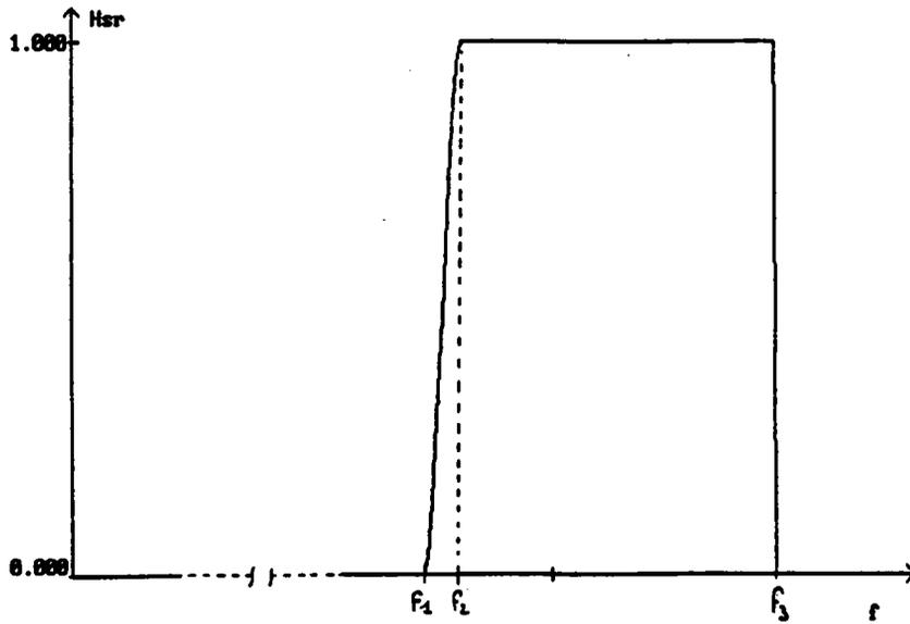
Figure 5.21: Réponse en fréquence du filtre supplémentaire placé en réception
