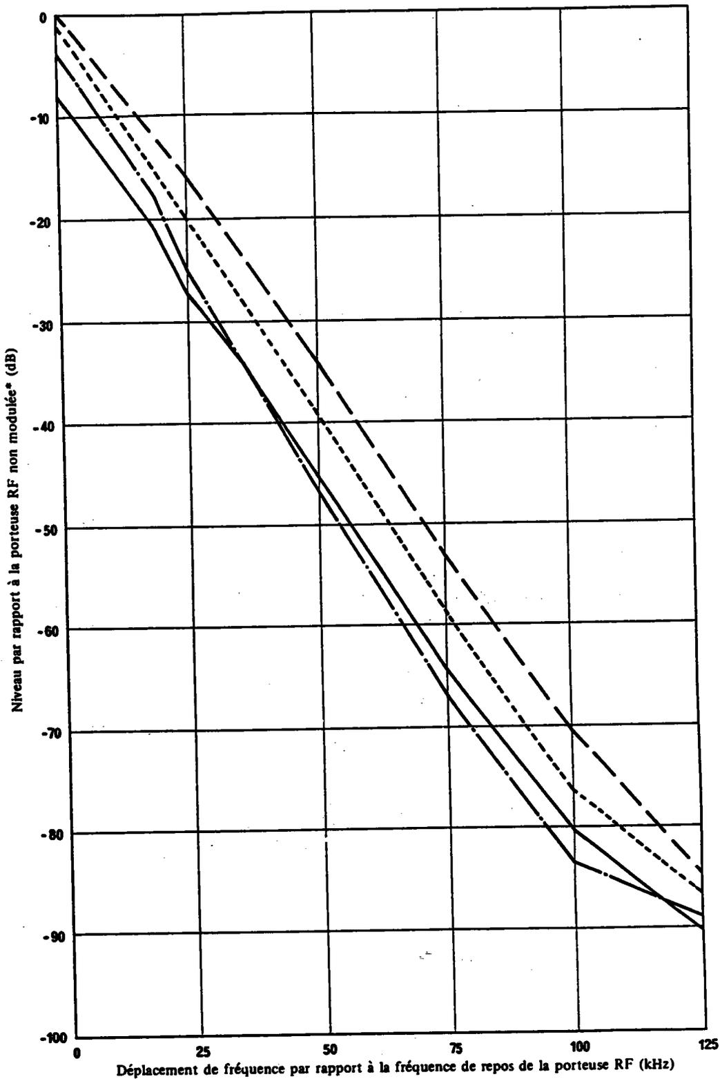
FIGURE 3 - *Spectre MF avec programme (stéréo)*
