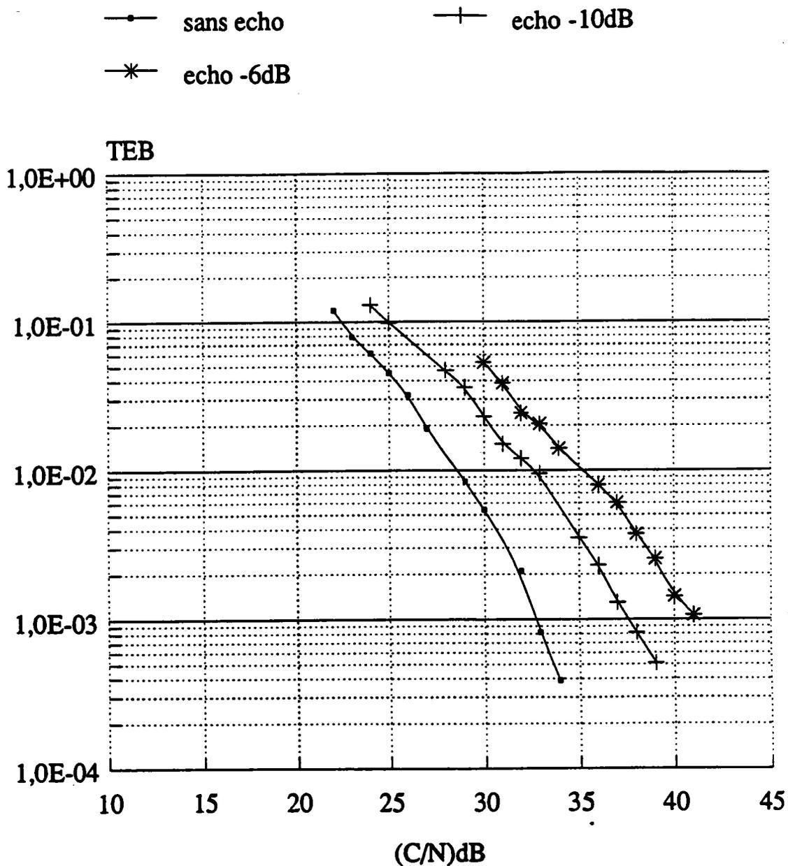
Figure 6.28: Performances de la modulation Q<sup>2</sup>PSK (version3) de débit 19 kb/s en présence de bruit et d'un écho.
