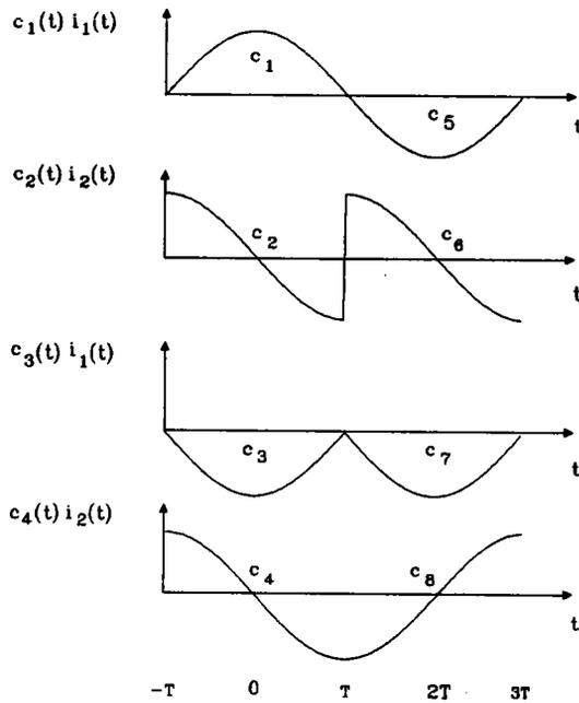
Figure 3.5: Mise en forme des signaux de données  $c_i(t)$  correspondant à la source des données  $c_k$  représentée sur la figure 3.4 en modulation Q<sup>2</sup>PSK
