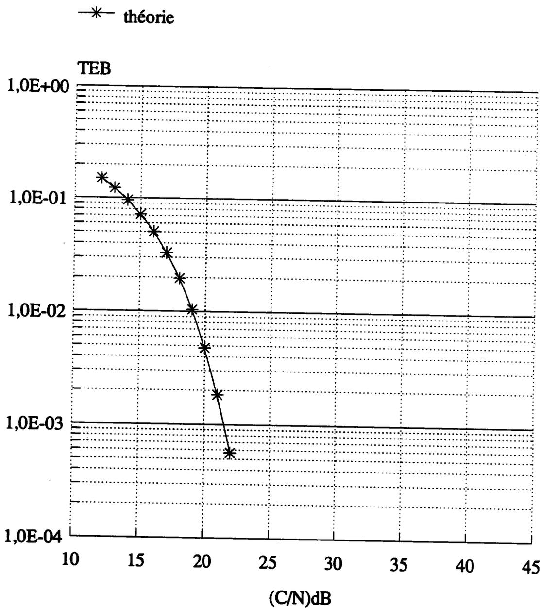
Figure 4.4: Performances de la modulation  $Q^2PSK$  en présence de bruit.
