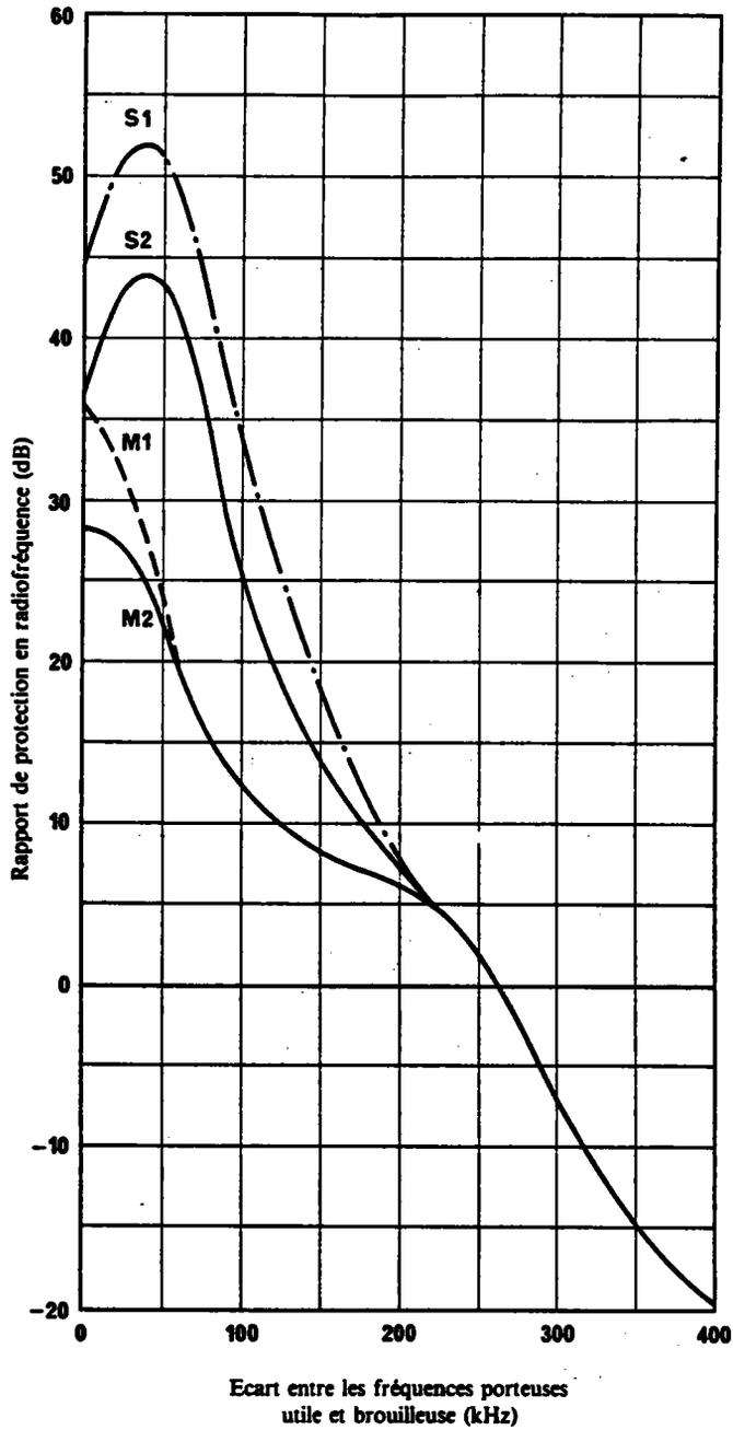
FIGURE 1 - Rapport de protection en radiofréquence pour la radiodiffusion en ondes métriques (bande 8) aux fréquences comprises entre 87,5 et 108 MHz, pour une déviation maximale de fréquence de  $\pm 75$  kHz
