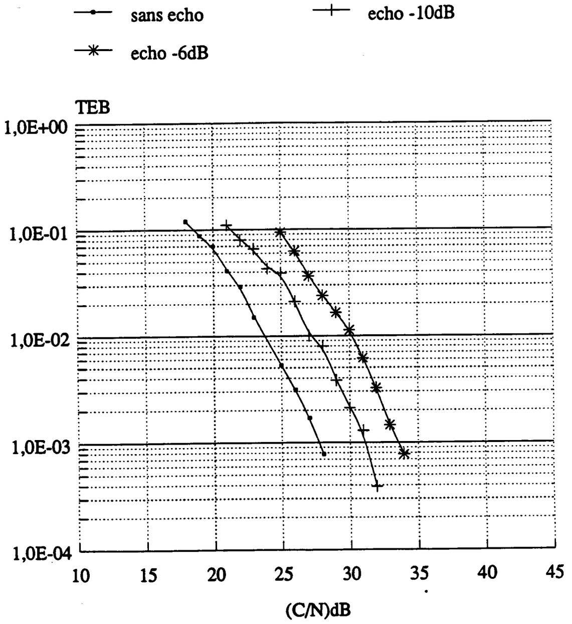
Figure 6.27: Performances de la modulation Q<sup>2</sup>PSK (version2) de débit 19 kb/s en présence de bruit et d'un écho.
