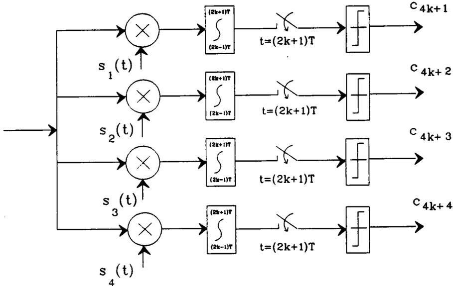
Figure 3.9: Démodulateur Q<sup>2</sup>PSK
