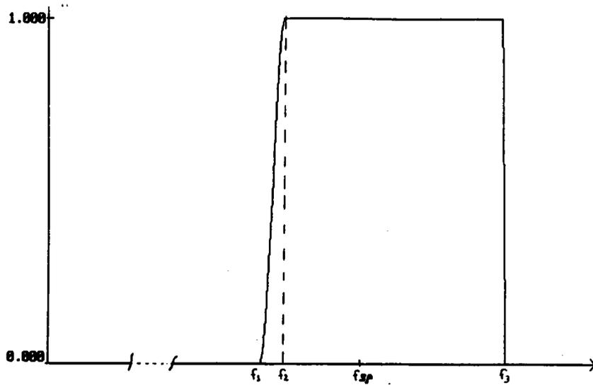
Figure 5.3: Réponse du filtre supplémentaire d'émission  $H_s(f)$  passe-bande
