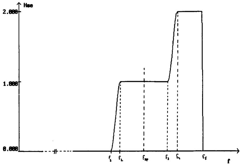
Figure 5.7: Réponse du filtre supplémentaire d'émission  $H_s(f)$  passe-bande
