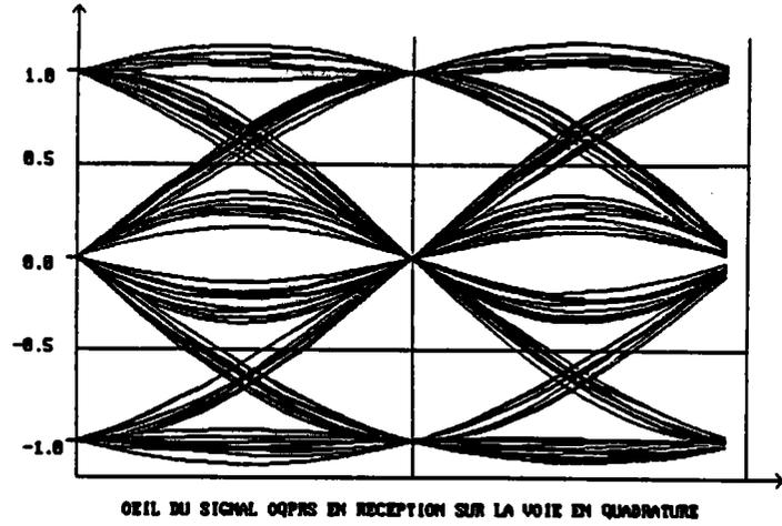
Figure 5.23: Diagramme de l'œil de la modulation OQPSK
