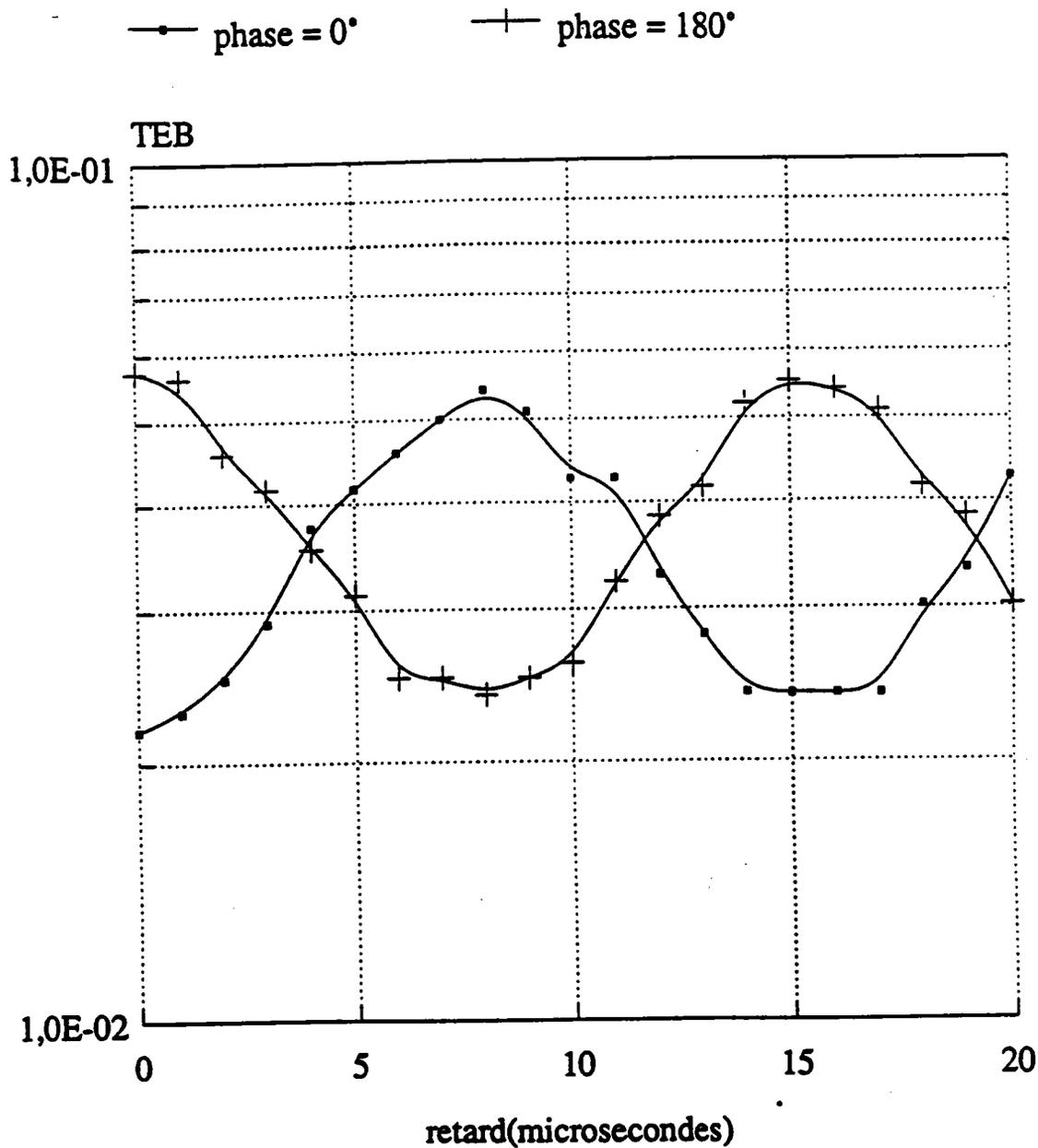
Figure 6.19: Performances de la modulation AM-PSK en présence d'un écho en phase ou en opposition de phase et de retard variable.
