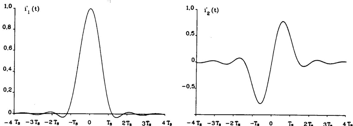
Figure 5.16: Impulsions de mise en forme  $i'_1(t)$  et  $i'_2(t)$
