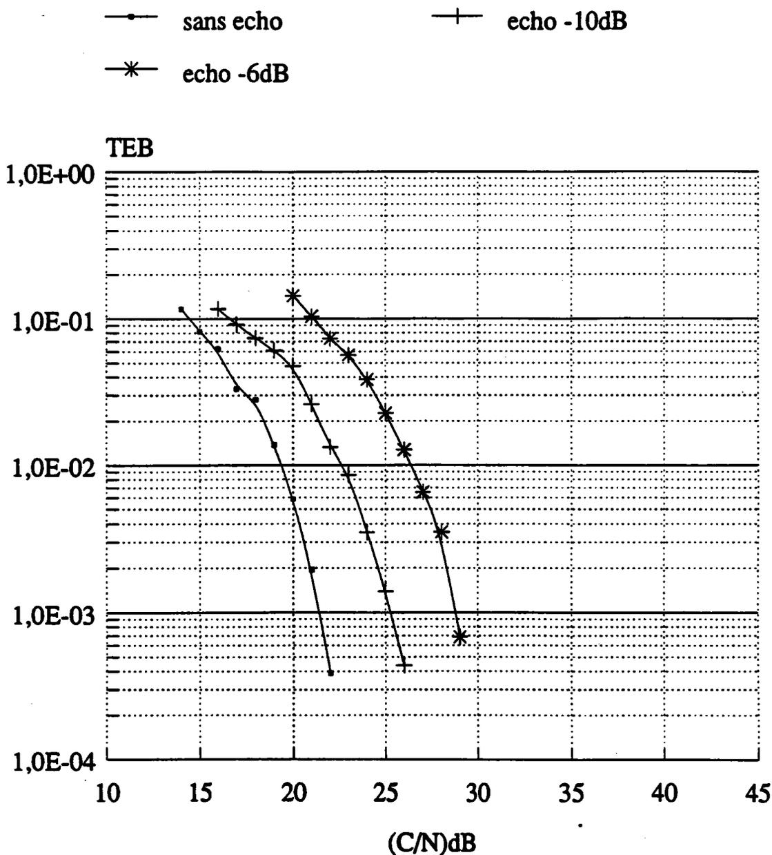
Figure 6.29: Performances de la modulation OQPSK (version1) de débit 19 kb/s en présence de bruit et d'un écho.
