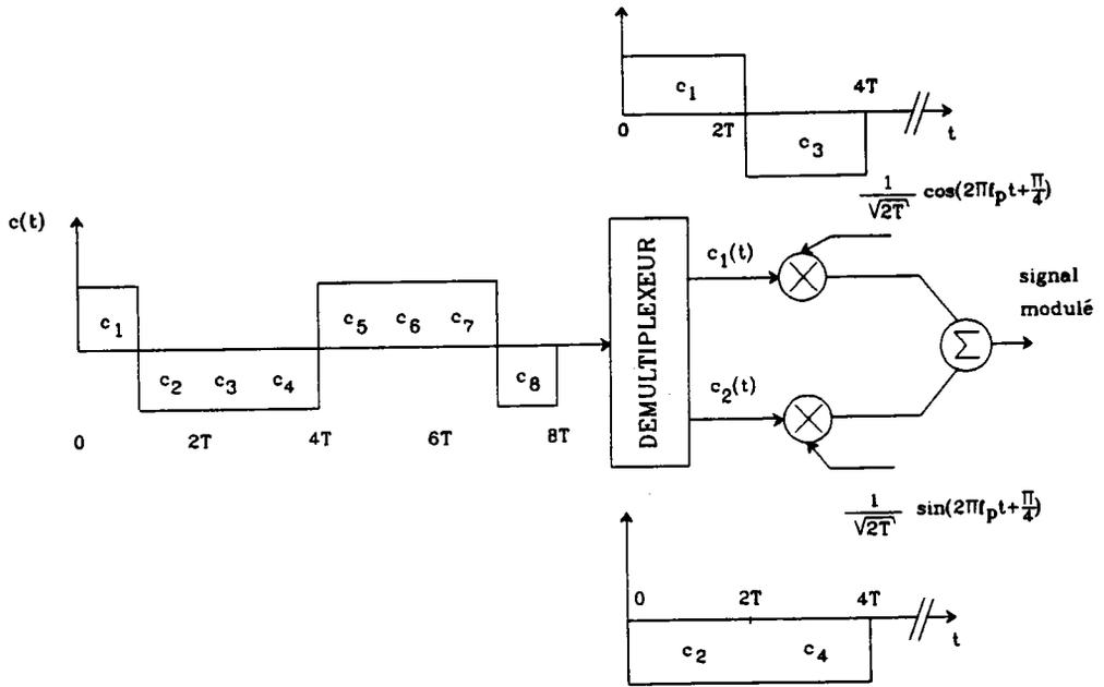
Figure 3.1: Modulateur QPSK
