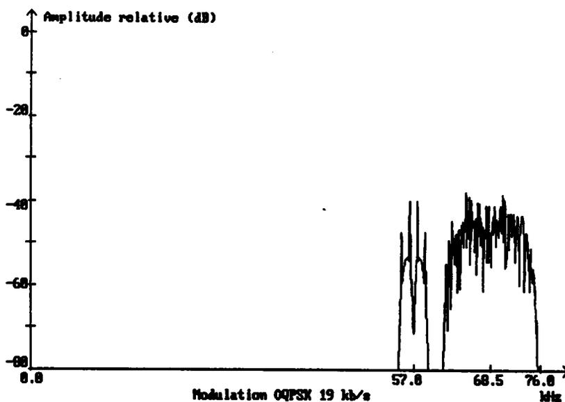
Figure 6.2: Spectre du signal bande de base multiplex FM avec la modulation OQPSK de débit de 19 kb/s en présence du signal RDS.
