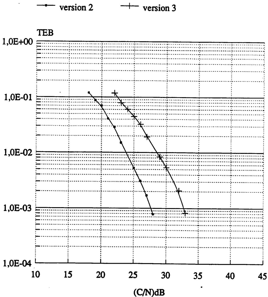
Figure 6.12: Performances de la modulation Q<sup>2</sup>PSK (version 2 et 3) de débit 19 kb/s en présence de bruit et du signal RDS.
