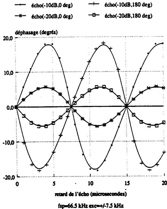
Figure 6.17: Déphasage  $\Delta_\phi$  pour des retards et phases d'un écho donnés.
