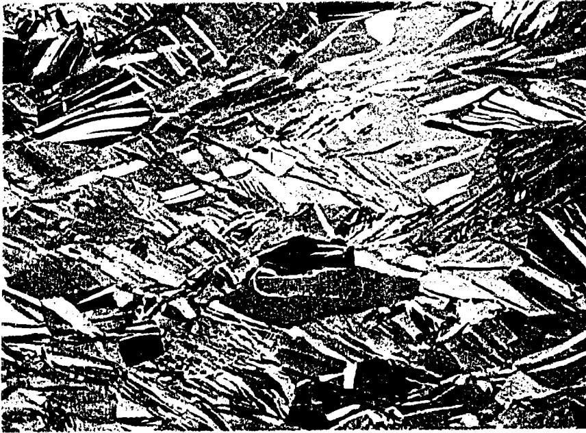
Fig. V-11 : Titane T35 après 50% de déformation (la fraction volumique maclée est de l'ordre de 50%)
