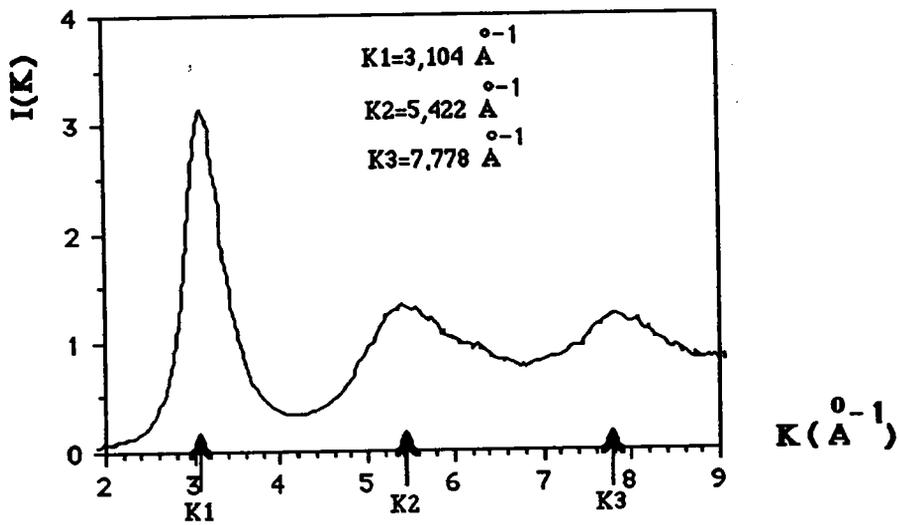
Figure 2F18(d): Fonction d'interférence de l'alliage NiP20,5%AtP
