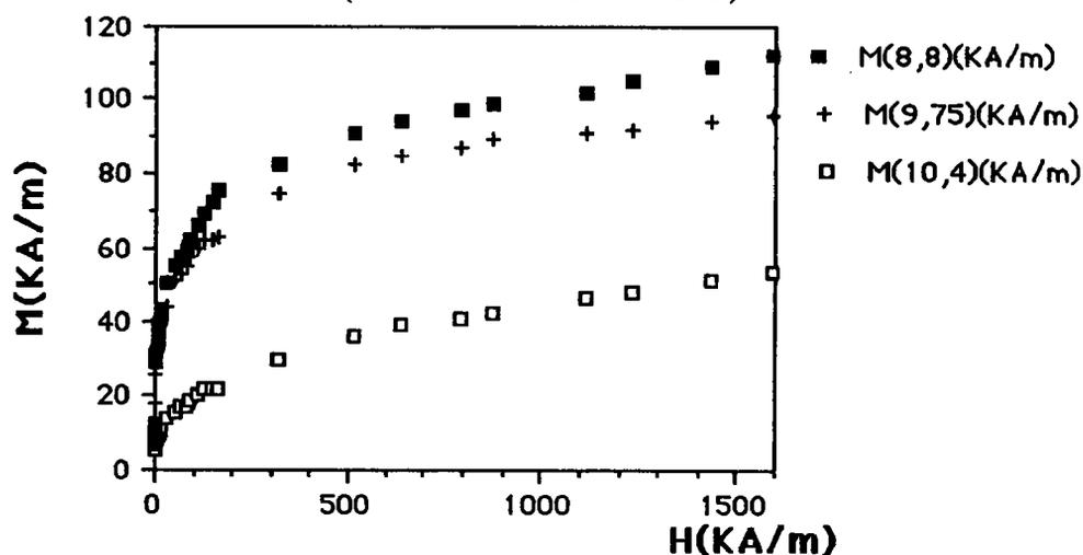
La saturation n'est pas atteinte pour nos échantillons dont la concentration est proche ou supérieure à 10%AtP. La coexistence d'une phase superparamagnétique comme le suggère Dietz[2B33] pour des dépôts similaires avec une phase ferromagnétique se confirmerait par les analyses magnétiques précédentes et par la variation de l'aimantation en fonction du champ appliqué pour nos dépôts (bruts) de concentration supérieure à 14,5%AtP à 300K(figure 2F46):
