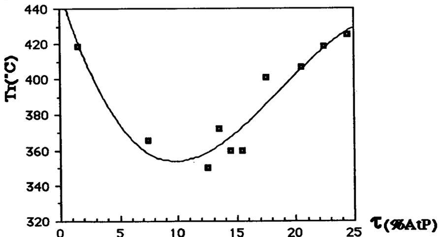
La transition observée sur la variation de résistivité présente un minimum de cette température vers 10%AtP puis augmente de façon continue jusqu'à 25%AtP.
