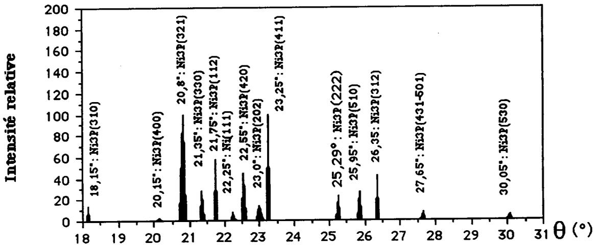
c) Analyse des échantillons recuits à 500°C
