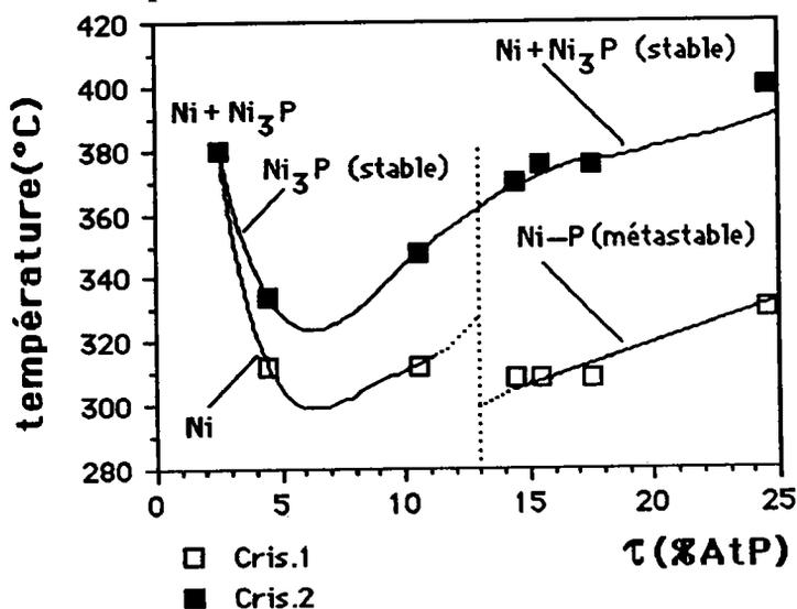
La première étape de cristallisation (précipitation de Ni) se produit à une température caractéristique  $T_{cr}$  qui diminue avec l'augmentation du taux de phosphore dans le dépôt. Cette première étape disparaît vers 14%AtP. Cette diminution de  $T_{cr}$  est associée à la diminution de la relaxation dans ce domaine de concentration.
