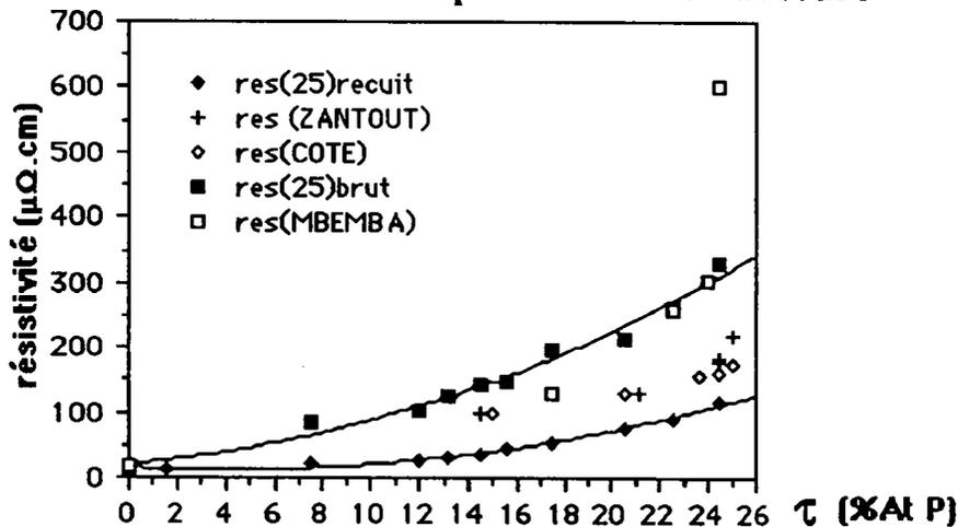
Nous constatons que les résultats obtenus par Cote et Zantout se situent entre nos valeurs obtenues avant et après recuit. Par contre, les résultats présentés par Mbemba (électrolytique avec agitation) sont similaires lorsque la concentration est inférieure à 25%AtP.
