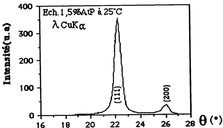
Nous ne pouvons, à partir de l'analyse aux rayons X (anticathode de Cu), donner plus de renseignements concernant l'influence du phosphore sur la structure des alliages car le diagramme X ne présente plus de modification significative au delà de 4,5%AtP exceptée la largeur à mi-hauteur du premier anneau diffus qui s'accroît.
