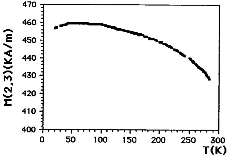
Figure 2F39(b): Aimantation à 800KA/m, Ech.10,4% AtP
