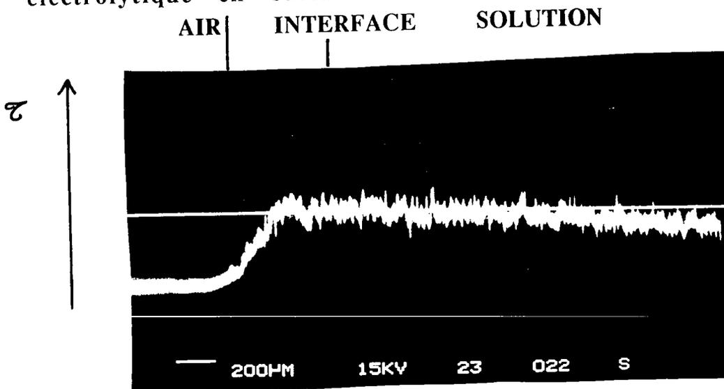
Planche P6: Echantillon 19,7%AtP -> Dépôt non homogène et irrégulier en surface de la solution électrolytique
