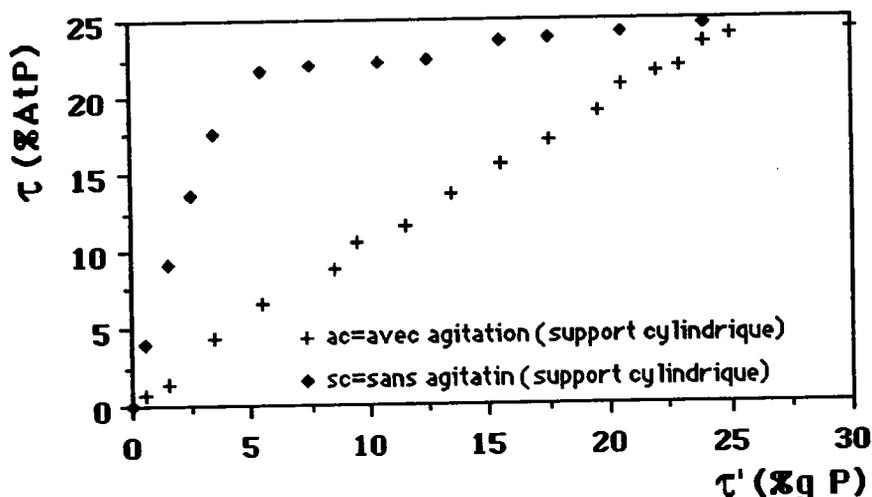
Mais, pour obtenir des alliages dans un large domaine de concentration et assurer la reproductibilité de chaque échantillon, notre méthode d'électrolyse sans convection forcée est plus fiable et plus précise.
