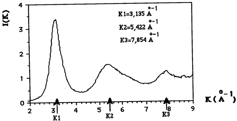
Figure 2F18(e): Fonction d'interférence de l'alliage NiP24,5%AtP
