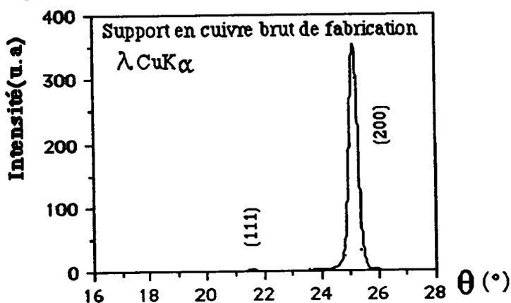
**Figure 2F 14 : Intensité diffusée par l'ech. 0,5%AtP**
