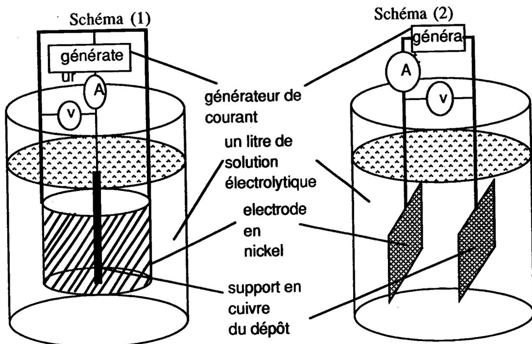
Les dépôts électrolytiques sur support plan sont réalisés (schéma 2) de la même façon en remplaçant l'anode cylindrique par une anode plane de dimension égale à celle du dépôt. La distance entre électrodes est toujours de 5cm.
