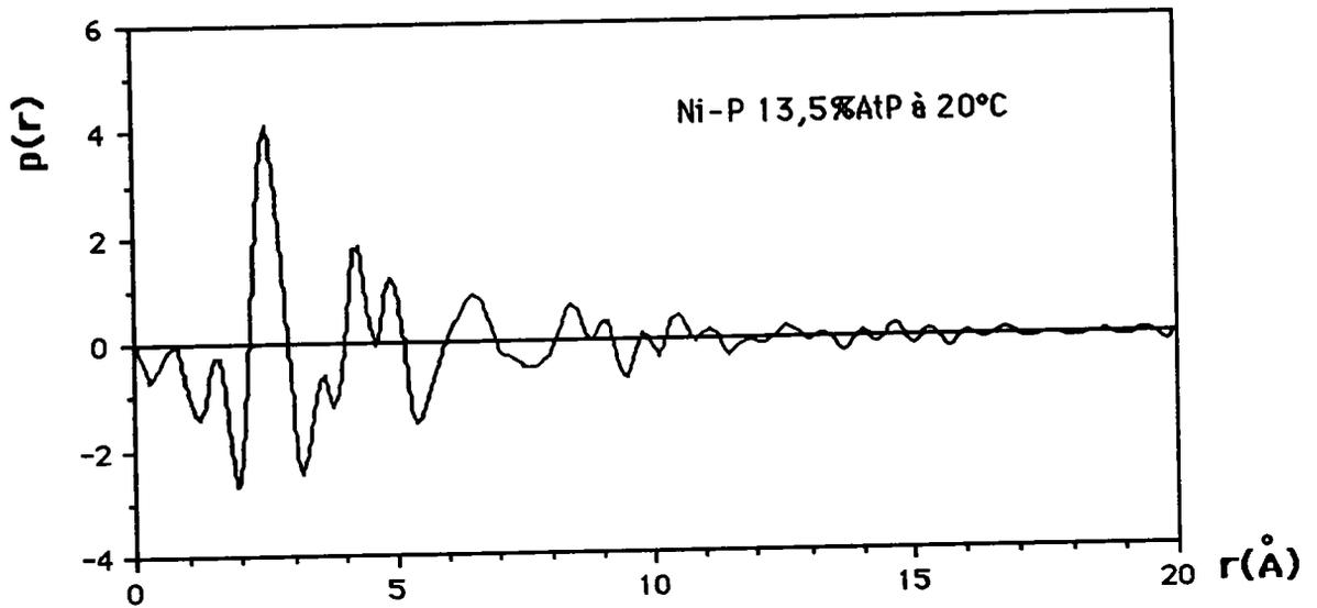
Figure 2F20(b): Fonction de répartition réduite de l'alliage
