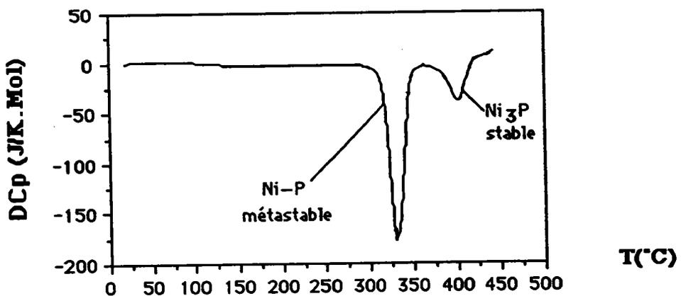
L'analyse thermomagnétique a permis d'observer une étape de cristallisation qui ne peut être associée qu'à la réorganisation du Nickel (cfc) (Voir page 107 et 108 deuxième partie, ch.III, 3.a.γ)
