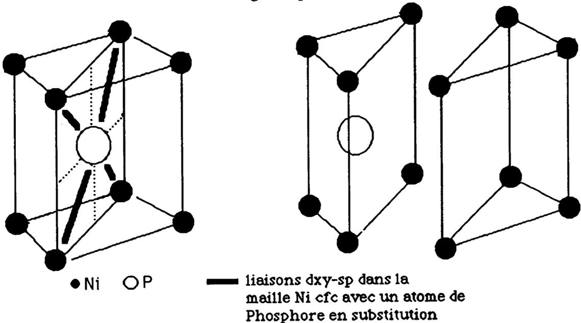
A cette concentration, l'alliage Ni-P est amorphe d'après l'analyse structurale. Les atomes de phosphore se placent au centre des prismes (Schéma 3) correspondant, d'après les études faites par Machizaud, à l'élément caractéristique de l'ordre local. Cette transformation structurale n'est pas incompatible avec les variations de l'aimantation en fonction de  $\tau$  car celle-ci ne suit plus une variation linéaire au delà de cette concentration.
