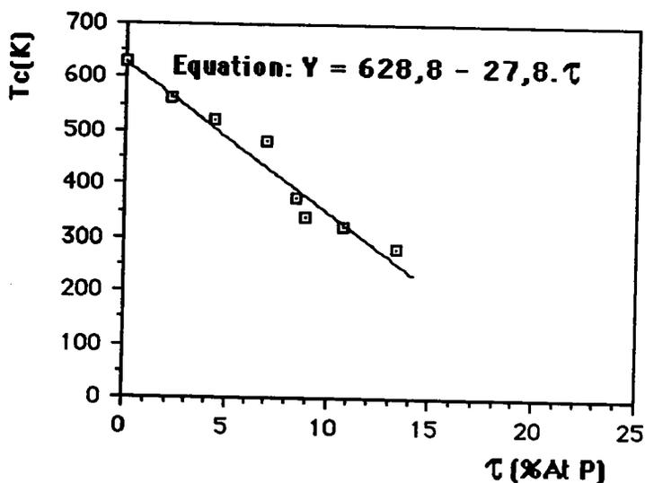
Les points représentés sur la figure sont les données mesurées par la méthode précédente. Aucune transition ferromagnétique n'a été détecté au-delà de 14,5%AtP. Les figures 2F36(a)et(b) illustrant les variations de l'aimantation de l'échantillon 15,8%AtP ne présente aucune transition d'ordre ferromagnétique.
