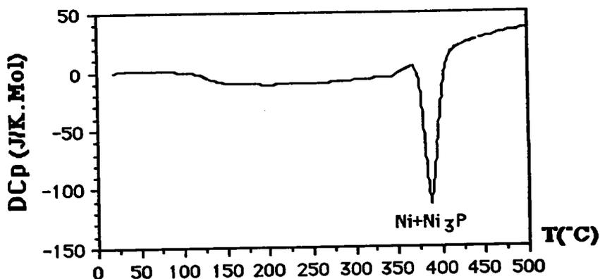
Figure 2F7(b): Variation de la chaleur spécifique apparente de l'échantillon 4,5% AtP
