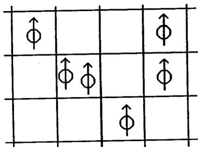
Schéma proposé par Friedel pour définir le ferromagnétisme à saturation du Nickel. Les cercles surmontés de flèches sont les porteurs avec leurs spins et les carrés schématisent les polyèdres atomiques.
