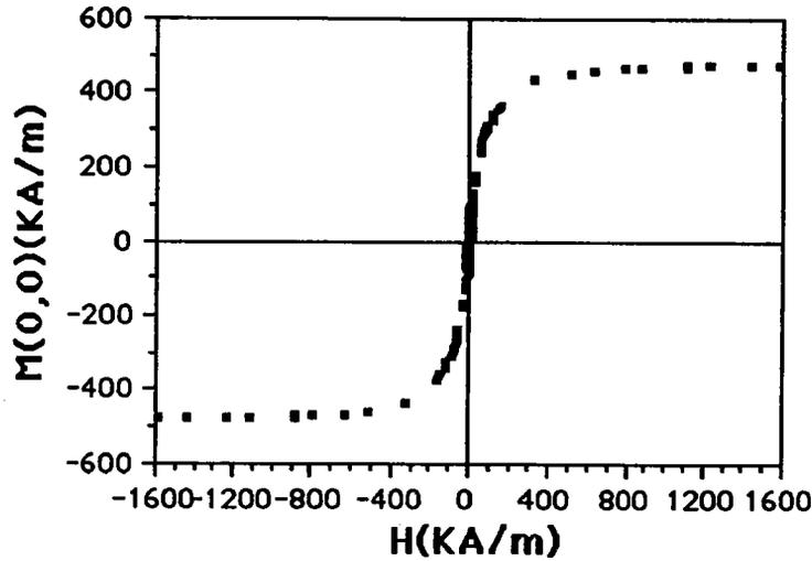
L'analyse détaillée du cycle (figure 2F41) permet d'évaluer le champ coercitif ainsi que l'aimantation rémanente soit:
