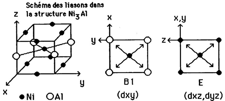
Nous constatons d'après le schéma précédent que la liaison Ni-M s'effectue à partir de l'orbitale  $d_{xy}$  du niveau B1 alors que les liaisons Ni-Ni sont caractérisées par les orbitales  $d_{xz}$  et  $d_{yz}$  du niveau E.
