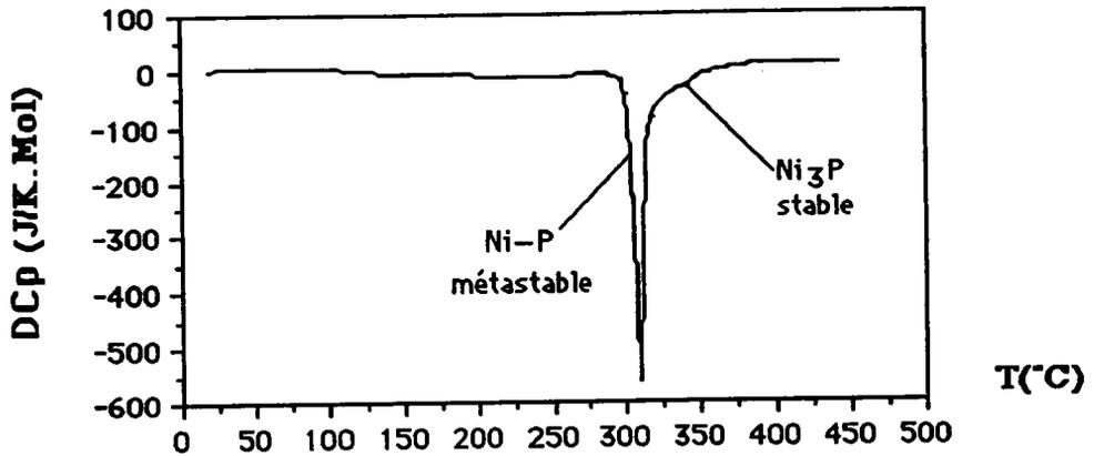
Figure 2F9(b): Variation de la chaleur spécifique apparente de l'échantillon 15,5% AtP
