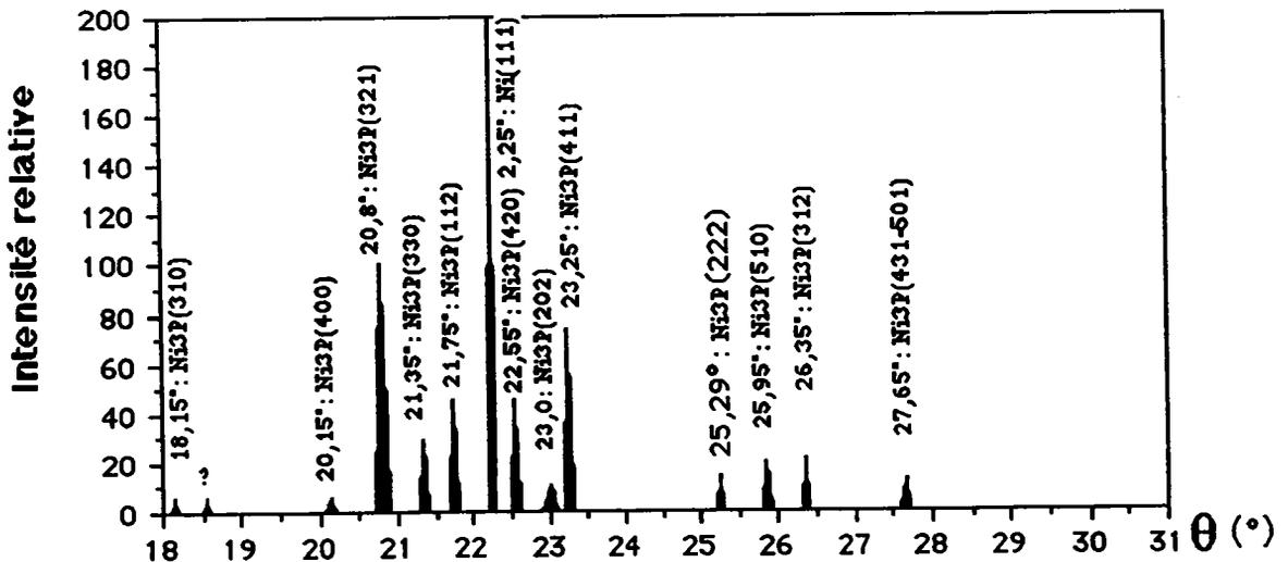
Le recuit à 500°C correspond à la stabilité finale des dépôts. Les intensités diffusées ne présentent que de très faibles modifications par rapport au recuit à 350°C (figure 2F24(c)). Ceci est du précédent traitement thermique à 350°C entraînant l'apparition de la première étape de cristallisation et l'amorce de la deuxième étape de cristallisation de l'échantillon.
