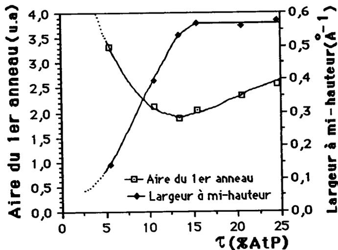
La largeur à mi-hauteur du premier anneau (figure 2F19) caractérisant la taille des agrégats ou cristallites confirme l'existence de l'ordre structural particulier qui s'établit à partir de 14%AtP par son augmentation dès les faibles concentrations et par sa stabilisation à cette concentration.
