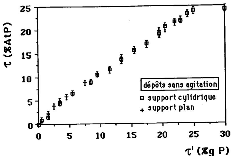
La surface utile des supports plans est de  $4\text{cm}^2$  alors que celle des supports cylindriques n'est que de  $0,84\text{cm}^2$ . L'intensité du courant a donc été calculée pour ces deux surfaces afin d'avoir la même densité de courant soit  $18\text{mA}/\text{cm}^2$ .
