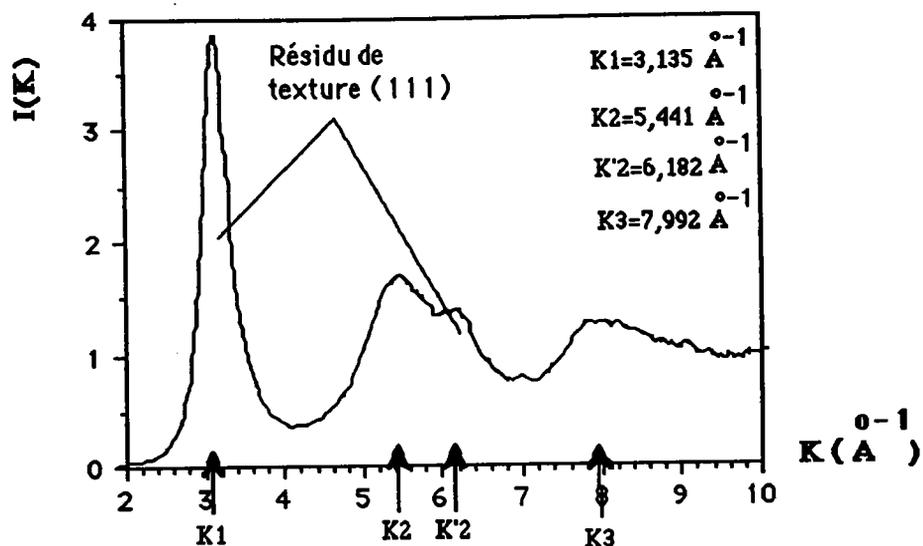
Figure 2F18(b): Fonction d'interférence de l'alliage NiP 13,5%AtP
