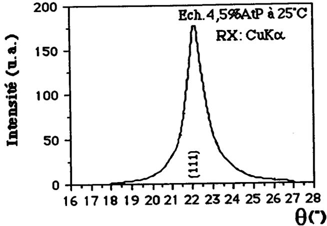
Pour le domaine supérieur à 5%AtP, le premier anneau est le seul détecté sur le diagramme d'intensité diffusée (analyse avec l'anticathode de cuivre). Sa très faible amplitude ne varie avec l'augmentation de la concentration du dépôt.
