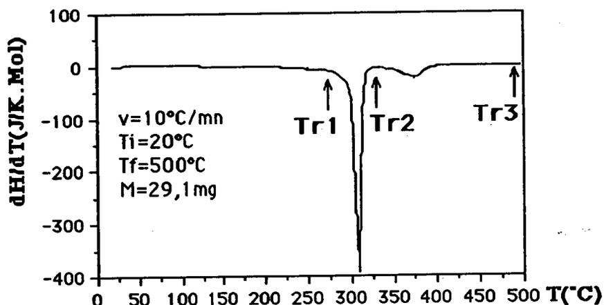
\* **Tr1**: Premier recuit à  $280^{\circ}C$  afin d'éliminer l'excès de volume libre dans la structure brute de fabrication. Aucune étape de cristallisation n'a été détectée avant cette température
