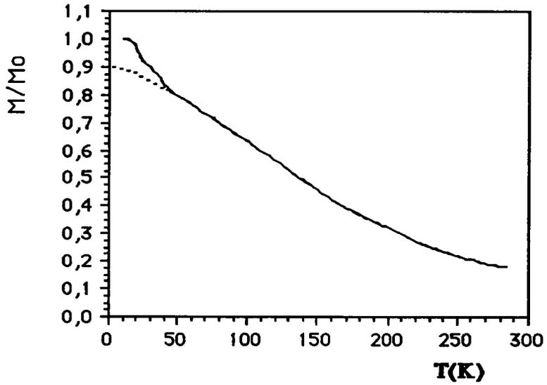
Figure 2F36(b): Variation du carré de l'aimantation réduite, Ech.15,8% AtP
