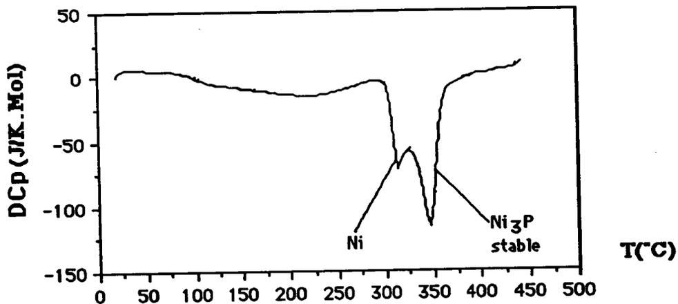
aucune transition structurale n'est détectée. La structure cfc du Nickel est toutefois perturbée par la présence du Phosphore car une faible variation exothermique et étendue est observée sur l'échantillon brut caractérisant une faible relaxation.
