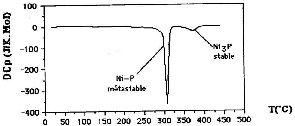
Figure 2F9(c): Variation de la chaleur spécifique apparente de l'échantillon 24,5% AtP
