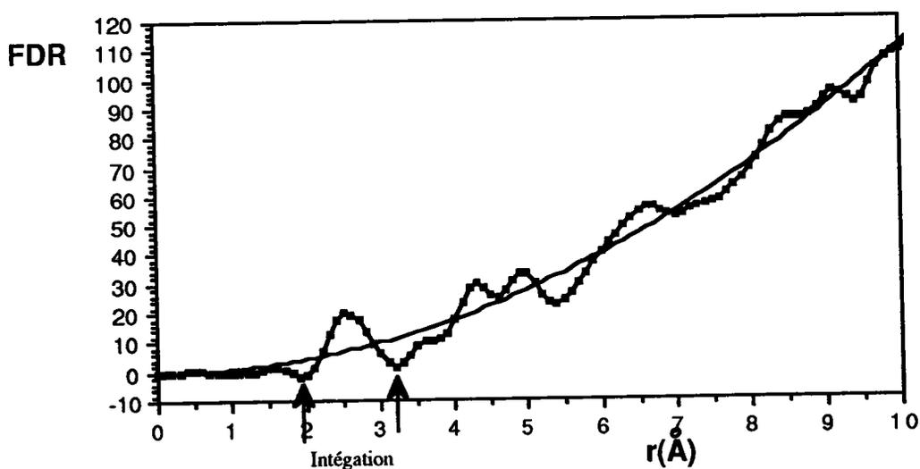
Nous pouvons donc après comparaison avec les résultats obtenus pour d'autres alliages considérer nos échantillons comme étant amorphes lorsque le taux de phosphore est supérieur à 14%AtP environ.
