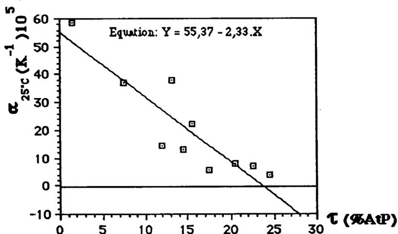
Le coefficient de température, toujours positif, tend vers zéro lorsque la concentration tend vers 25%AtP. La droite théorique passe par l'axe des abscisses pour un taux de Phosphore d'environ 24%AtP. Les fluctuations de  $\alpha$  autour de la droite théorique sont dues à la difficulté de mesure de ce coefficient.
