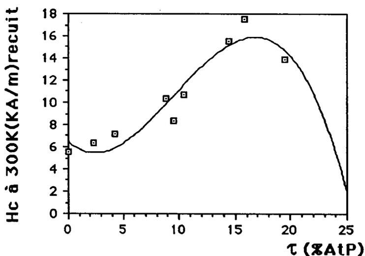
Celui-ci paraît chuter brusquement lorsque l'on tend vers 25%AtP; la structure devenant amagnétique.
