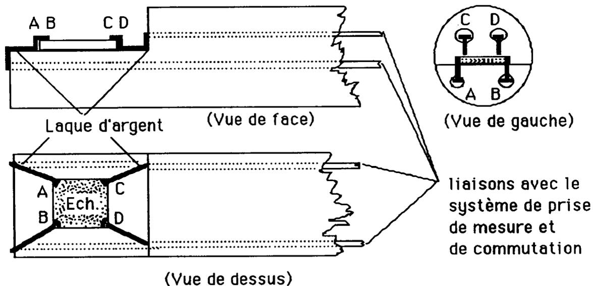
L'ensemble est placé dans un four dont la température peut être réglée par un système automatisé. Un système de commutation permet de
