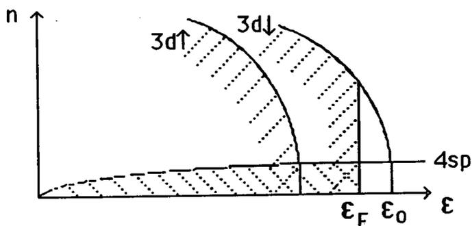
Le schéma précédent ne tient pas compte de l'interaction spin-orbite qui déforme, d'après Fletcher [3B10], la bande 3d du Nickel comme l'indique le schéma suivant. Le couplage spin-orbite peut donc permettre d'expliquer les valeurs de  $g$  légèrement supérieures à 2.
