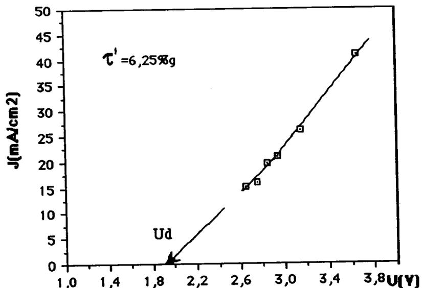
La tension appliquée est une fonction linéaire de la densité de courant à distance inter-électrode constante. Ces résultats coïncident avec ceux de MBEMBA et KARBAL [1B8] [1B9] pour lesquels la tension  $U_d$  limite de décomposition des espèces est de 2volts environ.
