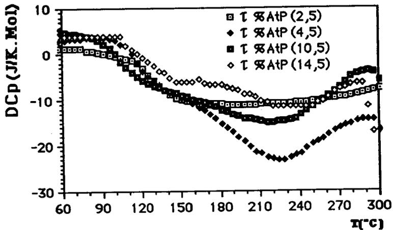
La relaxation, caractérisant l'excès de volume libre dans la structure, est exothermique et fait tendre la structure vers un équilibre plus stable.
