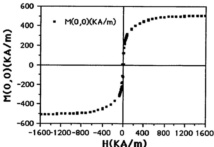
L'aimantation à saturation est de 509,44KA/m soit  $0,5965\mu_B$ . L'aimantation à saturation théorique du nickel est de 509,436KA/m [2B26] correspondant à  $0,6017\mu_B$ . L'écart entre la valeur théorique et le résultat expérimental est dû à la précision relative de la mesure de la masse de l'échantillon.
