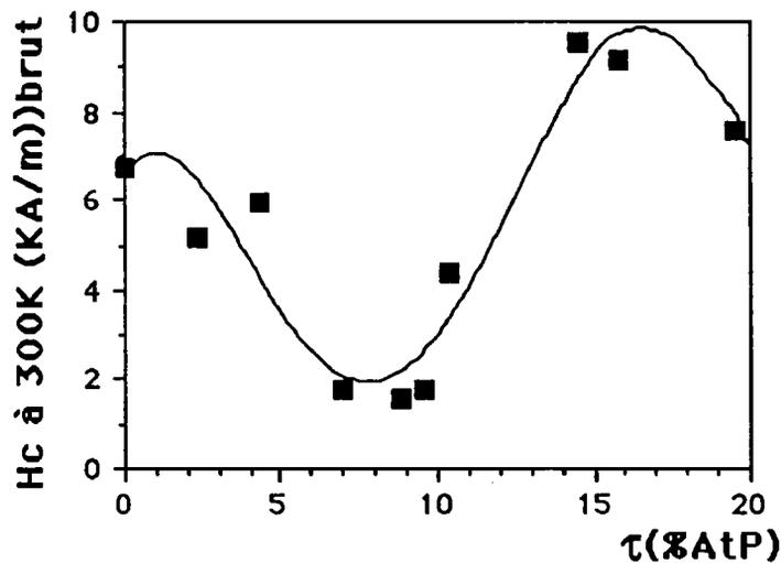
Le phénomène s'inverse au-delà de 10%AtP environ. Le champ coercitif augmente brusquement; l'apparition de domaines de Weiss de nature différentes due à la coexistence d'une phase paramagnétique avec des amas Ni ferromagnétiques localisés paraît en être la cause.
