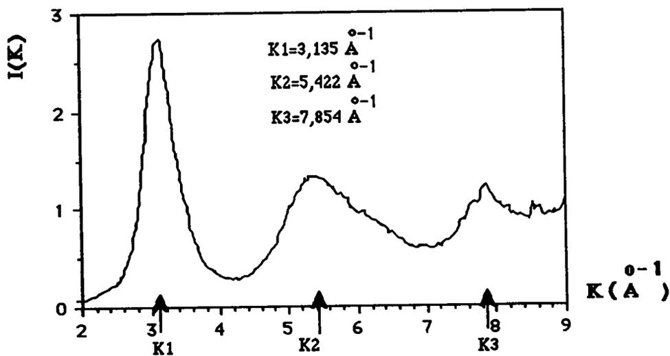
Figure 2F17: Fonction d'interférence de l'alliage NiP 5,5%AtP
