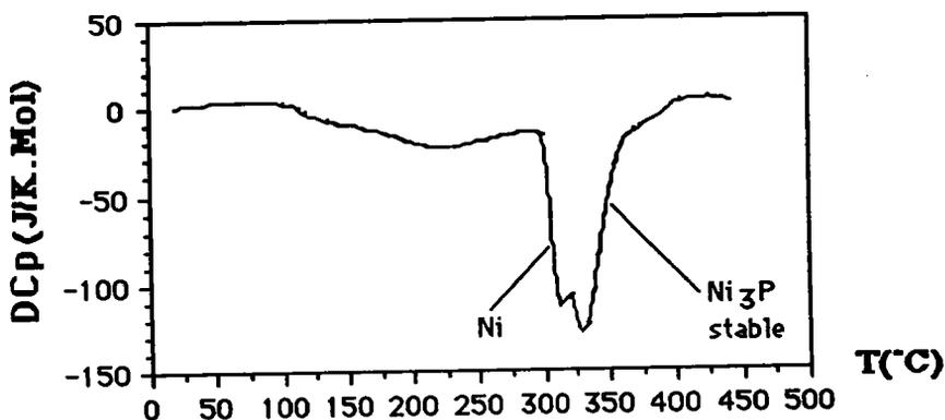
Figure 2F7(c): Variation de la chaleur spécifique apparente de l'échantillon 10,5% AtP
