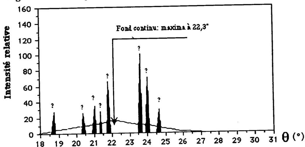
Les positions angulaires (en degré) et les amplitudes relatives des pics de diffraction relevés sur le diagramme X (Figure 2F23) sont consignées dans le tableau 2T7 suivant:
