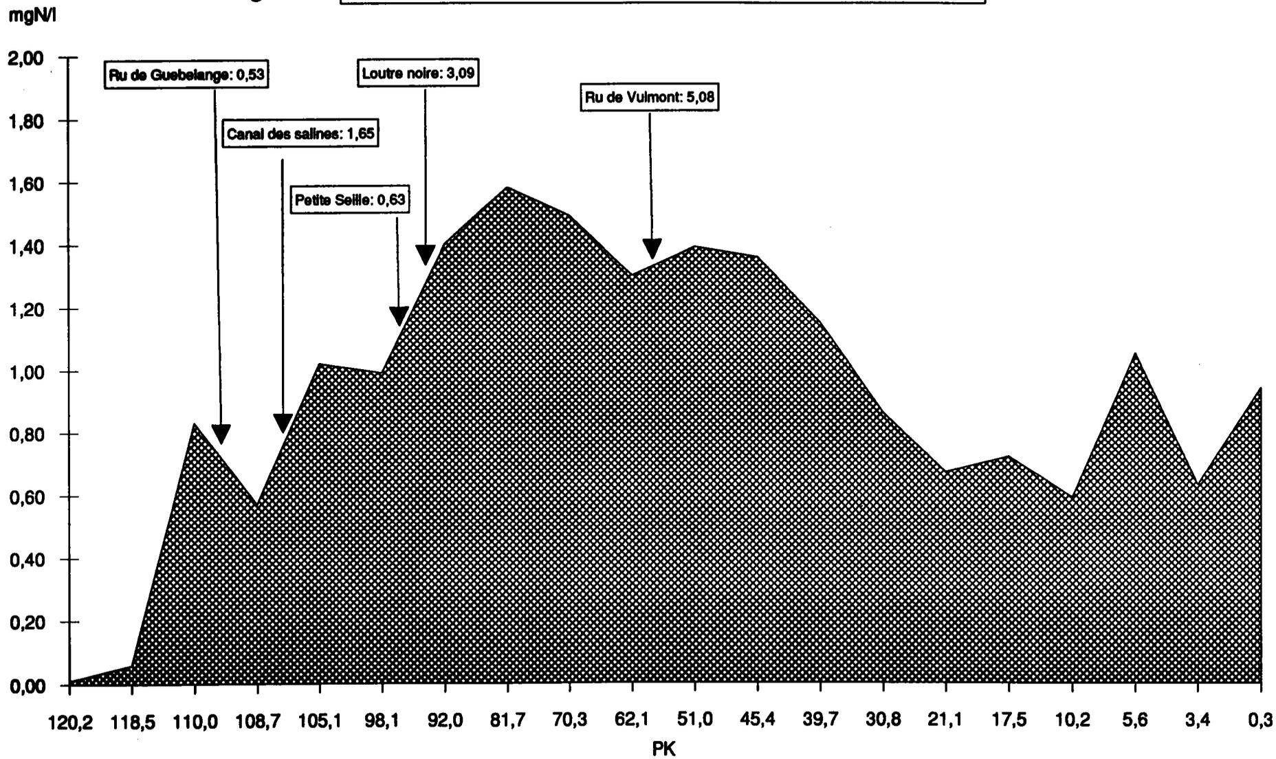
Figure 13: Profils longitudinaux des concentrations en orthophosphates et en Phosphore total réalisés dans la Seille.
