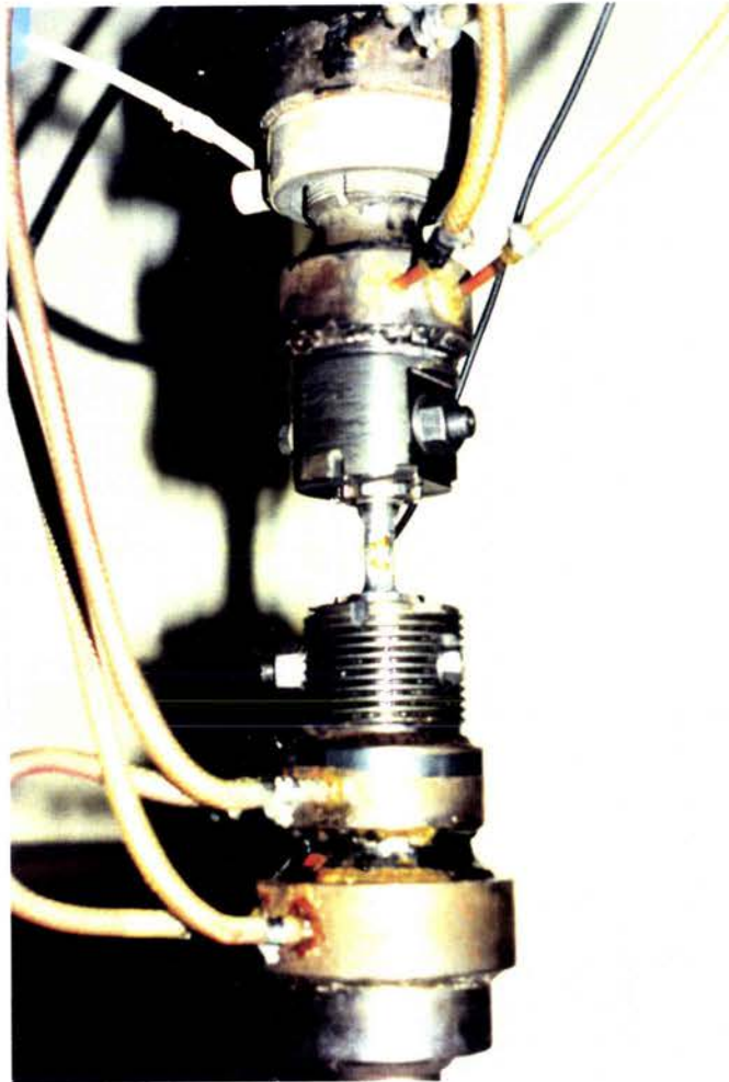
Photo 4. Dispositif d'amarrage de l'éprouvette en torsion
