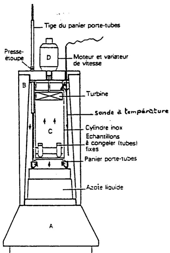
Figure 11 : Mini congélateur Nicool utilisé pour la congélation dans la vapeur d'azote liquide.
