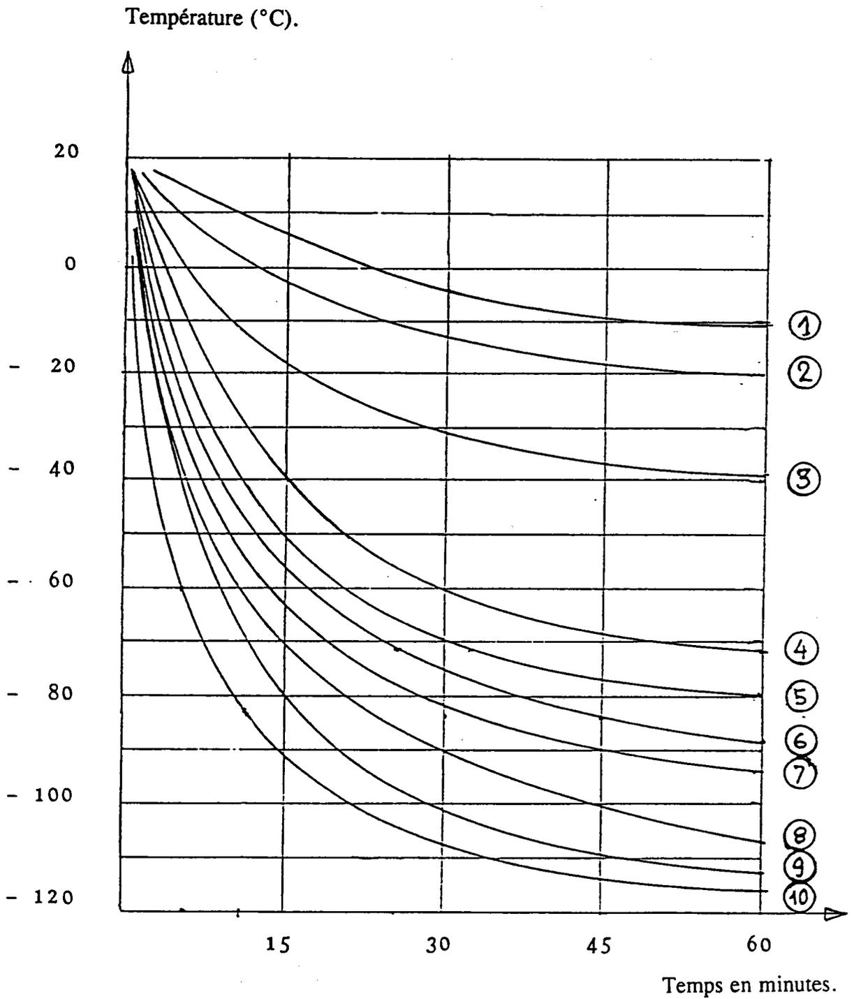
Figure 12 : Evolution de la température de l'ambiance gazeuse, au niveau des cryotubes en fonction de la vitesse de rotation du moteur de  $V_1$  à  $V_{10}$ .
