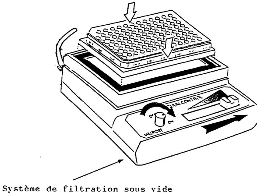
Figure 14 : Schéma de la microplaque Multiscreen et du système de filtration sous vide.
