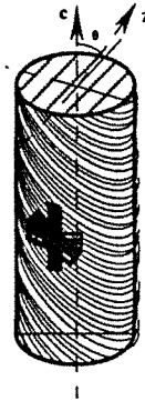
Fig. 98 : Eprouvette de schiste pour un essai clinotrope.
