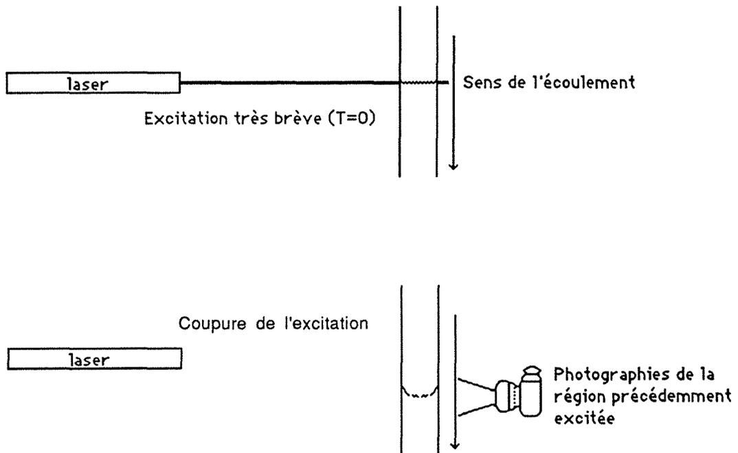
**Figure 9.8 : Exemple de suivi des déformations d'un cylindre de fluide en conduite cylindrique par phosphorescence**
