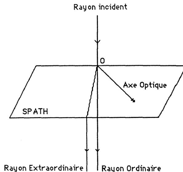
Figure 9.9 : Double réfraction dans un cristal de "Spath"
