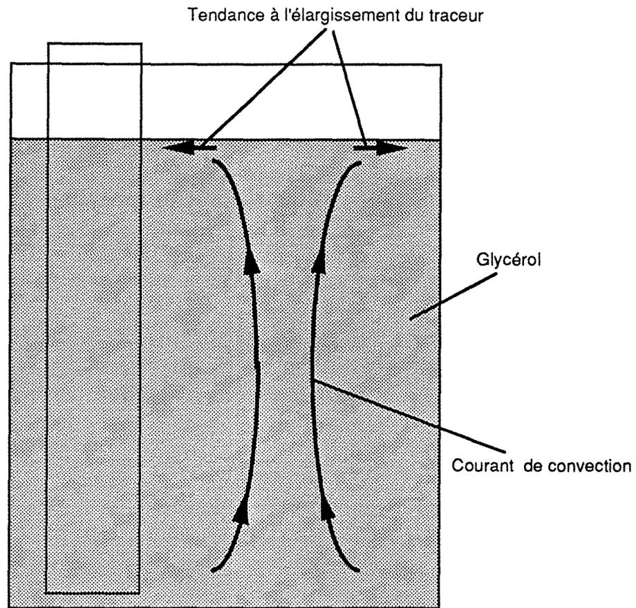
**Figure 9.15 : Mouvements de convection au sein du mélangeur**
