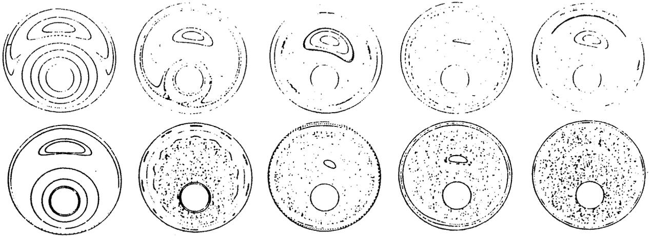
**Figure 11.9 : Effet de l'inversion d'un des sens de rotation sur l'écoulement (3D)**
