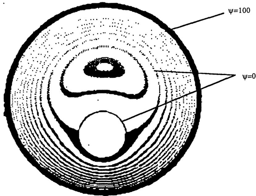
Figure 8.9 : Ecoulement en géométrie bipolaire
