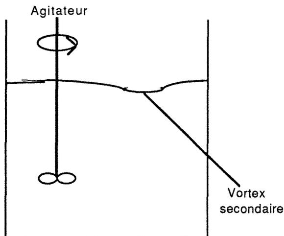
**Figure 8.3 : Agitation à l'aide d'un mobile excentré**
