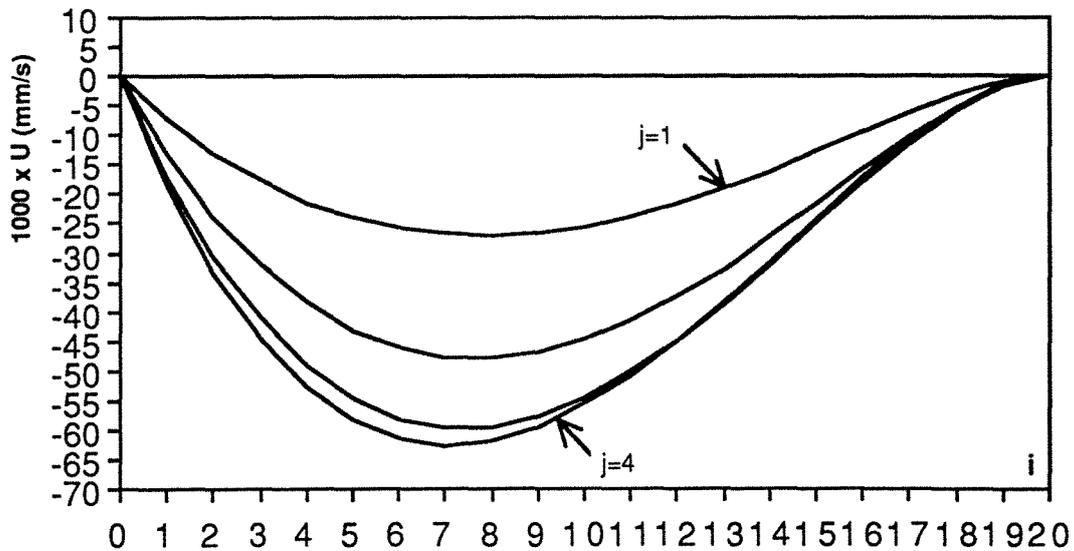
**Figure 8.6 : profil des vitesses radiales**
