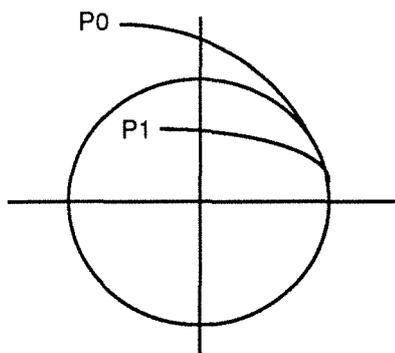
Si le point représentatif du système se trouve initialement en P0, la trajectoire de celui ci va lentement tendre vers le cycle correspondant à la configuration stable du système. Ce
