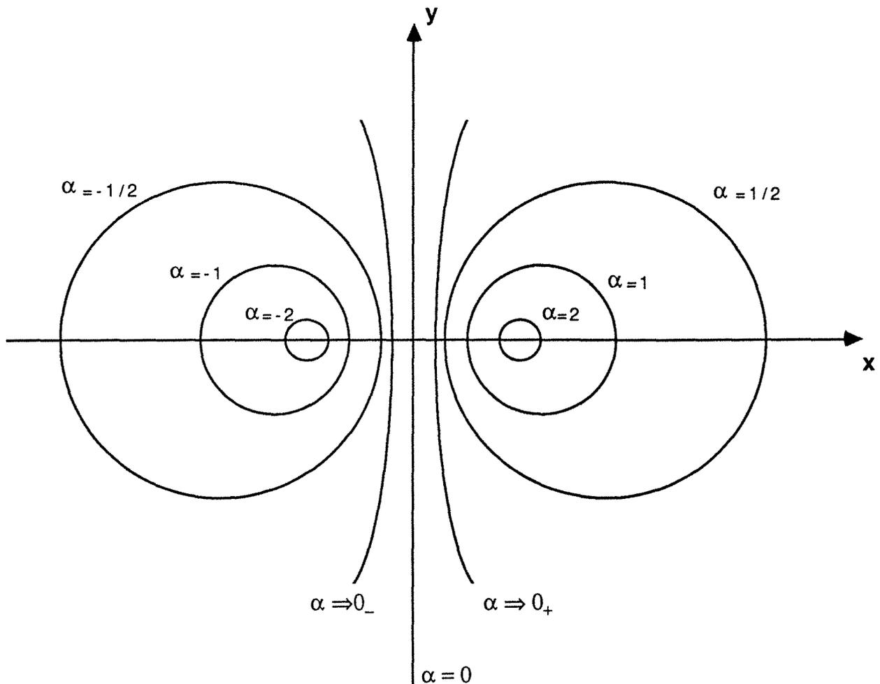
**Figure 7.1 : Cercles iso-alpha en géométrie bipolaire**
