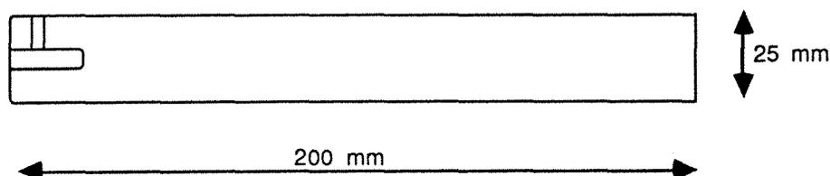
Figure 9.1 : Représentation et côtes du cylindre intérieur
