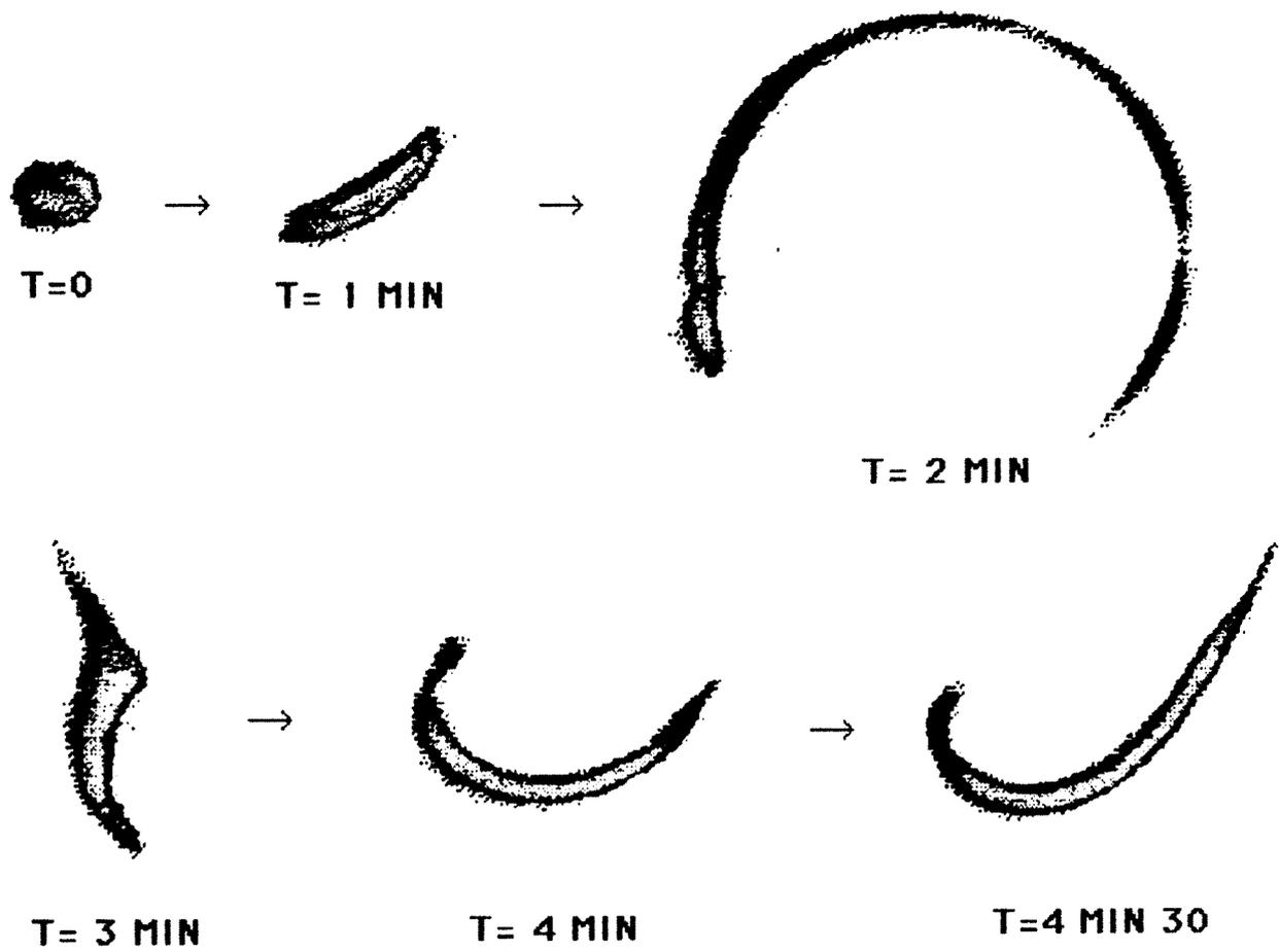
Figure 11.17.a : Déformation d'une goutte de fluide colorée
