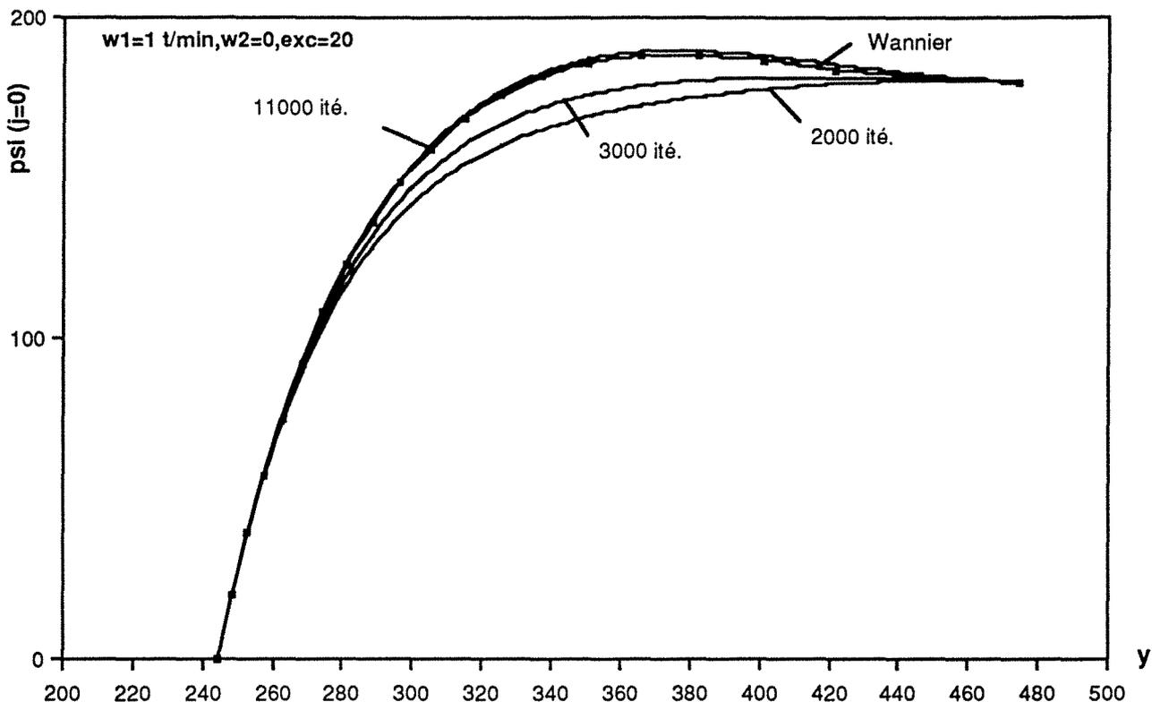
**Figure 8.1 : répartition des valeurs de la fonction de courant en fonction du taux de convergence du calcul suivant la coordonnée  $y$**
