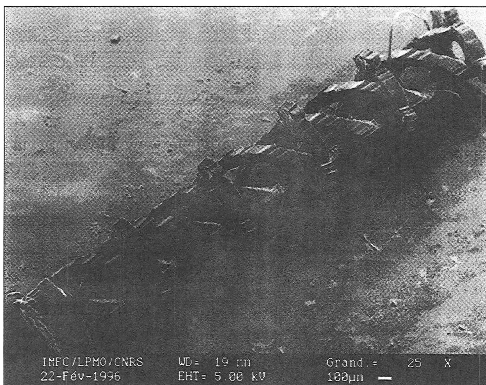
figure 8.8 : Photographie en microscopie électronique à balayage d'une structure polymère d'un microactionneur à élasticité répartie formé de 5 modules identiques réalisé par microstéréolithographie par masquage dynamique.
