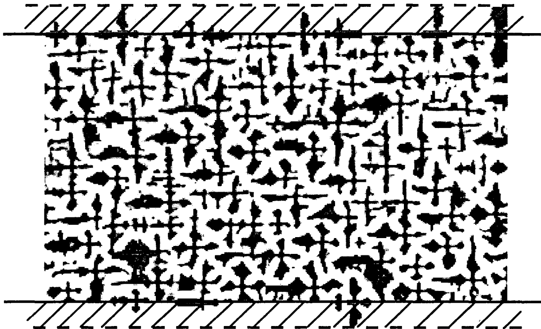
Figure 3.17 : Section d'une plaque de 3 mm d'épaisseur. Les dendrites incomplètes en contact avec un des bords de la plaque sont complétées en gris à l'extérieur de la surface par effet miroir.
