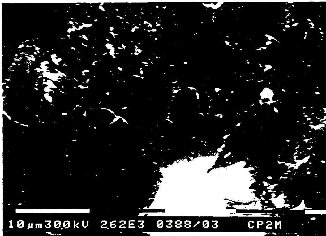
(b) : image au MEB en électrons secondaires d'une sphère de couleur claire dans un grain du précipité OM_5 + CS_2 , à pH 10
