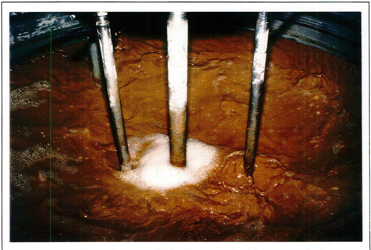
Annexe III. Figure 8 : Réaction enzymatique (55°C) après traitement thermique (85°C, 15 mn) permettant une solubilisation partielle des graisses et des tissus conjonctifs.
