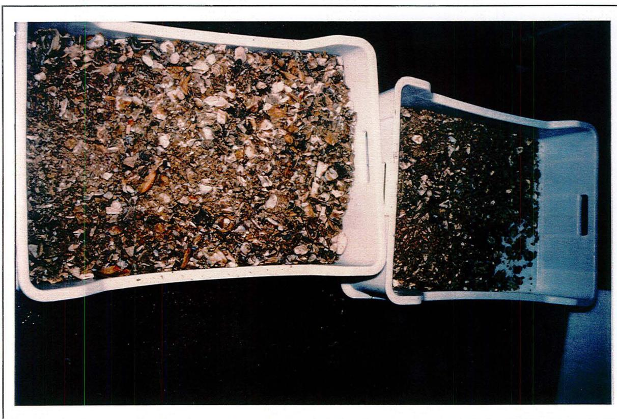
Annexe III. Figure 18 : Résidus osseux et fractions protéiques non hydrolysées.
