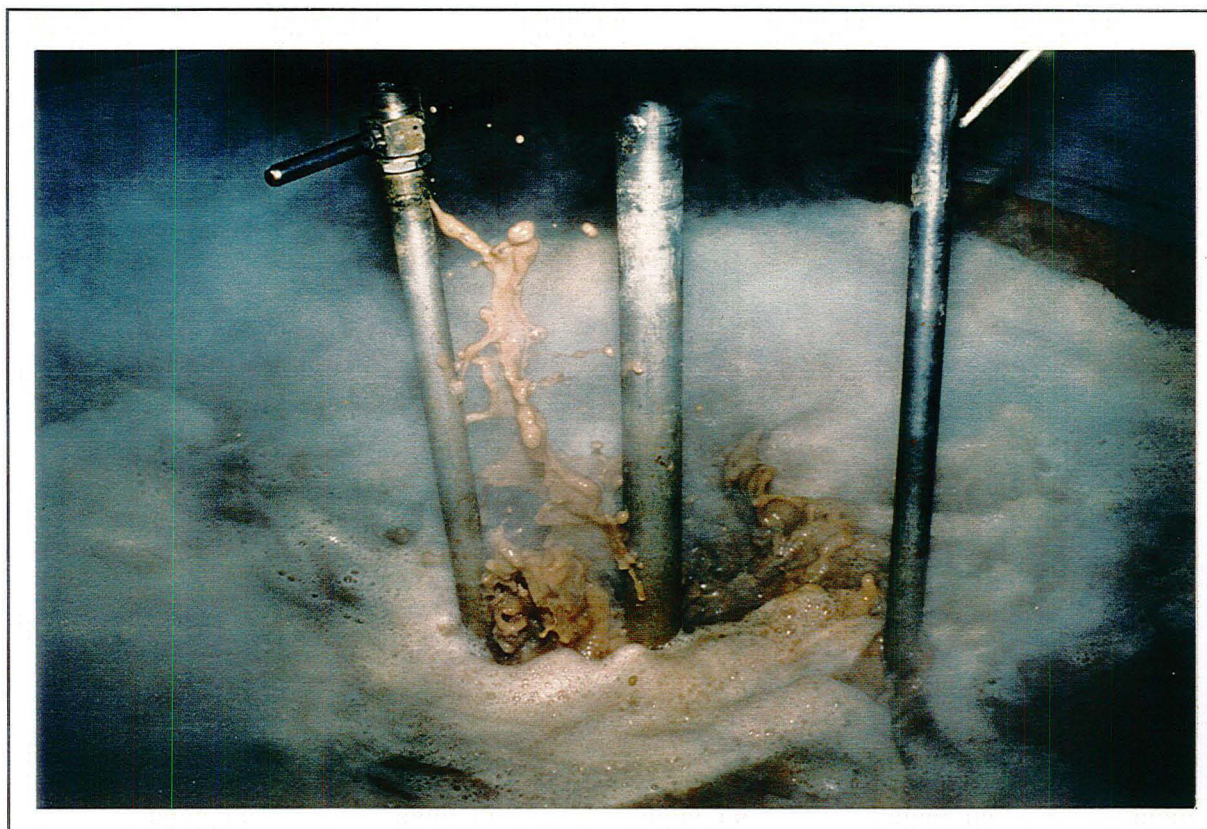
Annexe III. Figure 9 : Traitement thermique par injection de vapeur dans la solution hétérogène, nécessaire à l'inactivation enzymatique (95°C, 20 mn).
