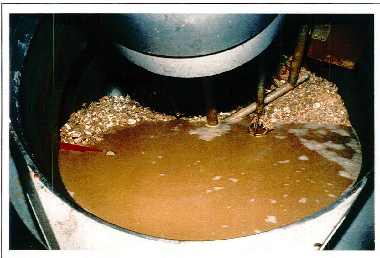
**Annexe III. Figure 10 :** Hydrolysats protéiques et résidus des co-produits de veau après traitement thermique nécessaire à la dénaturation des protéases.
