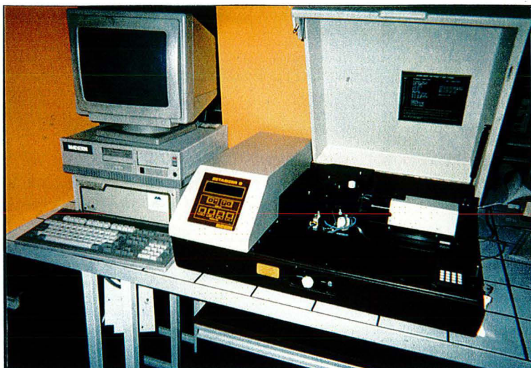
Figure II.4. Photographie du dispositif expérimental de la technique de diffusion dynamique (ou statique) de la lumière.
