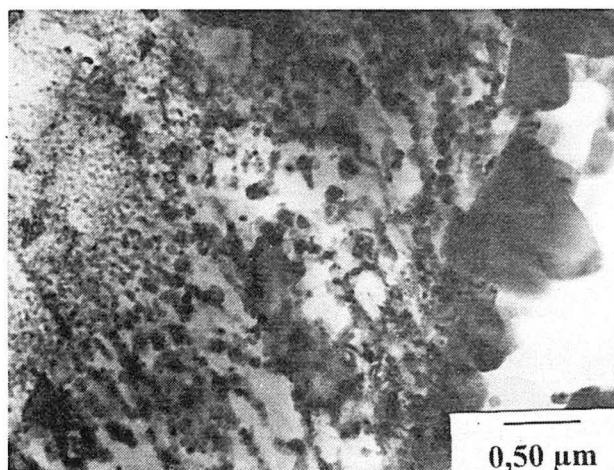
Figure 5.49 - Alliage 205/1 : on observe une augmentation graduelle de la taille des siliciures au fur et à mesure qu'on se rapproche de la frontière de la particule (du coin en bas à gauche vers le coin en haut à droite) liée à un probable changement de régime thermique ; ensuite on passe de quelques gros précipités qui tapissaient la surface de la particule adjacente à une solution solide.
