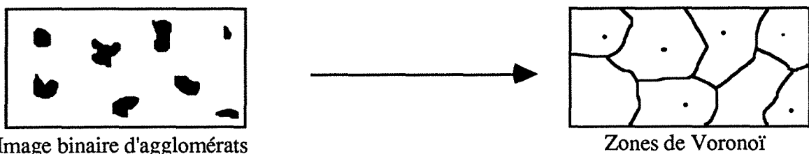
Figure 2.20 : Transformation d'une image par la méthode de la partition de Voronoï.
