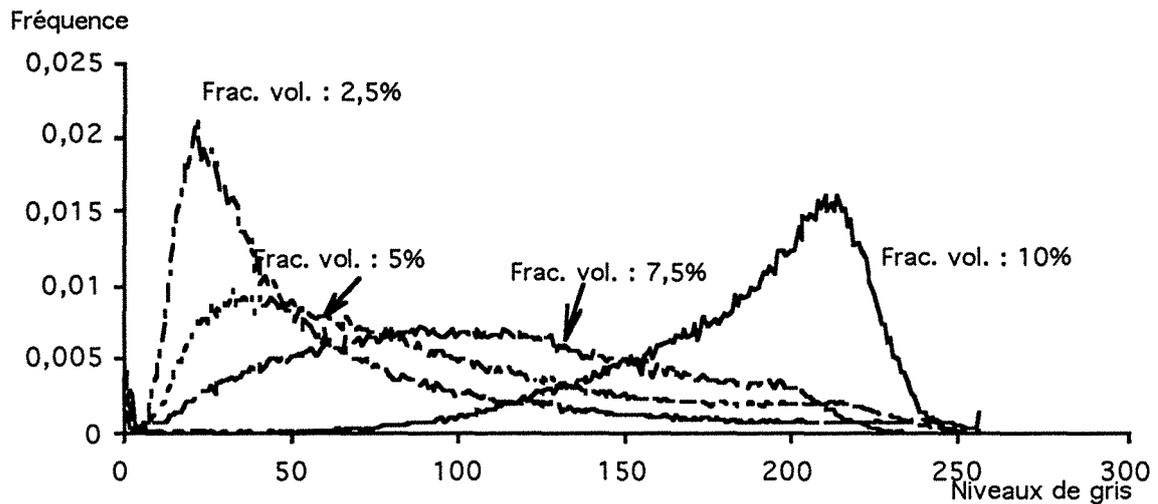
Figure 4.16 : Histogrammes des niveaux de gris du composite chargé en noir de carbone Printex L à différentes fractions volumiques.
