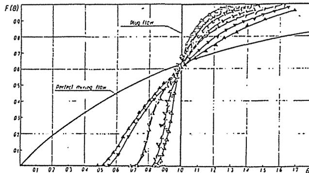
Figure 3.11 : Distribution des temps de séjour dans une extrudeuse monovis (d'après Kemblowski et Sek (1981)).
