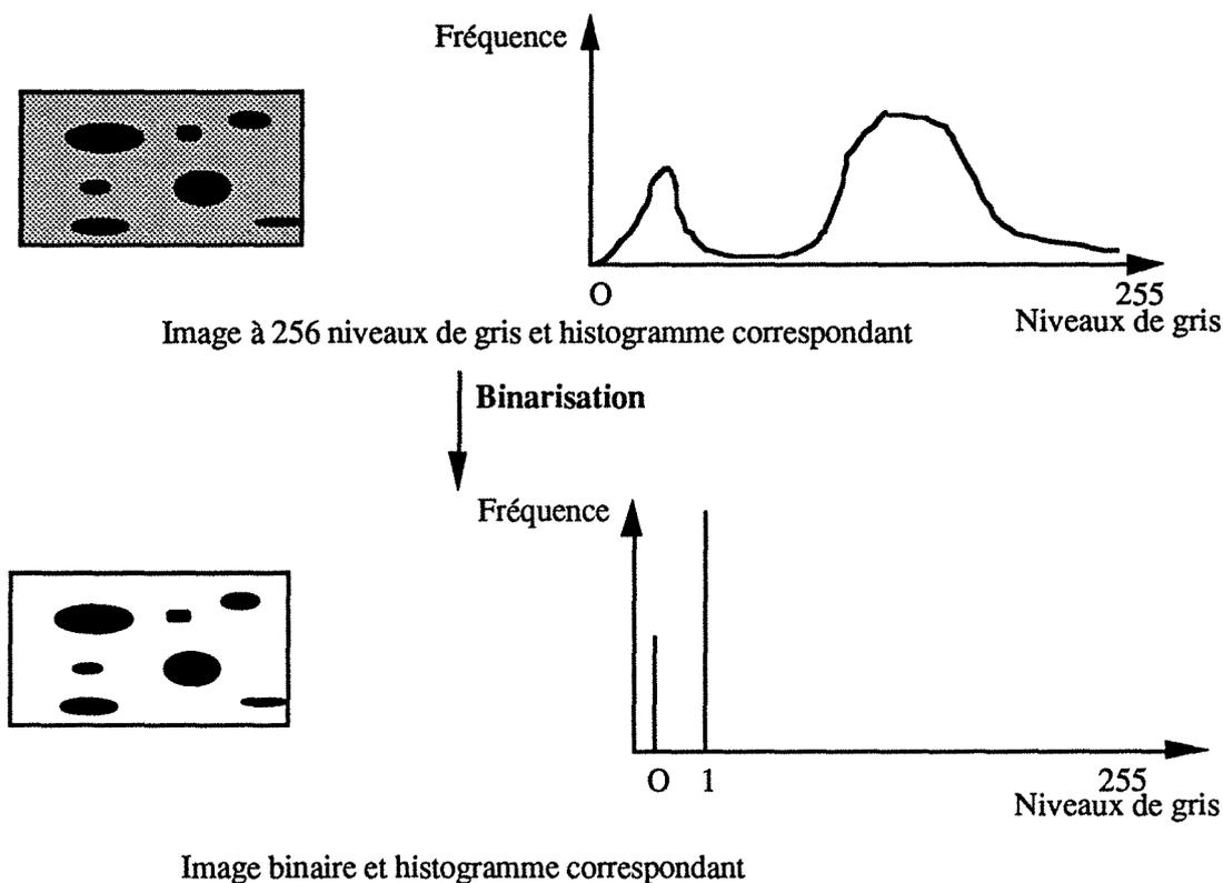
Figure 2.17 : Binarisation d'une image à 256 niveaux de gris.
