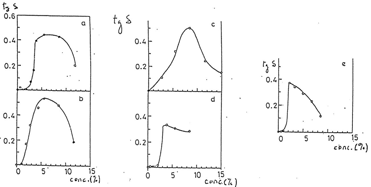
Figure 1.9 : Evolution du facteur de pertes,  $tg \delta$ , en fonction de la concentration volumique en charge pour différents noirs de carbone d'après Yacubowicz J. et Narkis M., 1990 (a: Conductex 975, b: Conductex 40-220, XC-72, c: Corax L6, d: Ketjenblack EC)
