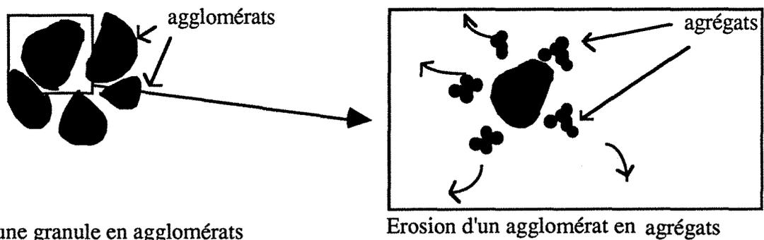
Figure 4.5 : Mécanismes de rupture et d'érosion.
