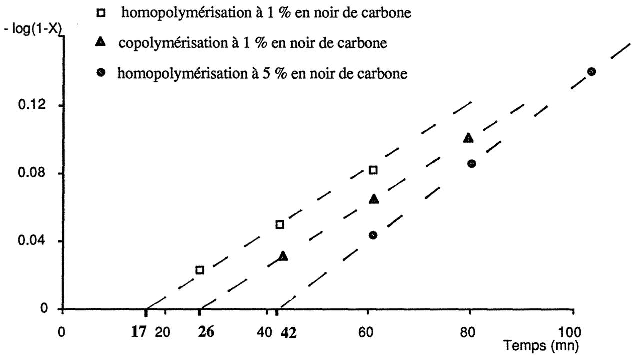
Figure 5.12 : Détermination du temps d'inhibition des polymérisations.
