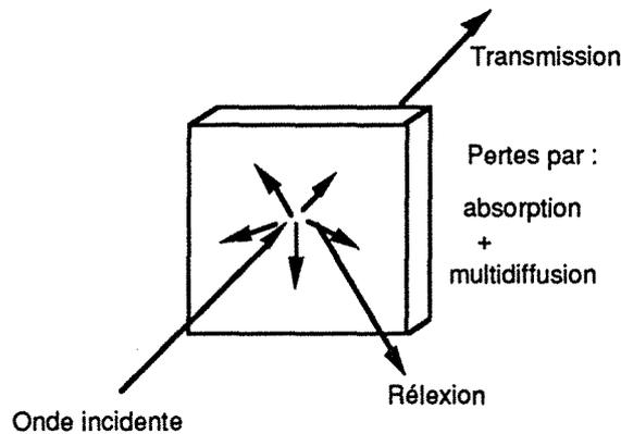
Figure 1.7 : Comportement d'une onde électromagnétique vis-à-vis d'un matériau.
