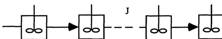
Figure 3.4 : Modèle des mélangeurs en cascade.
