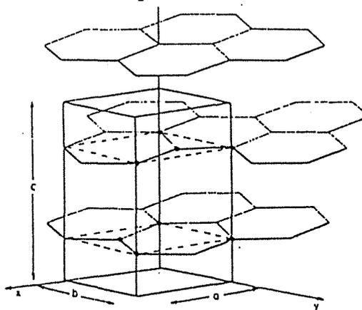
Figure 1.1 : Schéma de la structure du graphite hexagonal.
