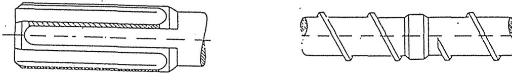
Figure 3.10 : Elements favorisant le mélange dispersif dans les extrudeuses monovis.
