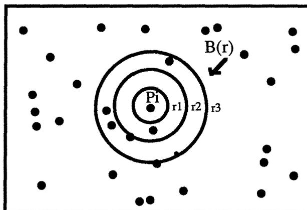
Figure 2.21: Exemple de construction d'une distribution radiale.
