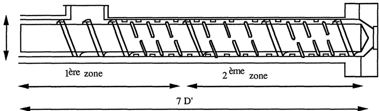
Figure 2.2 : Schéma de la vis d'extrusion.
