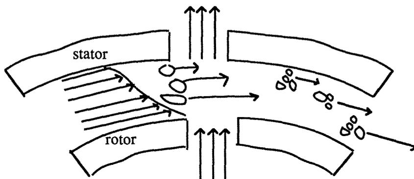
Figure 2.6 : Frottement des matières solides dans le gradient de vitesse de l'interstice entre le rotor et le stator de l'ultra-homogénéiseur.
