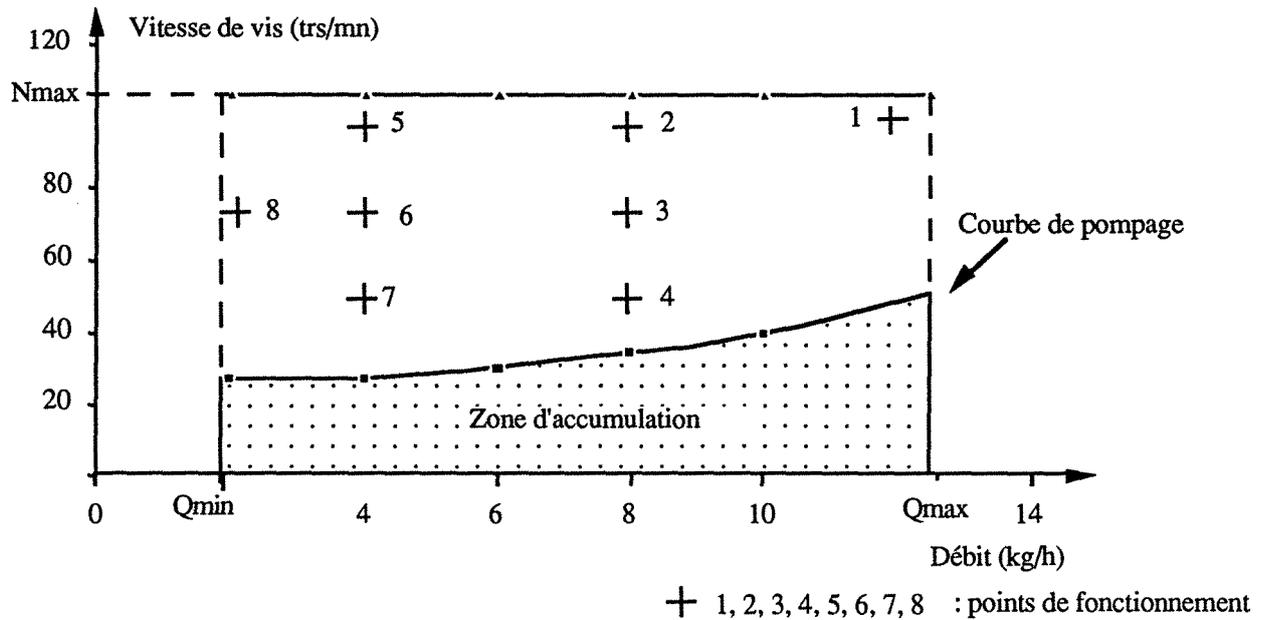
Figure 3.21 : Zone de fonctionnement de l'extrudeuse.
