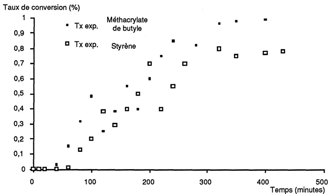
Figure 5.11 : Taux de conversion du styrène et du méthacrylate de butyle en fonction du temps (copolymérisation réalisée avec une fraction massique de noir de carbone de 1 %).
