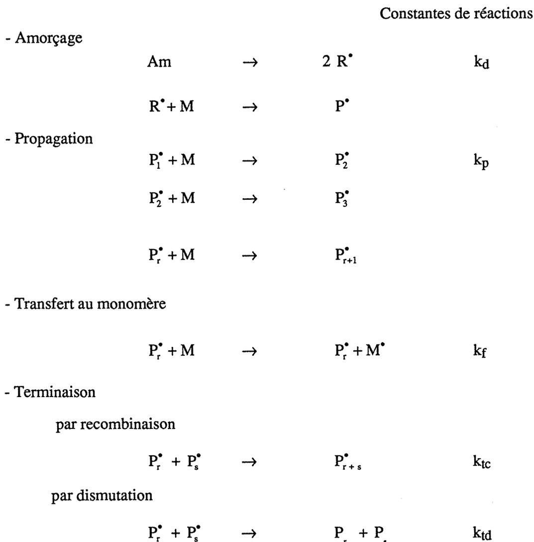
A partir de ce schéma et en écrivant les vitesses de production de chaque espèce, on obtient un système d'équations différentielles. Théoriquement, la résolution de ce système devrait permettre d'obtenir les concentrations de chaque espèce à l'instant t. Pratiquement, la résolution ne peut s'effectuer qu'en faisant trois simplifications. La première repose sur un principe et les deux suivantes sur les résultats d'observations expérimentales. Ce sont :
