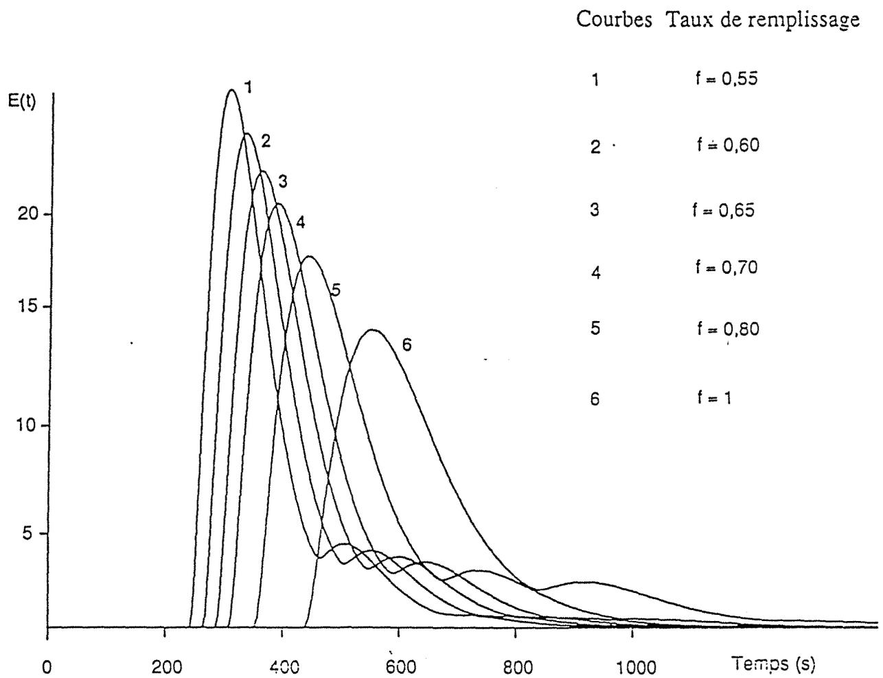
Figure 3.33 : Evolution des courbes de distributions des temps de séjours pour différents taux de remplissage.
