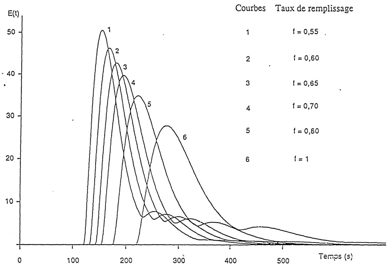
Figure 3.34 : Evolution des courbes de distributions des temps de séjours pour différents taux de remplissage.
