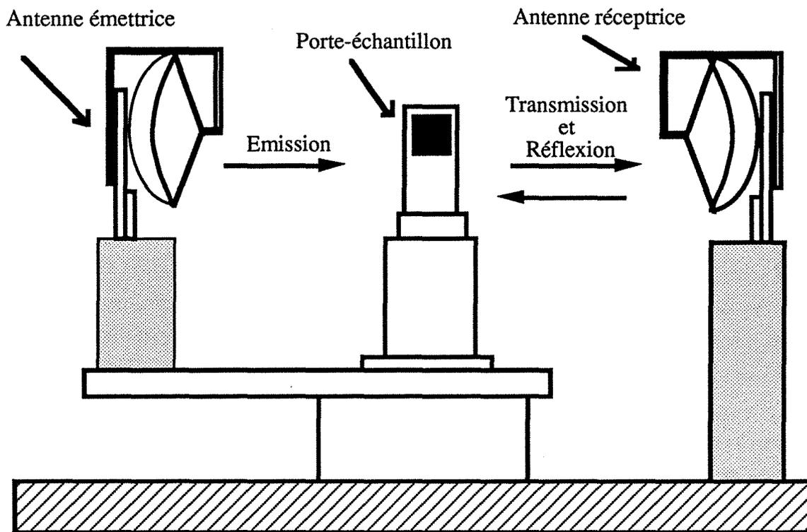
Figure 2.15 : Dispositif de mesure de permittivité des matériaux.
