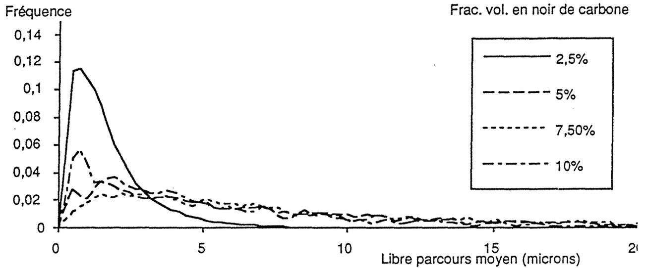
Figure 4.17 : Libre parcours moyen dans la zone grise en fonction de la fraction volumique de noir de carbone.
