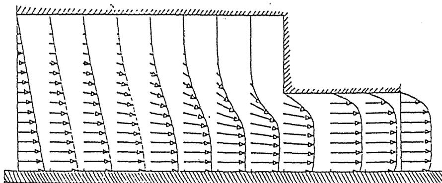
Figure 4.4 : Ecoulement élongationnel dans une filière d'extrusion (d'après Hannachi et Mitsoulis (1990)).
