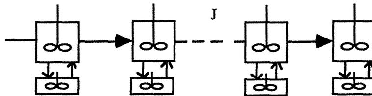
Figure 3.5 : Modèle des mélangeurs en cascade avec échange.
