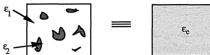
Figure 6.1 : Représentation d'un milieu hétérogène par un milieu effectif.
