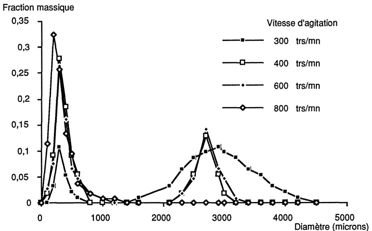
Figure 5.8 : Distributions des diamètres de billes issues de l'homopolymérisation en suspension du styrène pour différentes vitesses d'agitation.
