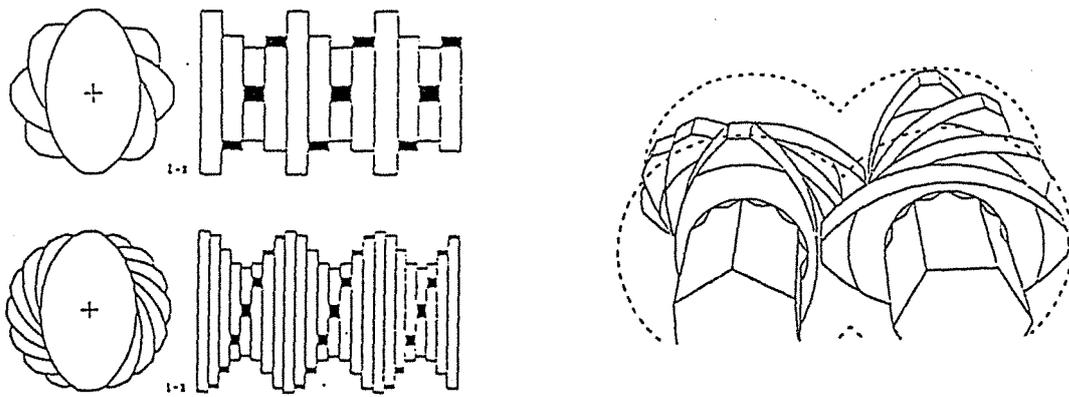
Figure 3.14 : Disques de malaxage pour extrudeuses bavis.
