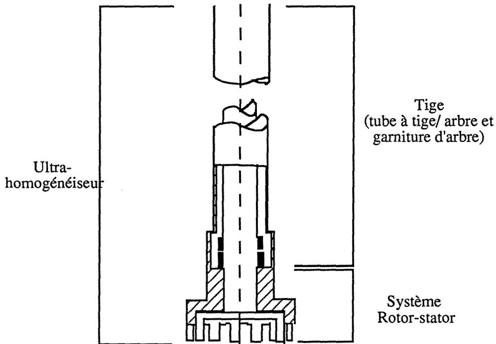
Figure 2.5 : Vue en coupe de l'ultra-homogénéiseur.
