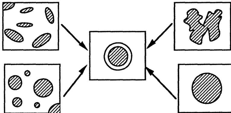
Figure 6.6 : Cellule unité représentative de différentes morphologies.
