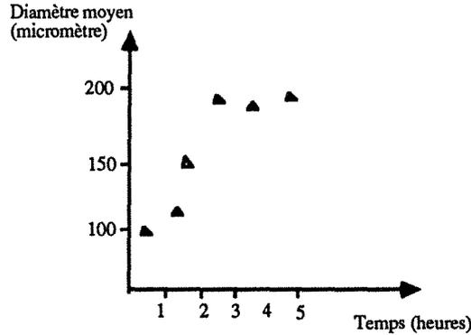
Figure 5.5 : Evolution du diamètre moyen des gouttelettes en fonction du temps de polymérisation (d'après Ueda et coll. (1972)).
