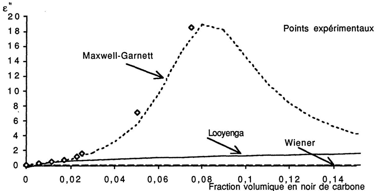
Figure 6.17 : Modélisation de la partie imaginaire de la permittivité de matériaux réalisés par extrusion en fonction de la fraction volumique en noir de carbone Printex XE2.
