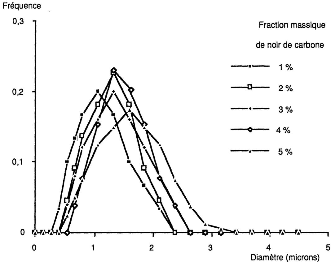
Figure 5.16 : Distributions des tailles des agglomérats en fonction de la fraction massique de noir de carbone.
