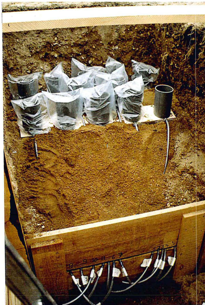
Photo 2 : Mise en place des lysimètres.
