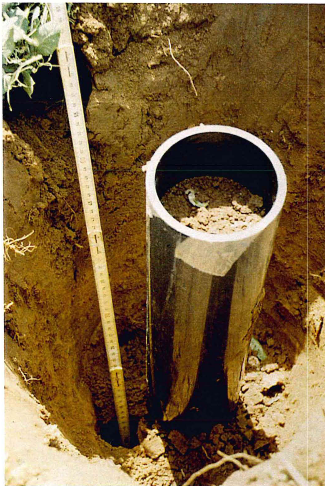
Photo 1 : Prélèvement d'une colonne de sol au terrain (sol brun calcique).
