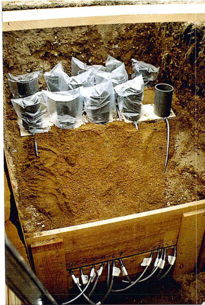
Photo 2 : Mise en place des lysimètres.
