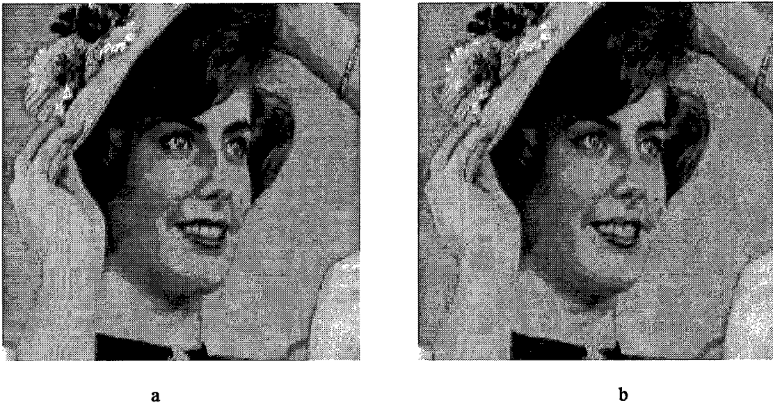
Figure 9.6 : Application à l'image des deux techniques de codage, a), par zone morte pour R= 1.2\text{bpp} , \text{PSNR} = 35.50\text{db} , b) par quantification scalaire pour R=1.89\text{bpp} , \text{PSNR} = 33.20\text{db} .
