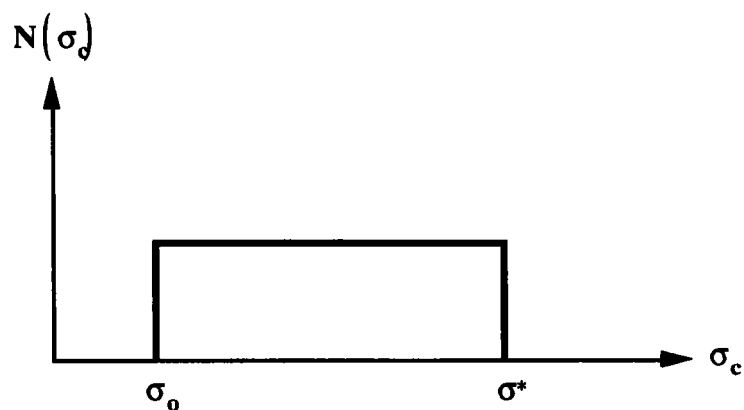
Figure 38 : Distribution de la densité de défauts
