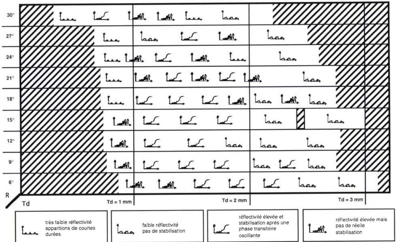
Figure III.3.3. Cartographie donnant le type de comportement temporel pour l'échantillon 1 dans le plan (Td - R).
