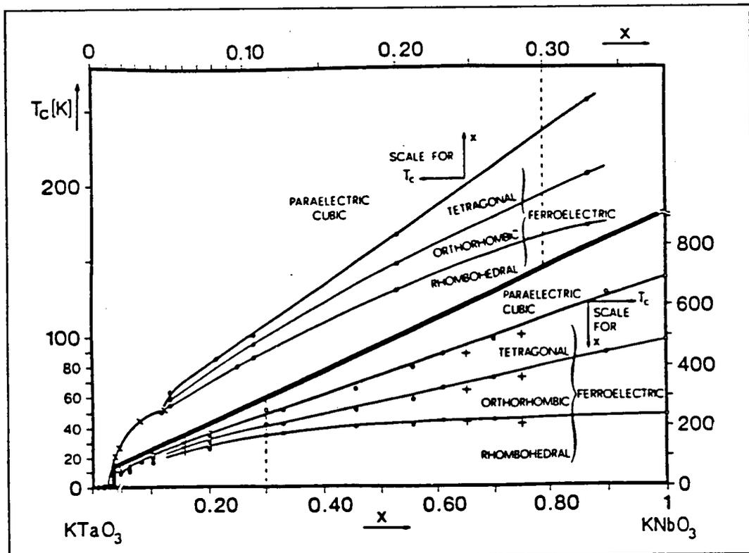
Figure 1.9: Diagramme de phase de KTN (*Rytz*, 1983).
