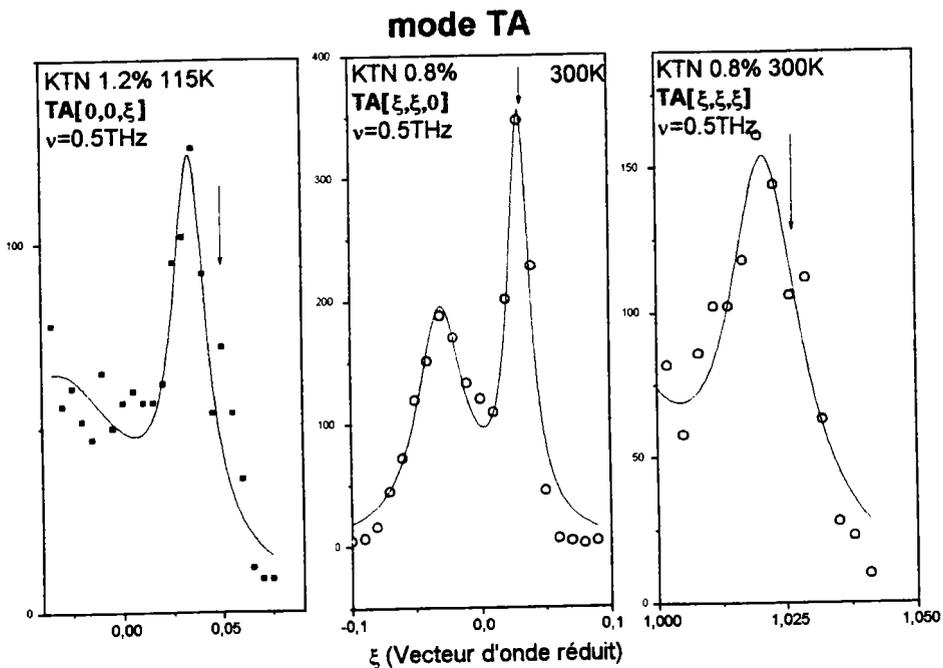
**Figure 3.21:** Mesures de diffusion de neutrons à 0.5THz sur le phonon transverse acoustique (TA) selon  $[\xi 0 0]$ ,  $[\xi \xi 0]$ , et  $[\xi \xi \xi]$ . Les flèches représentent les valeurs de Barrett 1968, Comès et al 1972, Rytz et al 1983 extrapolées à 0.5THz.
