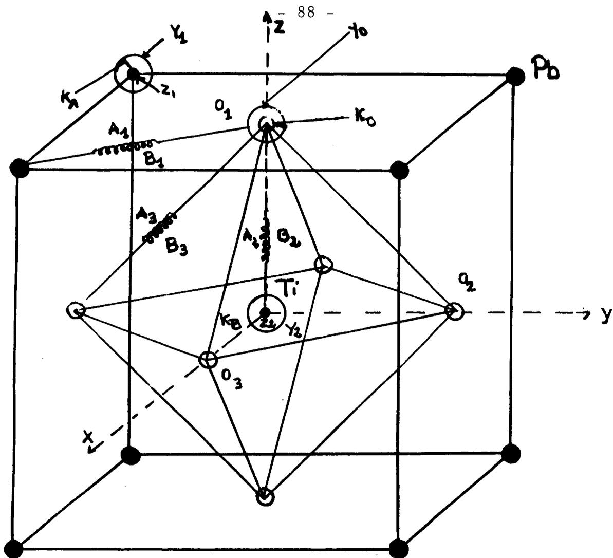
Figure (d1) : Modèle de la coquille appliquée à la phase cubique de  $\text{PbTiO}_3$ .
