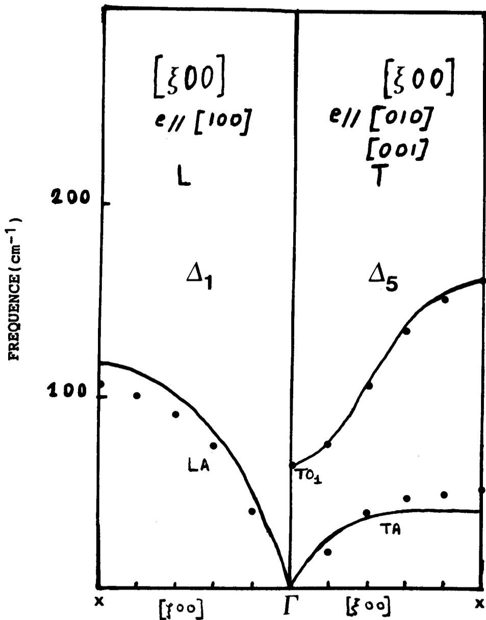
Figure (d2) : Courbes de dispersion basse fréquence dans la phase cubique (T = 510°C). Les points représentent les résultats expérimentaux, les lignes continues les calculés.
