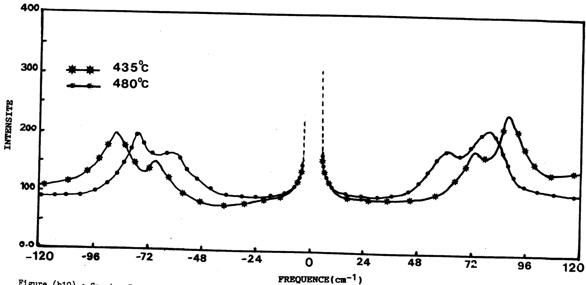
Figure (b10) : Spectre Raman c à T = 435°C et 480°C
