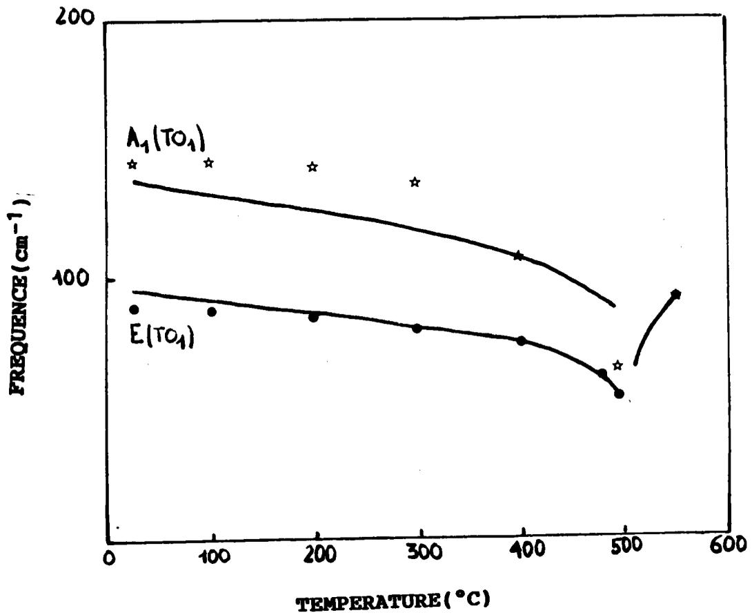
Figure (d7) : Evolution du mode basse fréquence TO<sub>1</sub> avec la température dans les phases C et Q
