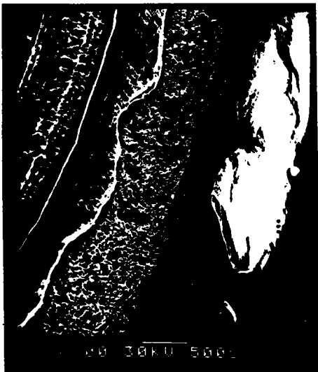
\text{Si}_3\text{N}_4 / \text{Al} / 6061 Rupture dans le joint aluminium et métal de base
