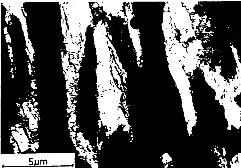
Fig II.5 : Structure cellulaire des dislocations dans des métaux à structure cristalline CC après une déformation à la température au-dessus de la température de transition. (a) monocristal de molybdène laminé à un taux de 80% à 573K [M75] (b) monocristal de fer pour une traction uniaxiale de 10% à 293K [L91]
