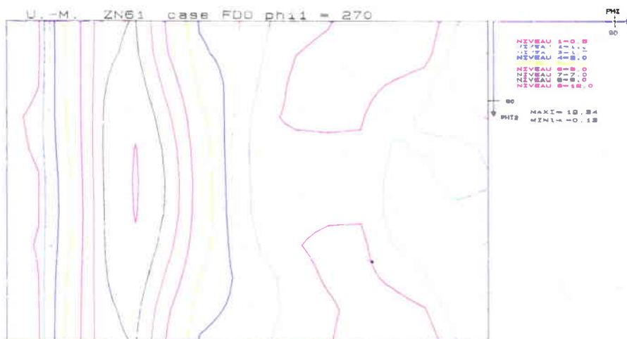
fig.d : section de l'ODF de l'échantillon 6.1 ( \phi_1=270^\circ )
