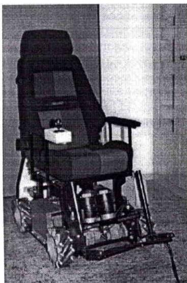
Figure II.11 : le projet OMNI et le système “Mecanum-Wheels”
