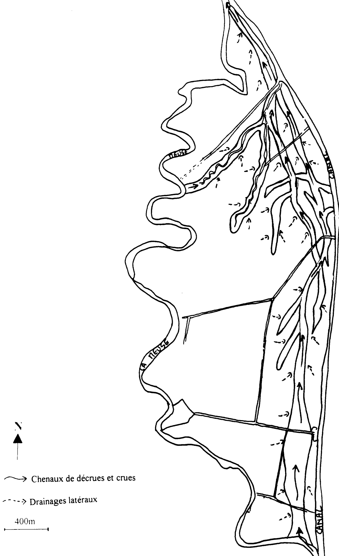
Figure 25: Système de propagation des crues et de leur drainage sur la zone de Mouzay: réseau de noues et chenaux de drainage.
