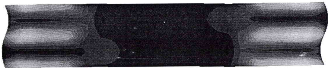
Figure D 58 : Distribution des contraintes de VON-MISES (en Mpa) dans la matrice, pour les stratifiés STRA1 et STRA2 en compression.
