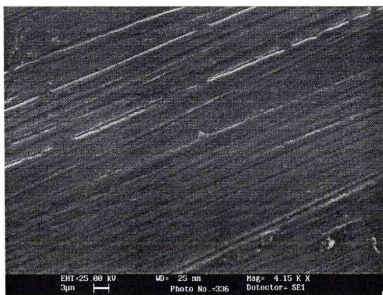
Figure II. 8. Image SEM de la surface d'Ag préparée par polissage. Agrandissement: 4150x.
