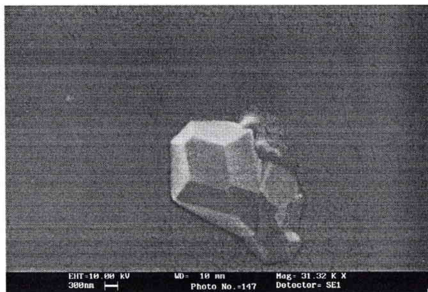
Figure IV.2c. Image SEM d'un cristal d'oligomère du PEN. Agrandissement: 31000 x.
