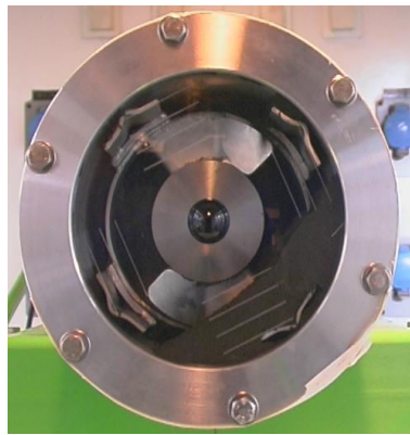
FIG. 3 – Vue d'une section du four reconstituée pour des essais en maquette froide (cf. Partie I - Chapitre 3)
