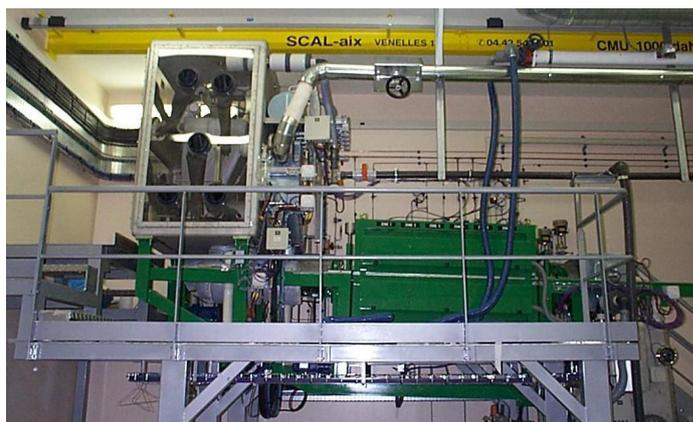
FIG. 4 – *Vue d'ensemble du four de conversion*
