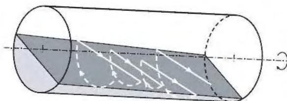
FIG. 2.3 – Chemin typique d'une particule selon l'approche géométrique [Debacq 2001]
