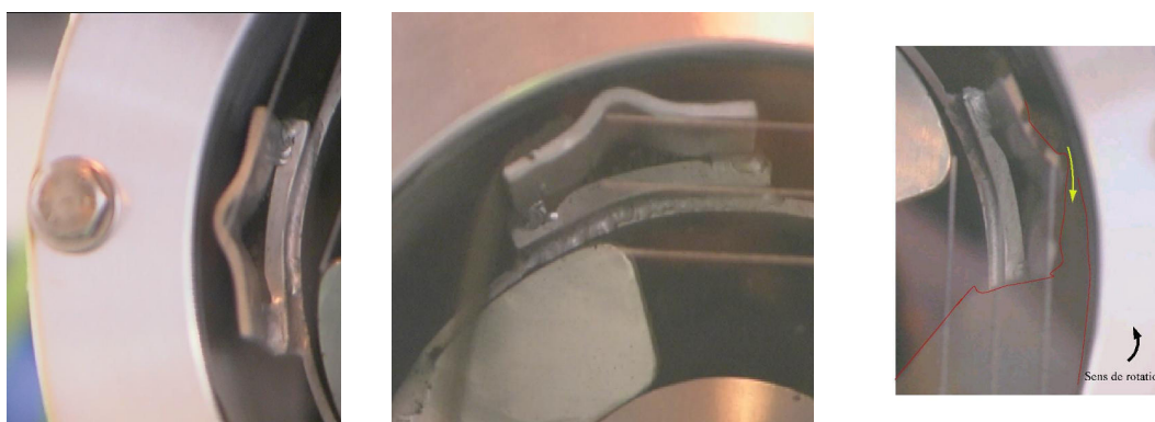
(a) géométrie du releveur (b) déchargement classique d'un releveur (c) déchargement à la base du releveur
