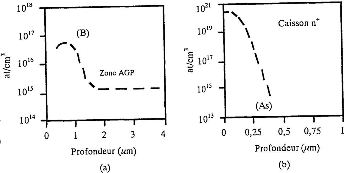
Figure IV.4: Profils de dopage (a) de la zone AGP, (b) des caissons n<sup>+</sup> de drain et de source.
