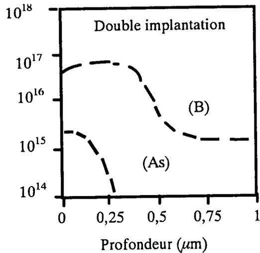
Figure IV.20: Double implantation d'ajustement de la tension de seuil du transistor.
