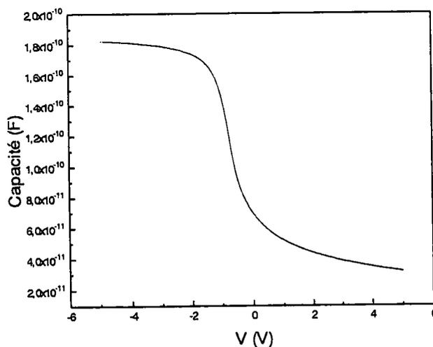
Figure II.4: Caractéristique C-V haute fréquence (1 MHz) d'une capacité MOS type P.
