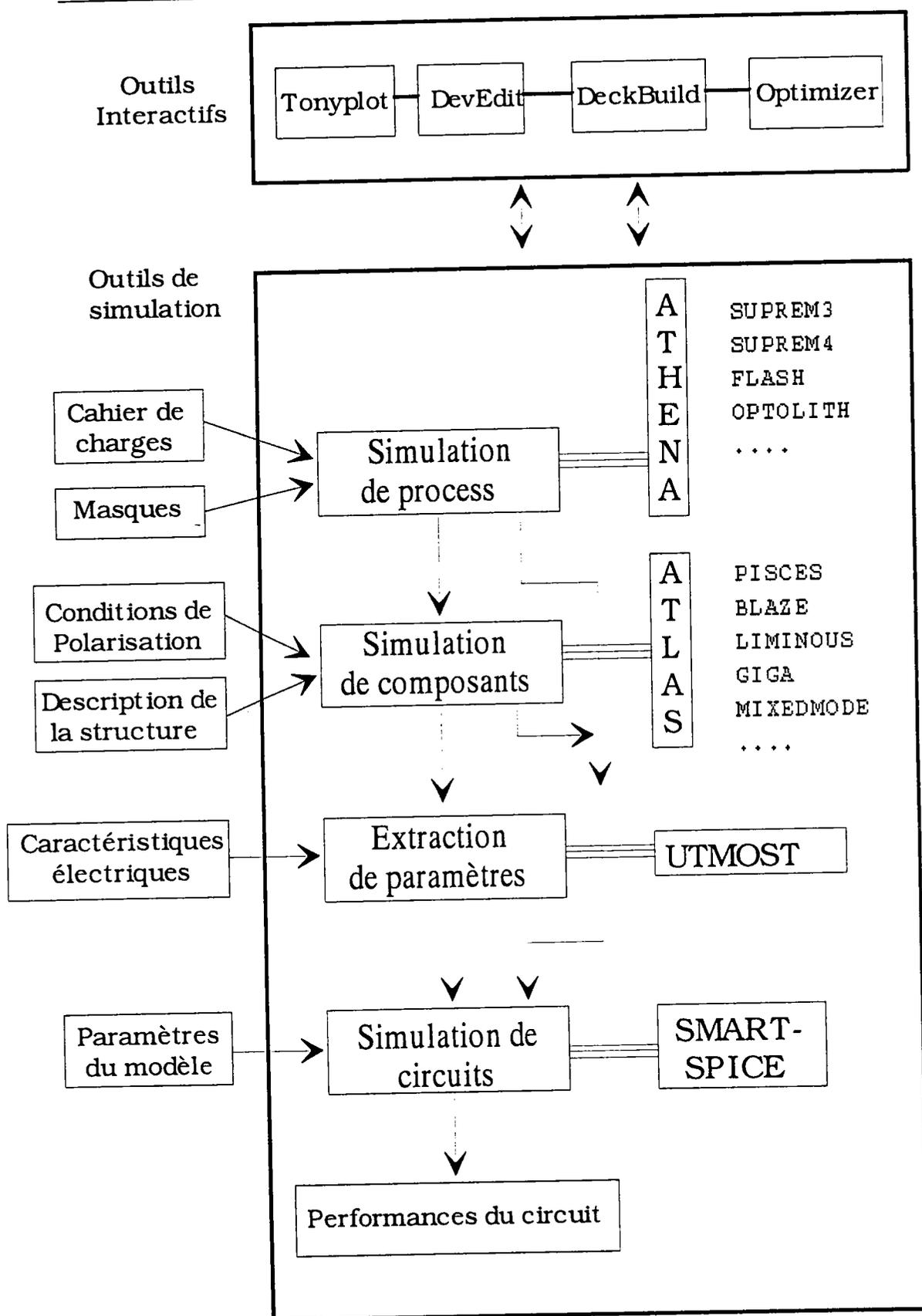
Figure IV.1: Différents niveaux et outils de simulation
