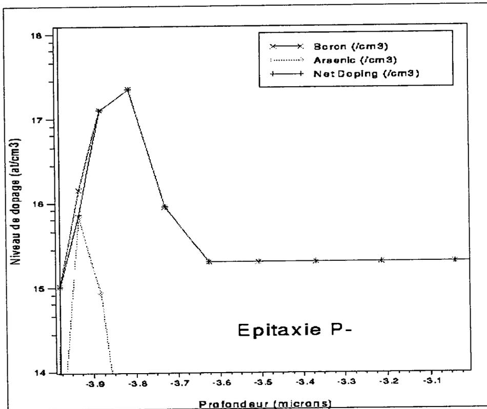
Figure IV.5: Profil de dopage d'ajustement de la tension de seuil avant recuit.
