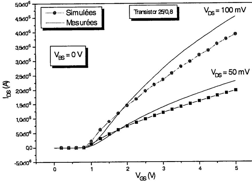
Figure IV.16: Comparaison des caractéristiques de transfert en régime linéaire pour  $V_{GS}=50$  et  $100$  mV,  $V_{BS}=0$  V. Transistor  $W/L=1,4/0,8$ .
