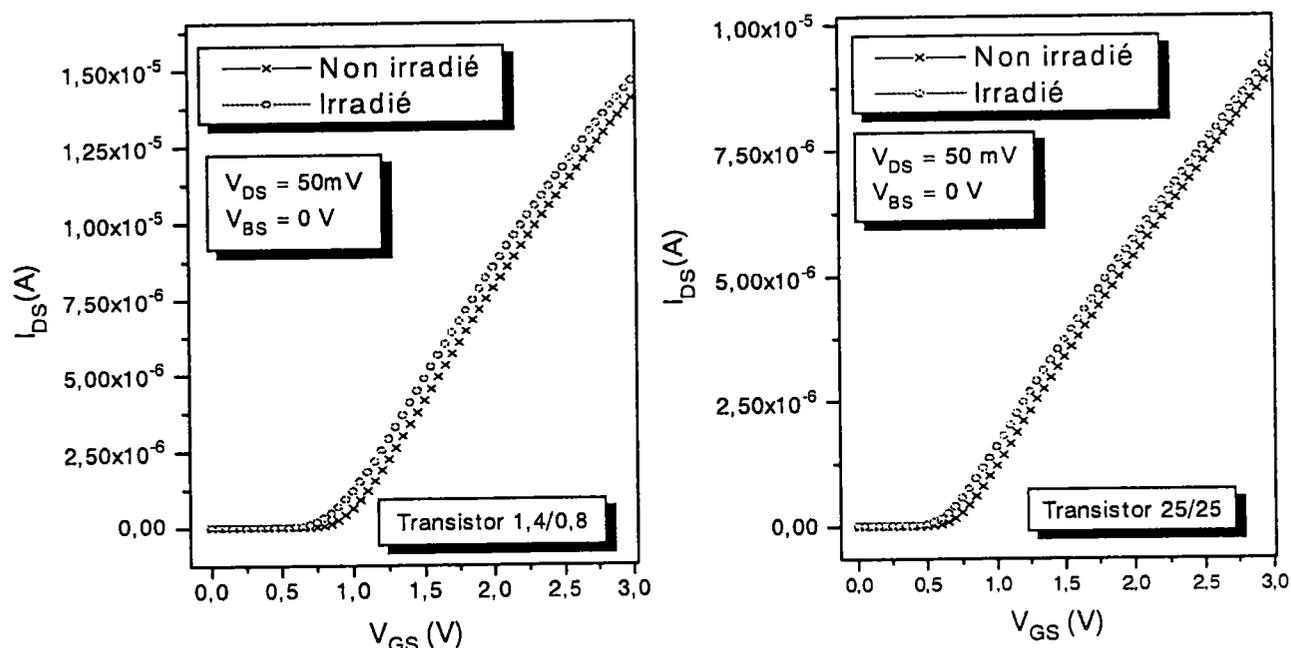
**Figure III.15 :** Evolution des caractéristiques de transfert avec l'irradiation.
