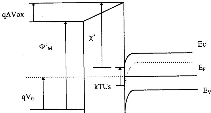
Figure I.3: Schéma de bande d'une structure réelle polarisée.
