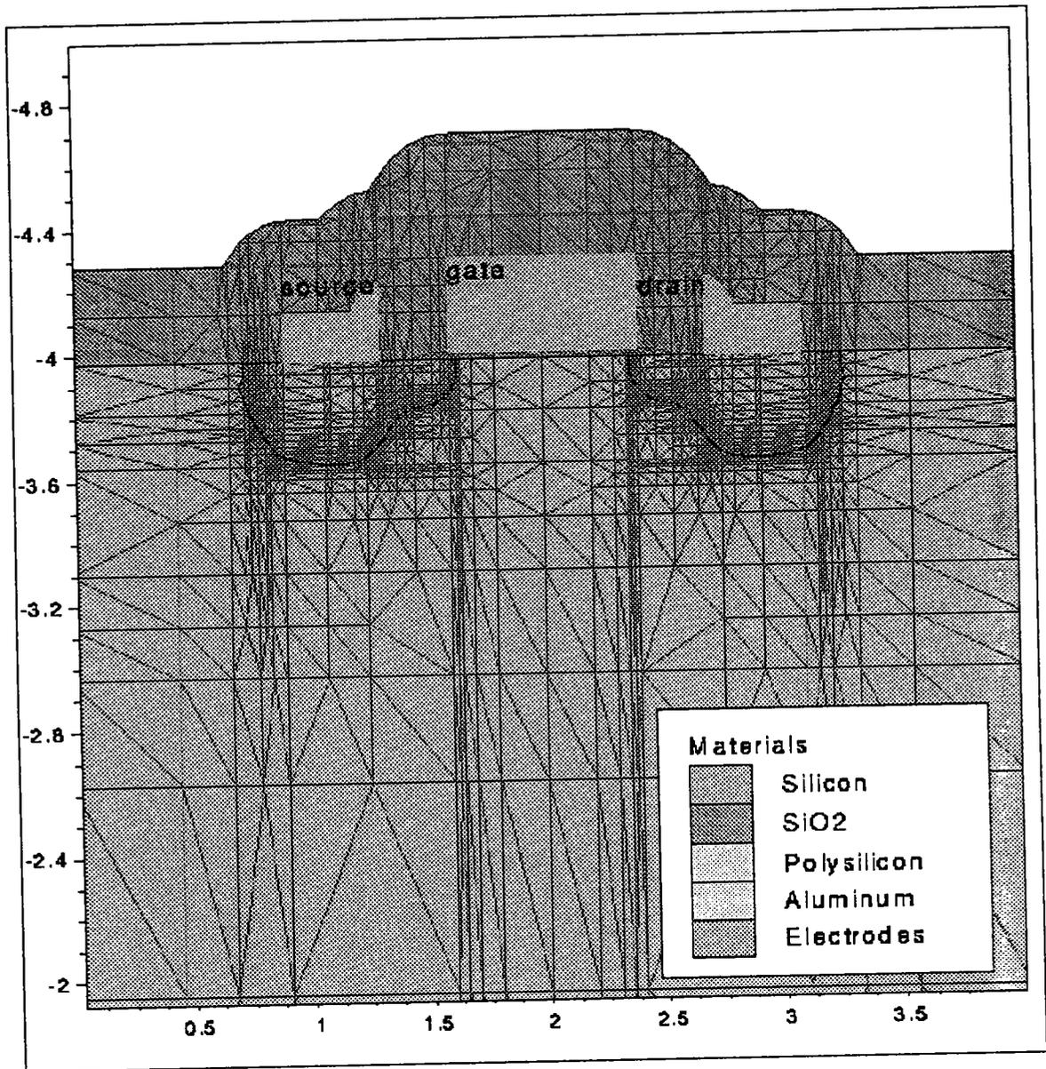
Figure IV 12: Maillage de la structure simulée, raffinement en zone de jonction.
