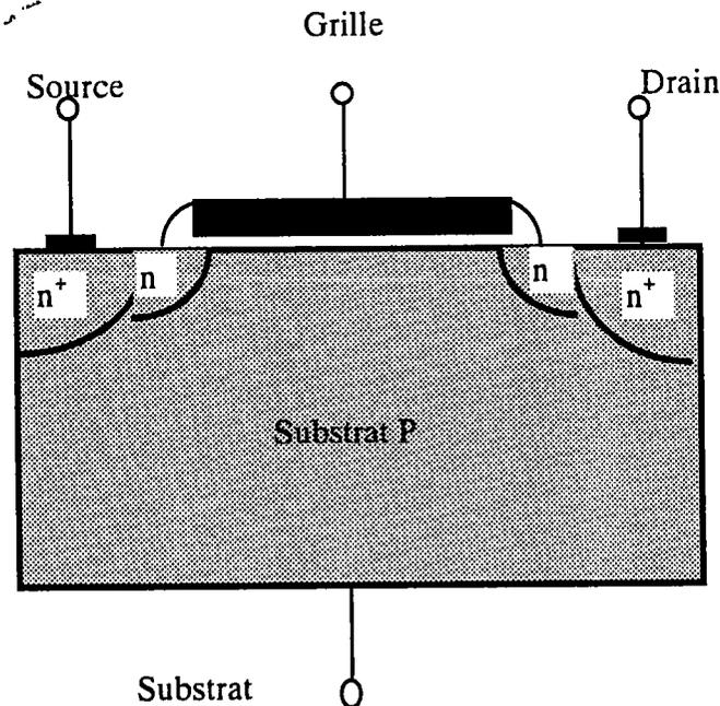
Figure II.1: Structure d'un transistor LDDMOS à canal N
