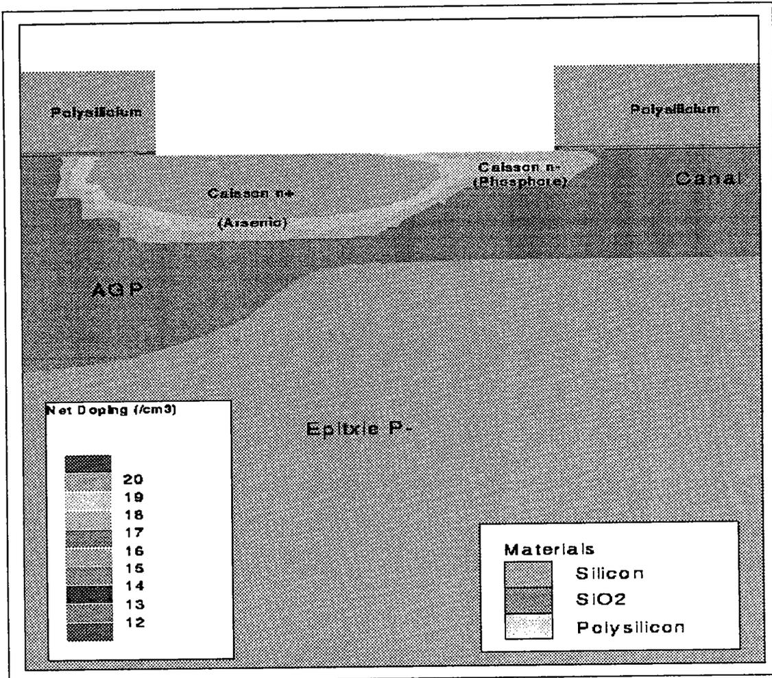
**Figure IV.7:** Implantation des caissons  $n^+$  et  $n^-$  de source après recuit.
