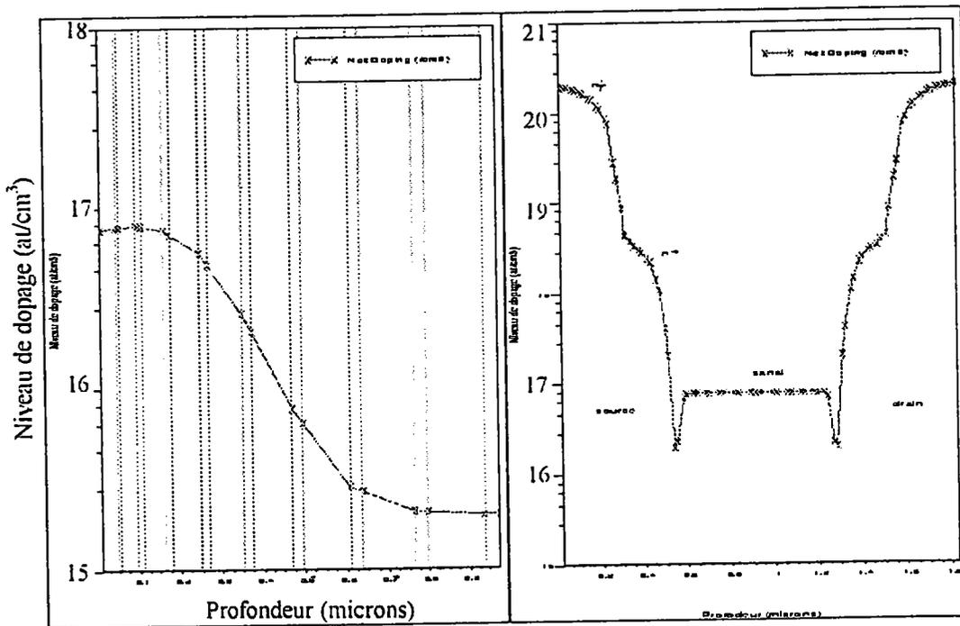
Figure IV.10: Profil de dopage de la structure finale du transistor n LDDMOS simulé
