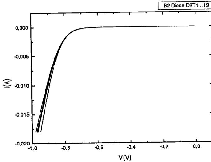
Figure III.12 : Caractéristiques I-V des diodes de protection D2
