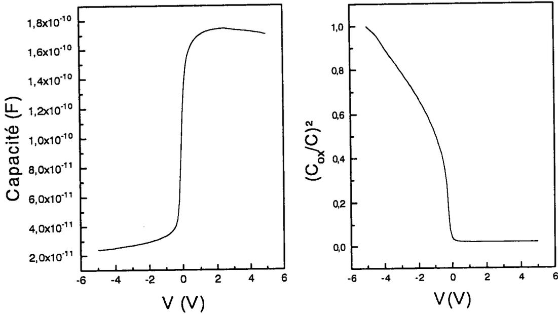
**Figure III.13 (b):** Caractéristique  $C(V)$  et  $(C_{ox}/C)^2$  de la capacité  $C2$  de type N, mesurée à haute fréquence 1 MHz.
