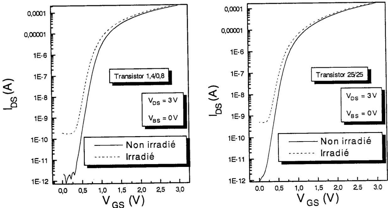
**Figure III.17 :** Evolution des caractéristiques de transfert en régime de conduction sous le seuil à la saturation.
