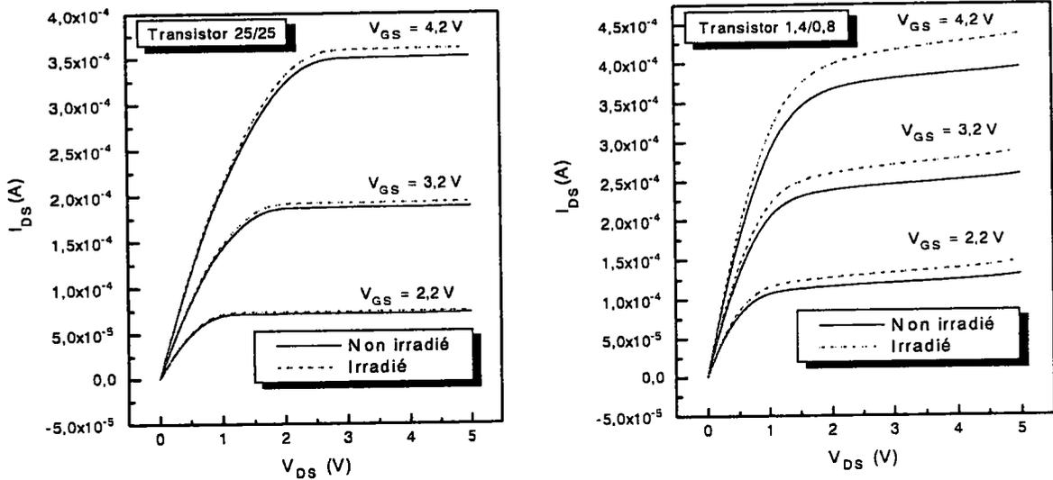
Figure III.16 : Evolution des caractéristiques de fonctionnement avec l'irradiation.
