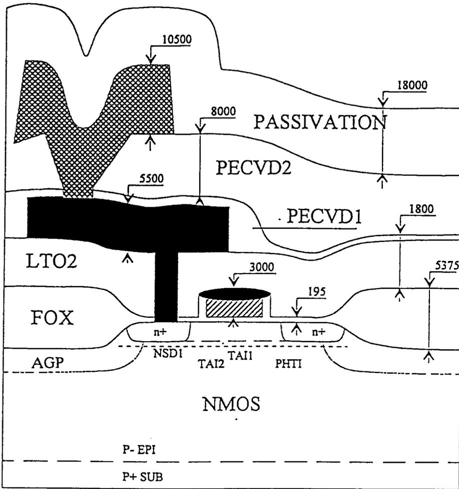
Figure IV.2: Vue en coupe de la structure d'un transistor à canal n en technologie SCMOS. Les dimensions sont données en Å et les principales étapes technologiques sont répertoriées.
