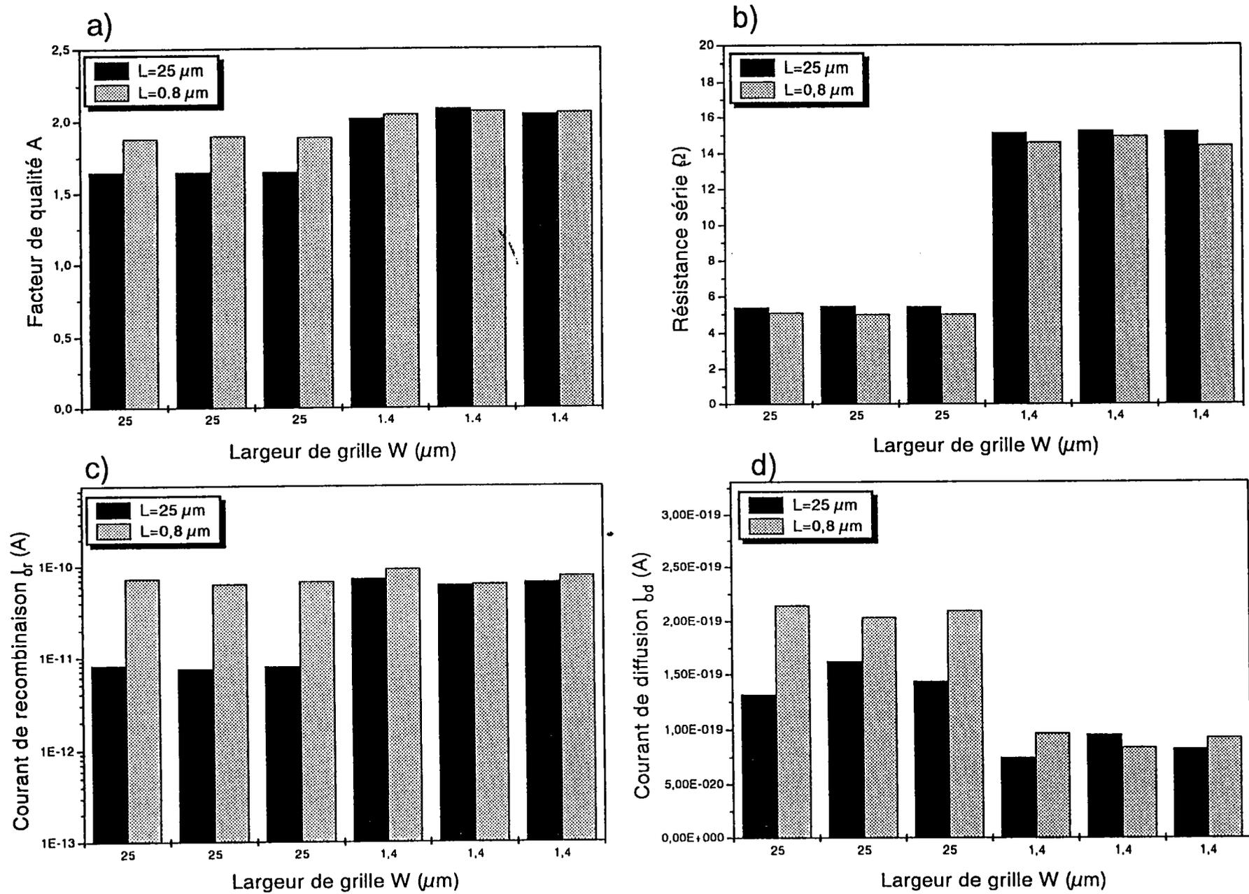
Figure III.8 : Paramètres de la jonction drain-substrat.
