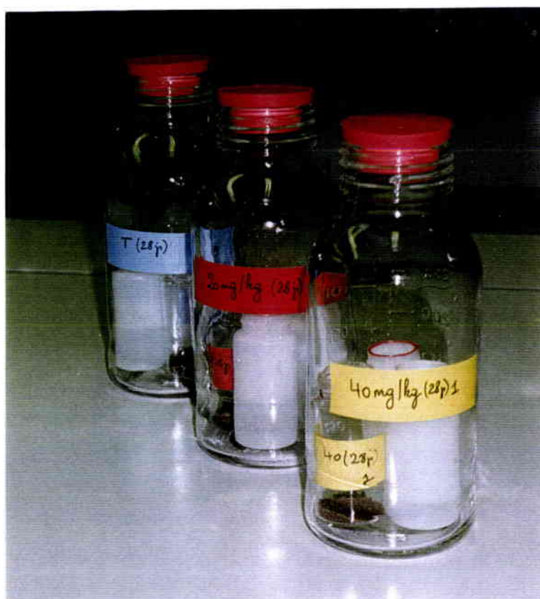
Figure III-4 : Dispositif expérimental d'incubation comprenant deux fioles à scintillation contenant dans l'une 5 ml de NaOH et dans l'autre 5 ml d'eau distillée ainsi qu'un flacon renfermant le sol.
