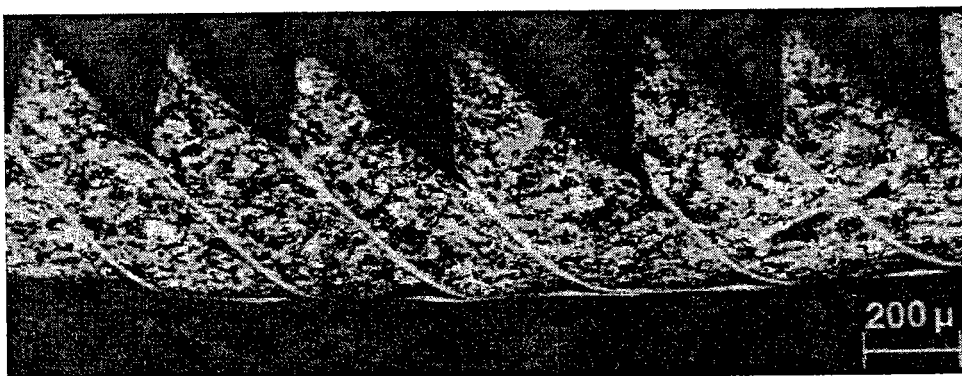
Figure 1.3 : Copeau de AISI 4340 d'après SEMIATIN S.L., LAHOTI G.D. & OH S.I. (1983)
