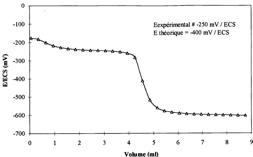
**Tableau 3.II.1 :** Détermination de la quantitativité des réactions de précipitation.
