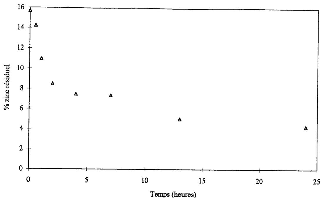
**Tableau 2.II.2 :** Données relatives à la lixiviation de 2 g de résidu non séché par la triéthylènetétramine protonnée à 1 M et pH 9. Température de 20 °C.
