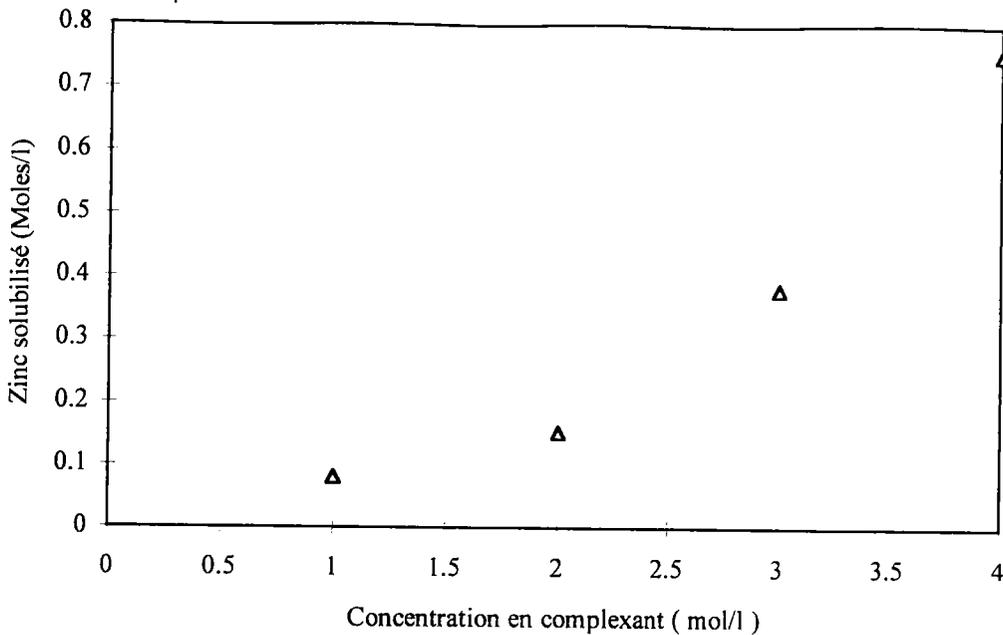
Si on confronte les valeurs obtenues pour les opérations de lixiviation par le thiosulfate de sodium, le chlorure d'ammonium et le thiosulfate d'ammonium représentées dans le tableau 2.I.3, on observe une nette augmentation de la solubilité de  $Zn(OH)_2$  pour le mélange  $(NH_4)_2S_2O_3$ . De manière à pouvoir comparer directement les résultats, les concentrations choisies sont de 4 M en ammonium et de 2 M en thiosulfate.
