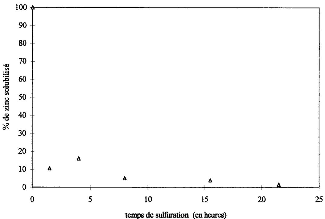
L'allure de cette courbe est similaire à celle obtenue pour l'étude du composé de référence  $\text{Zn}(\text{OH})_2$  vieilli. On observe une diminution importante de la solubilité du composé dans l'acétate d'ammonium pour la première heure de sulfuration puis une évolution plus lente qui conduit après 22 heures à un taux de zinc solubilisé de 1 %. Le résidu est considéré à ce stade comme un déchet inerte.
