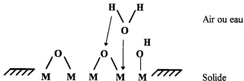
Les groupes hydroxylés sont naturellement présents à la surface lorsque les particules d'(hydr)oxydes sont précipités en solution. En effet, ceux-ci proviennent de la sphère de coordination des derniers cations incorporés sous forme de complexe de charge nulle.
