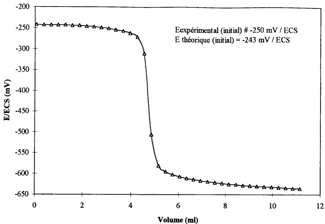
**Figure 3.II.3 :** Suivi du potentiel pris par une électrode d'argent plongeant dans 50 ml d'une solution de  $\text{FeSO}_4$  à  $5 \cdot 10^{-2}$  M au cours de l'ajout de polysulfures à 0,55 M.
