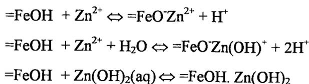
Les cations métalliques une fois fixés sur la surface peuvent dans certains cas diffuser à l'intérieur des pores de l'oxyde avant d'atteindre un équilibre thermodynamique. Ce phénomène peut donner lieu à un 'piégeage' du zinc dans les pores de l'hydroxyde ferrique perturbant fortement la mobilité de ce cation.
