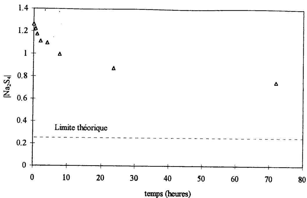
Le trait en pointillé correspond à la limite théorique de la concentration en polysulfures, au terme de la réaction  $\text{ZnO} + \text{S}_4^{2-} + \text{H}_2\text{O} \rightarrow \text{ZnS} + 3 \text{S}^\circ + 2\text{OH}^-$  si celle-ci était quantitative.
