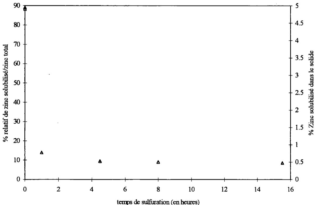
Les résultats de la figure 1.III.5 indiquent un pourcentage de zinc solubilisé par l'acétate d'ammonium à 30 % moins important lors de l'inertage à 70 °C que dans le cas l'inertage à 20 °C. Après 16 heures de traitement à chaud, 10 % de zinc est extrait de la matrice par le réactif lixiviant contre 28 % à froid.
