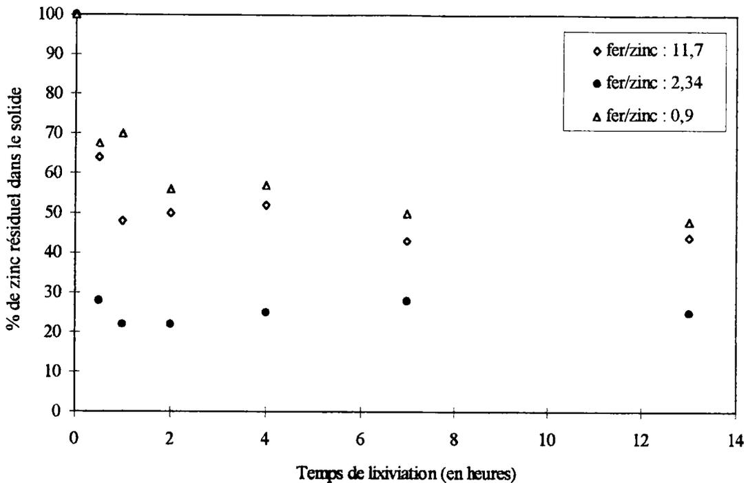
Dans les 3 cas, nous observons une diminution significative du zinc présent dans le solide pour 2 heures de mise en contact. Le taux de zinc n'évolue par la suite que très lentement pour se stabiliser après 7 heures de traitement.
