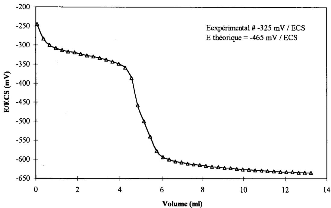
**Figure 3.II.4 :** Suivi du potentiel pris par une électrode d'argent plongeant dans 50 ml d'une solution de  $\text{NiCl}_2$  à  $5 \cdot 10^{-2}$  M au cours de l'ajout de polysulfures à 0,55 M.
