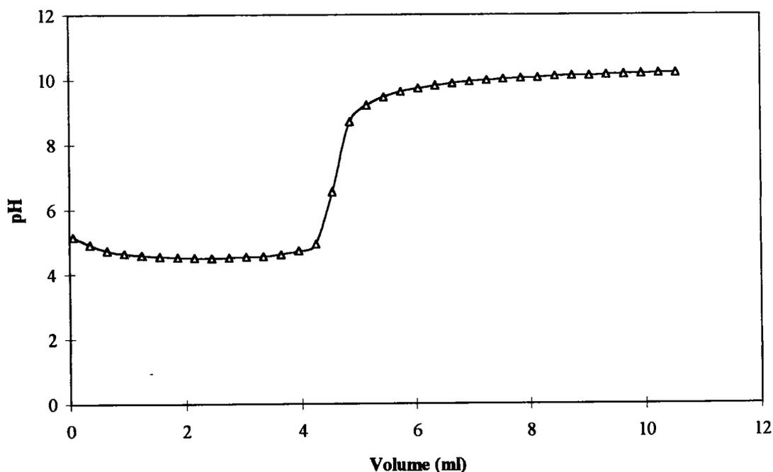
L'allure de la courbe de suivi pHmétrique est conforme à celle du suivi potentiométrique. On observe une bonne corrélation entre les volumes d'ajouts des polysulfures correspondant au saut de pH et de potentiel.
