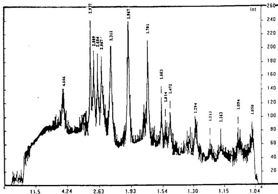
Ce travail confirme la sulfuration de l'hydroxyde de nickel par la solution de polysulfure et fait apparaître la mise en place de 2 réactions de sulfuration conduisant à la formation des composés NiS et NiS<sub>2</sub>.
