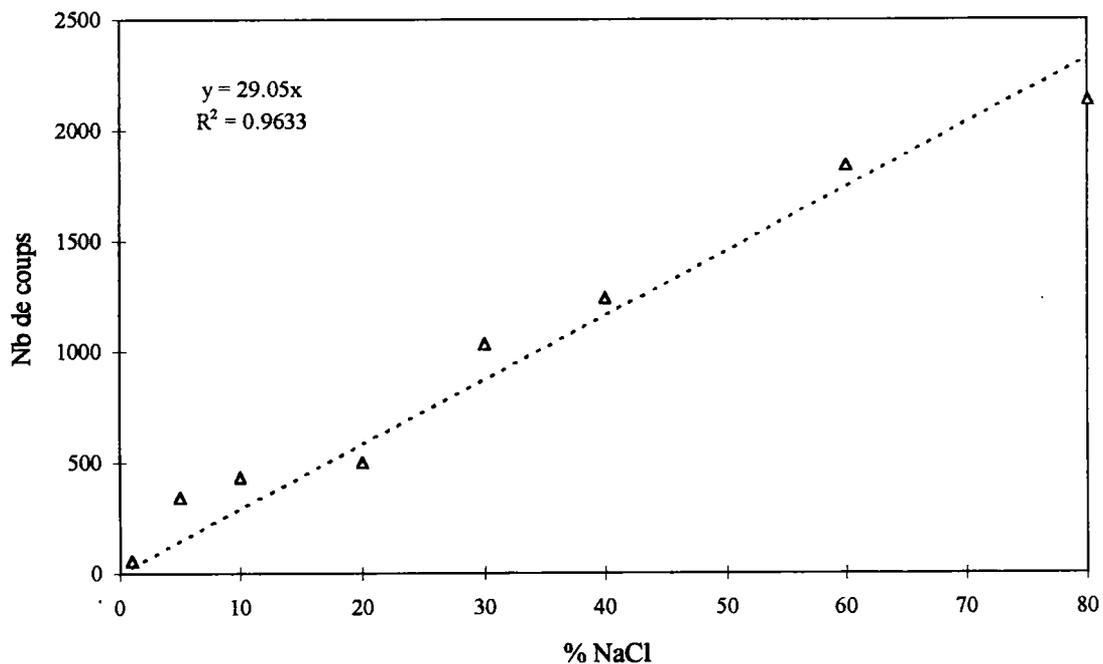
On constate que le nombre de coups mesurés pour la raie principale de NaCl est bien proportionnel au pourcentage massique de NaCl dans l'échantillon. Une régression linéaire effectuée à partir des points expérimentaux conduit à l'obtention d'une droite possédant un coefficient de corrélation de 0,963. L'équation de cette droite s'exprime par :
