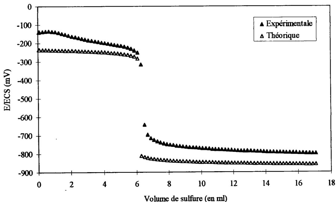
L'évolution théorique du suivi potentiométrique sur électrode d'argent de la réaction de sulfuration est en bon accord avec l'expérimentation. Les valeurs des potentiels expérimentaux sont toutefois supérieures d'environ 70 mV à celles calculées. L'approximation qui consiste à considérer l'activité égale à la concentration pour le tracé théorique du potentiel n'est plus valable dans ce cas compte tenu de la force ionique de la solution étudiée.
