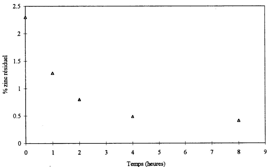
**Tableau 2.III.4 :** Données relatives à la lixiviation sélective de 2 g du gâteau d'hydroxydes métalliques par 20 ml de  $H_2$ trien<sup>2+</sup> 1 M à la température de 50 °C.
