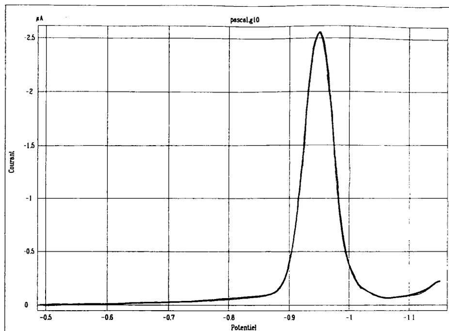
La technique utilisée pour relier l'intensité des signaux de réduction à la concentration de l'espèce réduite est basée sur la méthode des ajouts dosés. Cette méthode consiste à tracer le polarogramme de la solution à doser, puis à pratiquer un ajout d'une solution étalon pour comparer les hauteurs de pic obtenus. Les mesures ont été réalisées sur 10 ml de la solution acidifiée à 0,1 M en HCl.
