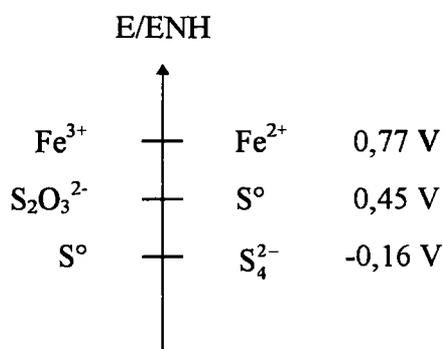
On voit que la réduction du  $Fe^{3+}$  par  $S_4^{2-}$  est thermodynamiquement possible compte tenu de l'écart important entre les potentiels normaux. Nous avons signalé pour l'étude du  $Cr^{VI}$  l'intervention du couple  $S_2O_3^{2-}/S^{\circ}$ . Ce phénomène n'a pas lieu dans le cas de la réduction du  $Fe^{3+}$  en  $Fe^{2+}$ .
