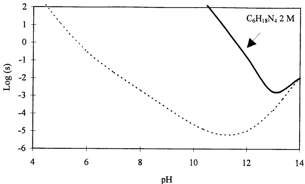
On observe une augmentation significative de la solubilité de  $\text{Zn}(\text{OH})_2$  en présence du ligand sur un large domaine de pH. Cette courbe théorique montre que pour des pH de l'ordre de 9, le zinc n'existe pas sous forme d'hydroxyde dans une solution à  $2\text{ M}$  en triéthylènetétramine.
