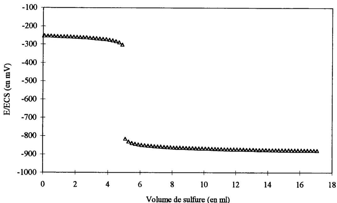
L'allure du faisceau obtenu pour le suivi de la réaction de sulfuration d'une solution de zinc(II) est parfaitement défini par le calcul théorique. Nous étendons maintenant notre étude à des solutions plus complexes mettant en présence plusieurs cations métalliques. Ce travail doit nous permettre de prévoir l'évolution du potentiel pris par une électrode d'argent métal lorsque des réactions de précipitation se mettent successivement en place.
