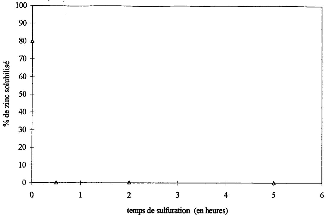
Nous observons en premier lieu que la totalité du zinc présent dans la boue avant sulfuration n'est pas mobilisable par  $CH_3COONH_4$  à 30 %. En effet, 20 % de celui-ci reste prisonnier de la matrice ferreuse. Ce résultat rappelle les observations décrites pour le traitement des gâteaux issus de la filtration et de la mise en lagune de boues de même composition.
