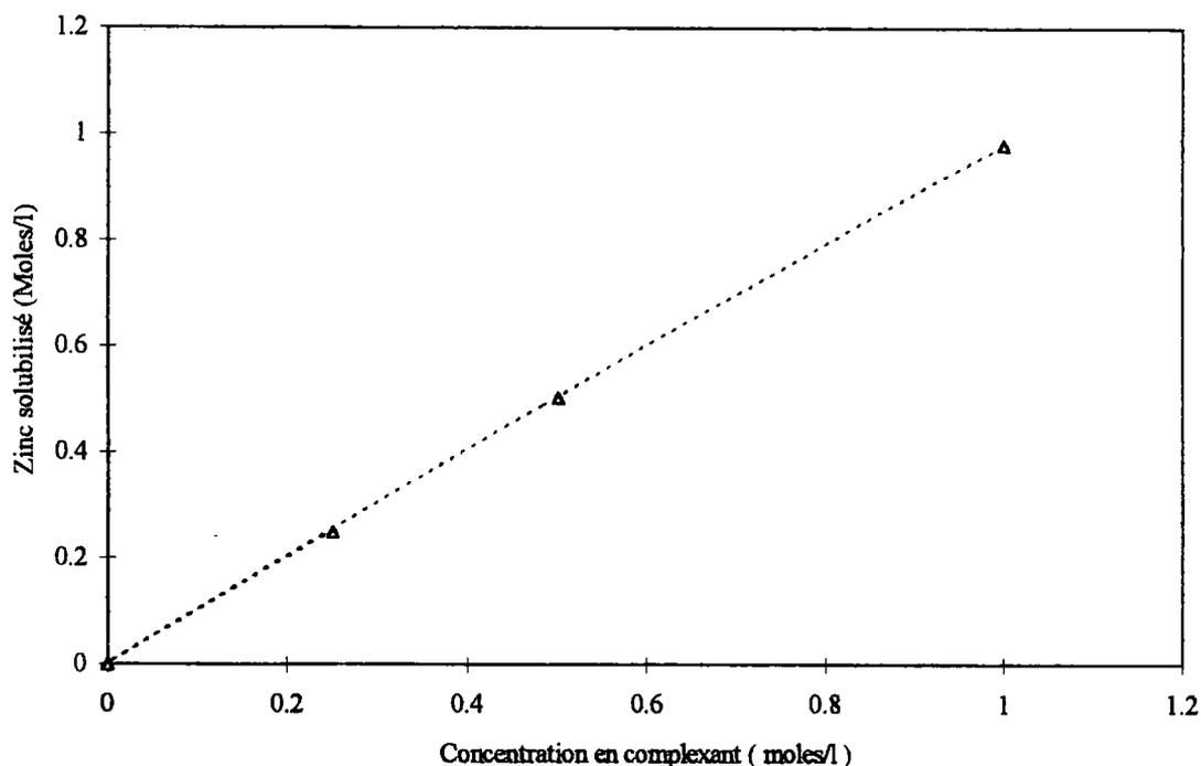
La solution de triéthylènetétramine protonnée permet la dissolution de quantités très importantes d'hydroxyde de zinc.
