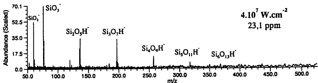
Spectres de masse FTMS de la silice St1 obtenus en ions négatifs à 266 nm en faisant varier l'irradiance de 2.10 10 W.cm -2 à 4.10 7 W.cm -2 en appliquant un délai de 100 µs entre l'ionisation et l'excitation
