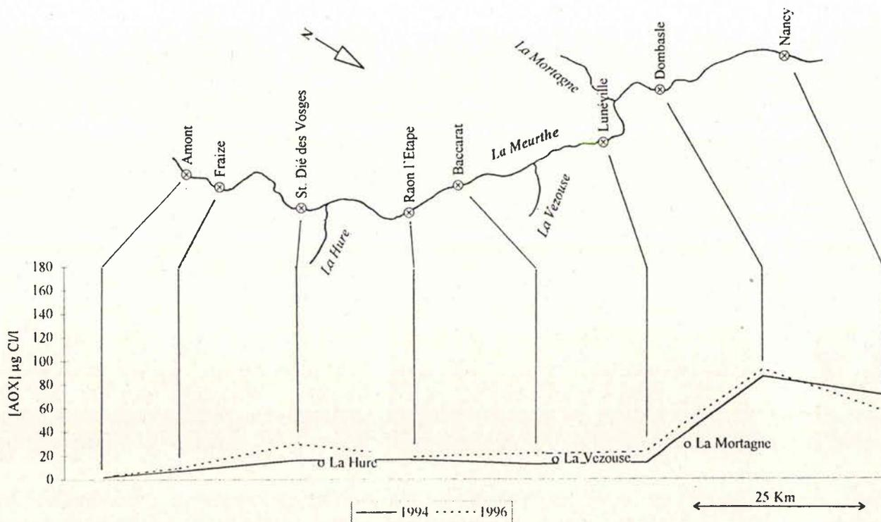
Figure 3.3 : Profils longitudinaux des concentrations en AOX dans l'eau de la Meurthe en 1994 et 1996.
