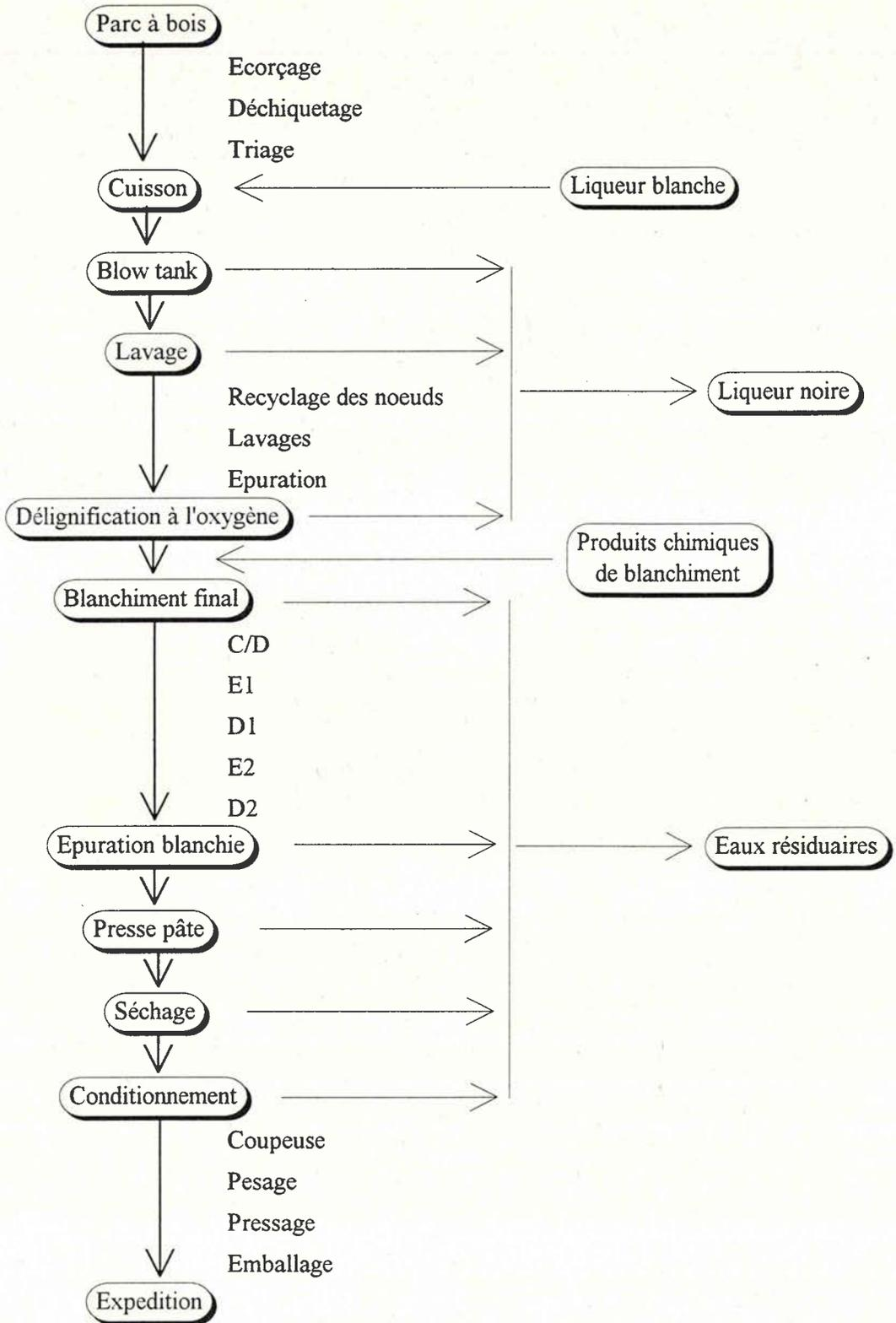
Figure 1.5 : Chaîne de fabrication de pâte et de papier selon le procédé Kraft (au sulfate).
