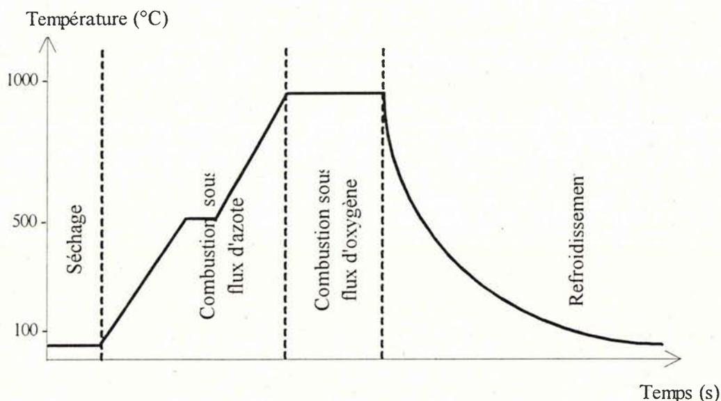
Figure 2.2 : Programmation en température du four de combustion.
