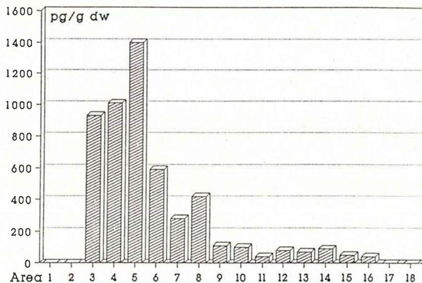
Figure 1.19 : Concentrations en TCDD (TétraChloroDibenzo-p-Dioxines) dans les sédiments à proximité d'EPKB. Area 1,2 : amont rejets ; Area 3-18 : aval rejets (Koistinen *et al.* 1990).
