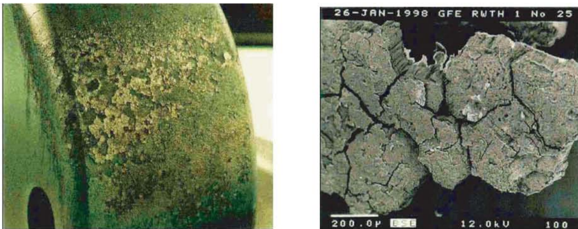
Figure I-6 : Dépôt à la surface de limiteur de TEXTOR-94 [3]
