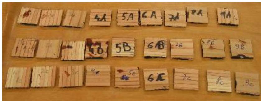
Figure 33: Substrats pressés pour la détermination de l'influence du temps ouvert par ATM
