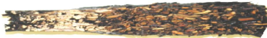
Figure 43: Panneau après 10 min d'immersion dans l'eau
