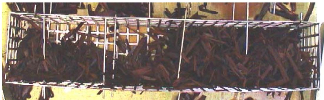
Figure 45: Panneaux (tanin de quebracho) pressés avec injection de vapeur après immersion de 30 min dans l'eau bouillante
