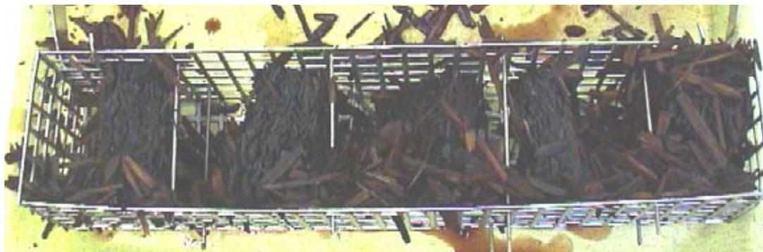
Figure 44: Panneaux (tanin de pin) pressés avec injection de vapeur après immersion de 30 min dans l'eau bouillante
