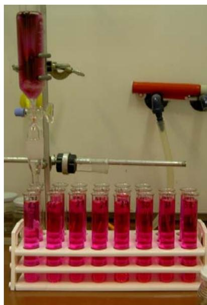
Figure 27: Collection des bonnes fractions du chlorure de méthylène de la solution de marquage pour la chromatographie sur couche mince
