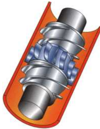
FIG. 1: Coupe de la partie fonctionnelle de la pompe de fond de puits avec vue partielle du carter. Sur cette coupe, un stator (en bleu) est précédé d'un rotor et est suivi d'un autre rotor. L'arbre de rotation est visible et les moyeux sont partiellement cachés par les aubages.
