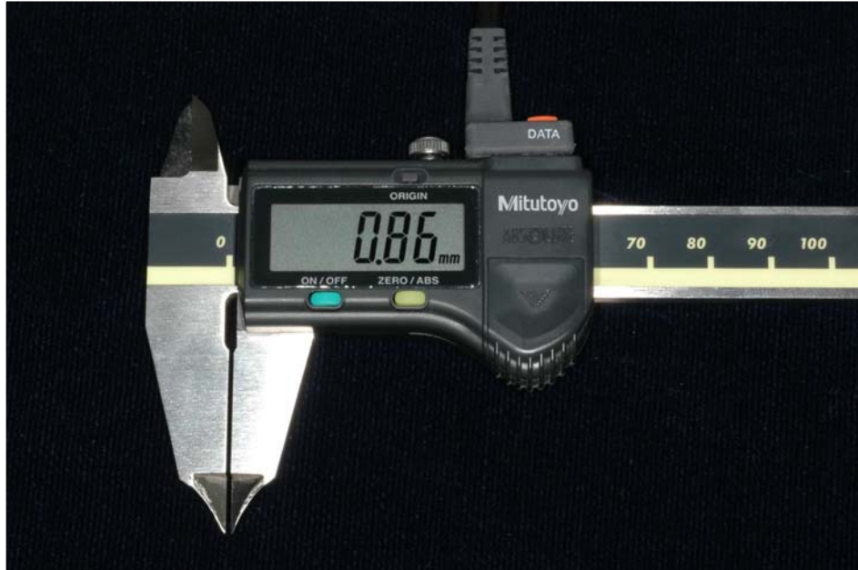
Figure 2 : pied à coulisse Mitutoyo® (modèle 500-161-20)
