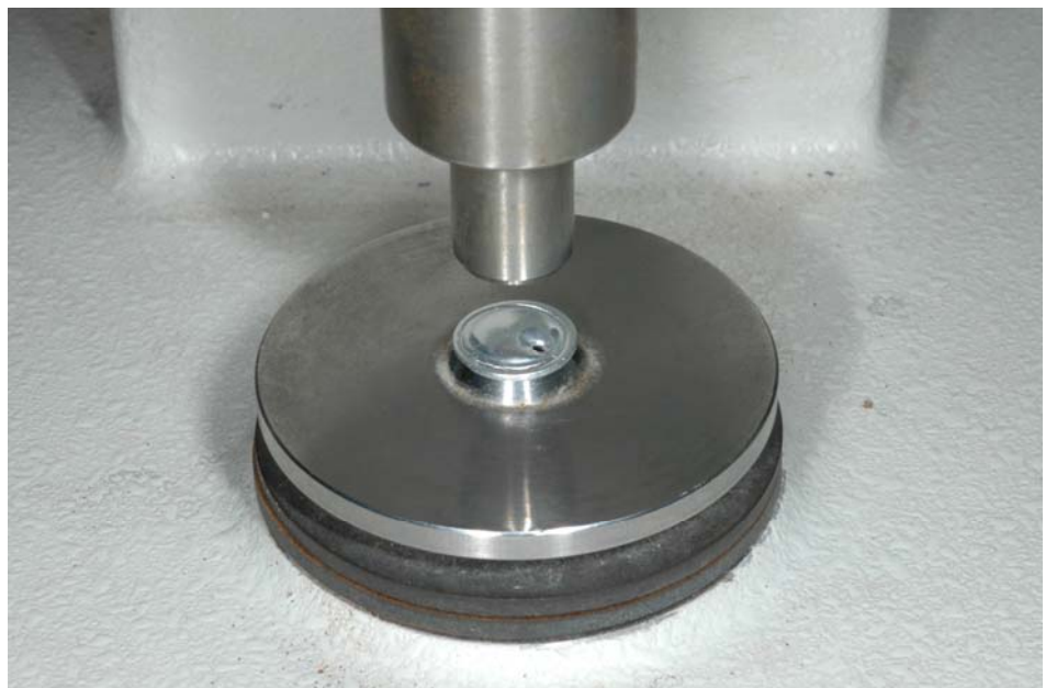
Figure 11 : sertissage d'un creuset
