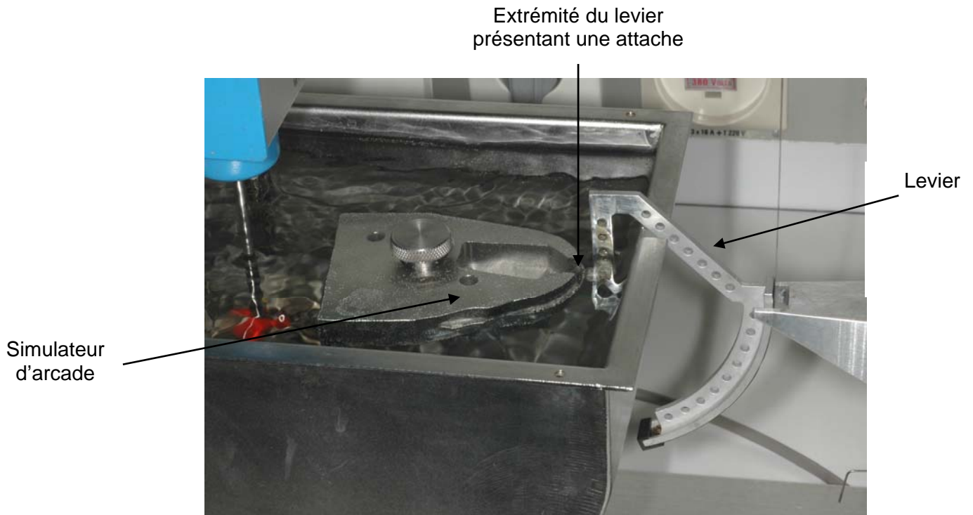
Figure 21 : simulateur d'arcade et levier
