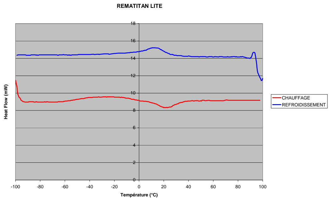
Figure 24 : Courbes de DSC au chauffage et refroidissement du fil Rematitan Lite
