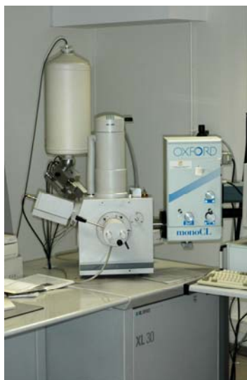
Figure 8 : microscope électronique à balayage Philips XL 30
