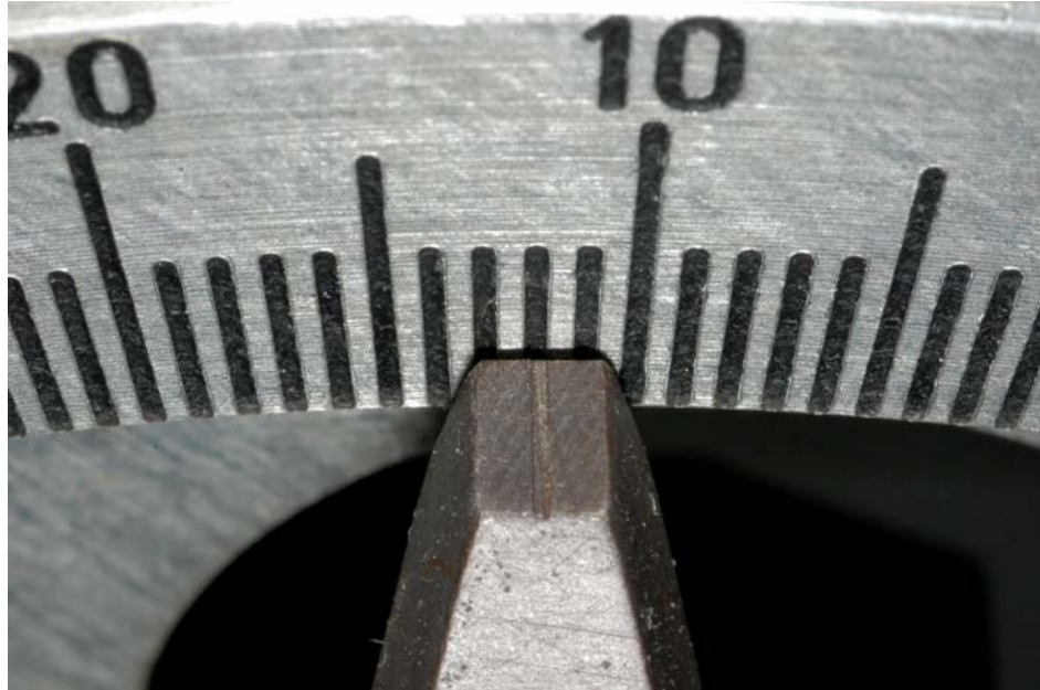
Figure 25 : graduation de la poulie
