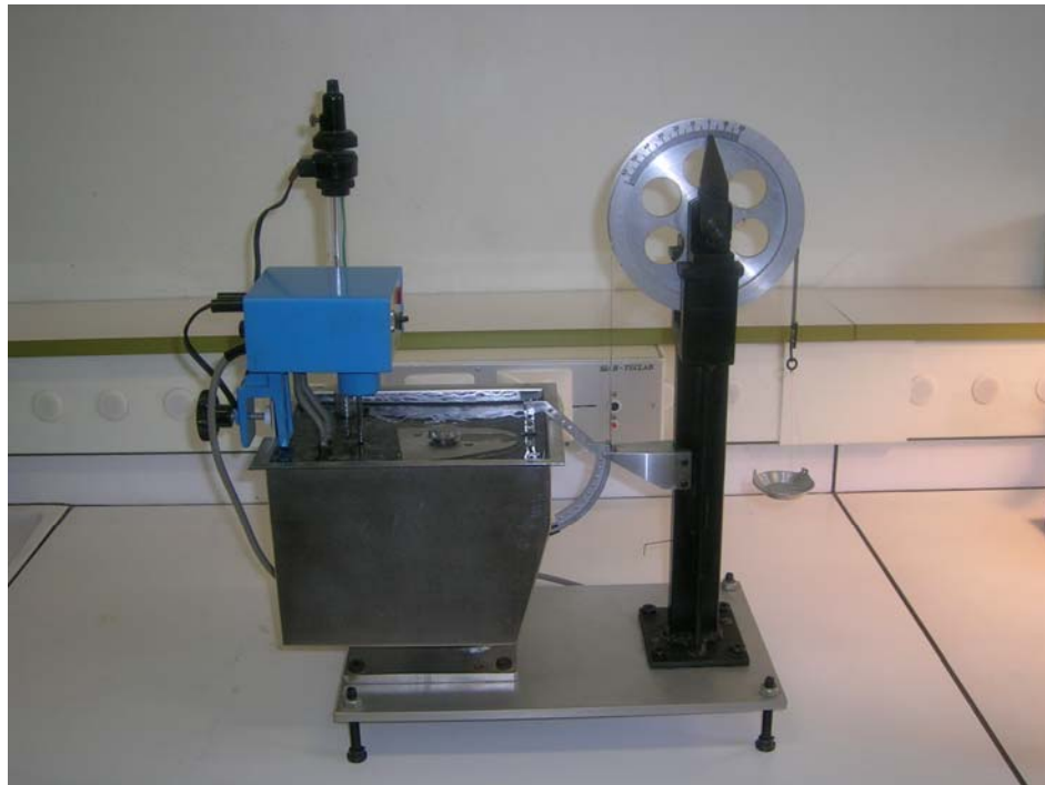
Figure 17 : banc d'essai en torsion
