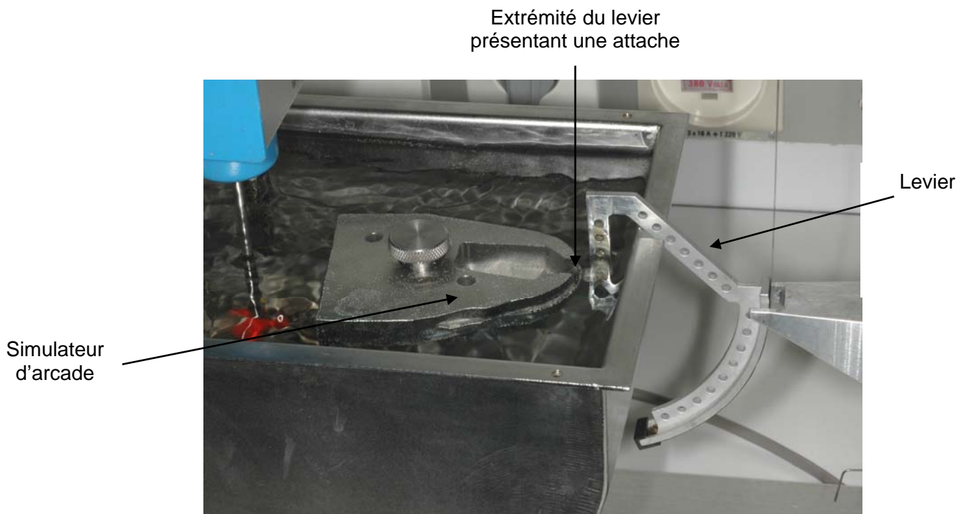
Figure 21 : simulateur d'arcade et levier
