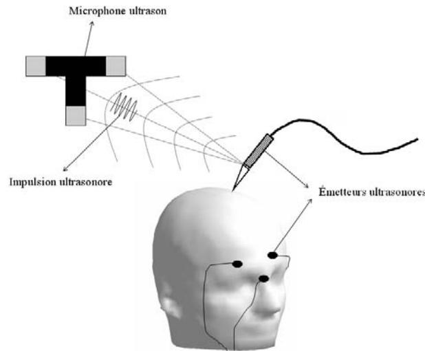
Figure 10 : Dispositif de numérisation ultrasonore (Elpos, Zebris).
