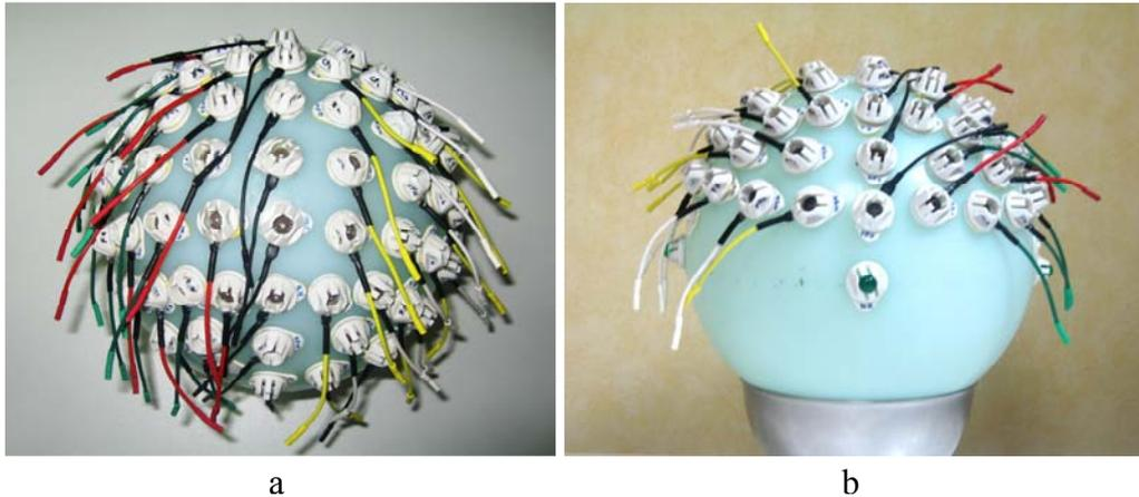
Figure 43 : Vue de dessus (a) et de face (b) du fantôme de tête IRM avec les 64 prototypes de capteurs EEG-IRM. Sur ces images, les marqueurs IRM n'ont pas encore été positionnés au niveau des prototypes.
