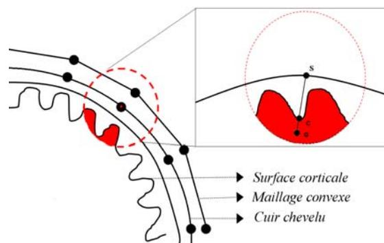
Figure 48 : Illustration de la méthode de recherche de la structure anatomique sous-jacente à un capteur de surface. Une sphère de rayon  $R$  est centrée autour du point représentant le capteur de surface (noté S). Le centre de gravité (noté G) de la zone de recouvrement (en rouge) entre cette sphère et le maillage de cerveau est alors sélectionné. L'intersection de la droite reliant S et G avec la surface corticale représente le point anatomique cérébral (noté C).
