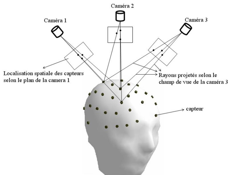
Figure 12 : Méthode de repérage spatial des capteurs EEG grâce à la photogrammétrie.
