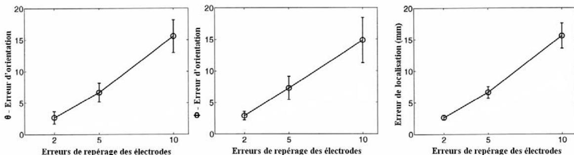
Figure 16 : Erreurs de localisation et d'orientation dipolaire dues à des erreurs de repérage des capteurs respectivement de gauche à droite de  $2^\circ$ ,  $5^\circ$  et  $10^\circ$ .
