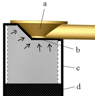
Figure 13 : Marqueur IRM et électrode EEG de surface.
