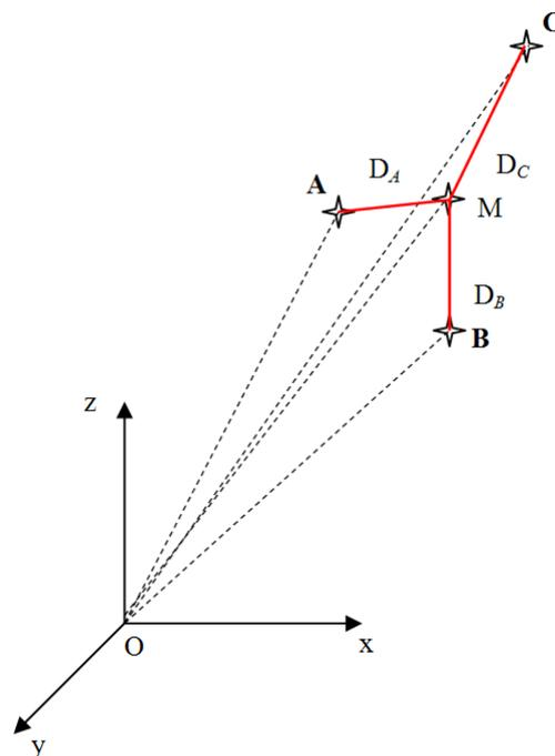
Figure 44 : Illustration de la méthode de calcul de la reproductibilité avec trois capteurs  $A, B$  et  $C$ . La reproductibilité représente la dispersion autour d'un point moyen  $M$  c'est-à-dire la moyenne des distances euclidiennes  $D_A, D_B$  et  $D_C$ .
