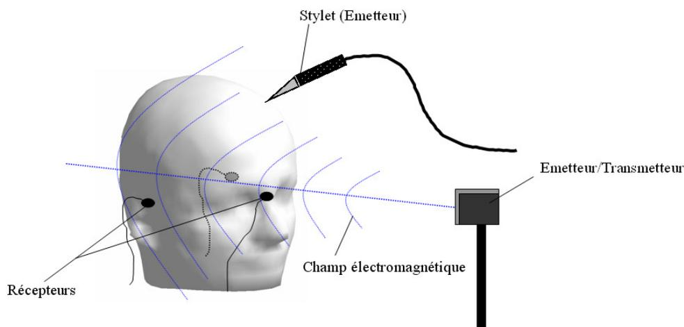
Figure 9 : Dispositif de numérisation électromagnétique (Polhemus, Fastrack).
