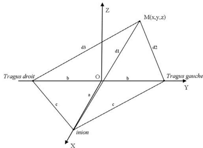
Figure 6 : Méthode manuelle de repérage spatial d'un capteur de surface.
