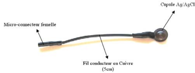
Figure 22 : Photographie d'une électrode cupule Capsulex utilisée pour la conception du prototype. Cette électrode est constituée d'un disque en Ag/AgCl de 10 mm de diamètre percé en son centre pour permettre l'introduction d'un gel de conduction. L'électrode est reliée par soudure à un câble électrique en Cuivre de 5 cm qui se termine par un micro-connecteur femelle.
