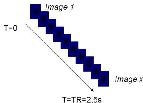
Figure 39 : Schéma présentant le déroulement temporel d'une acquisition d'images fonctionnelles. On peut noter à l'aide de cette figure que la première et la dernière image sont décalées dans le temps d'une valeur de TR.
