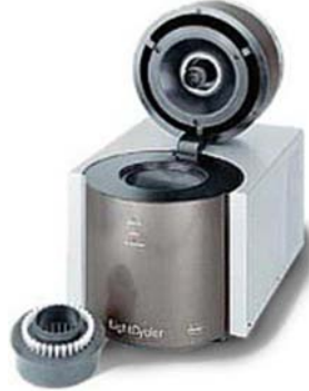
Figure 37 : Thermocycleur Lightcycler ™ à capillaires (Roche Molecular Diagnostics) permettant le suivi en temps réel de l'amplification des ADNc.
